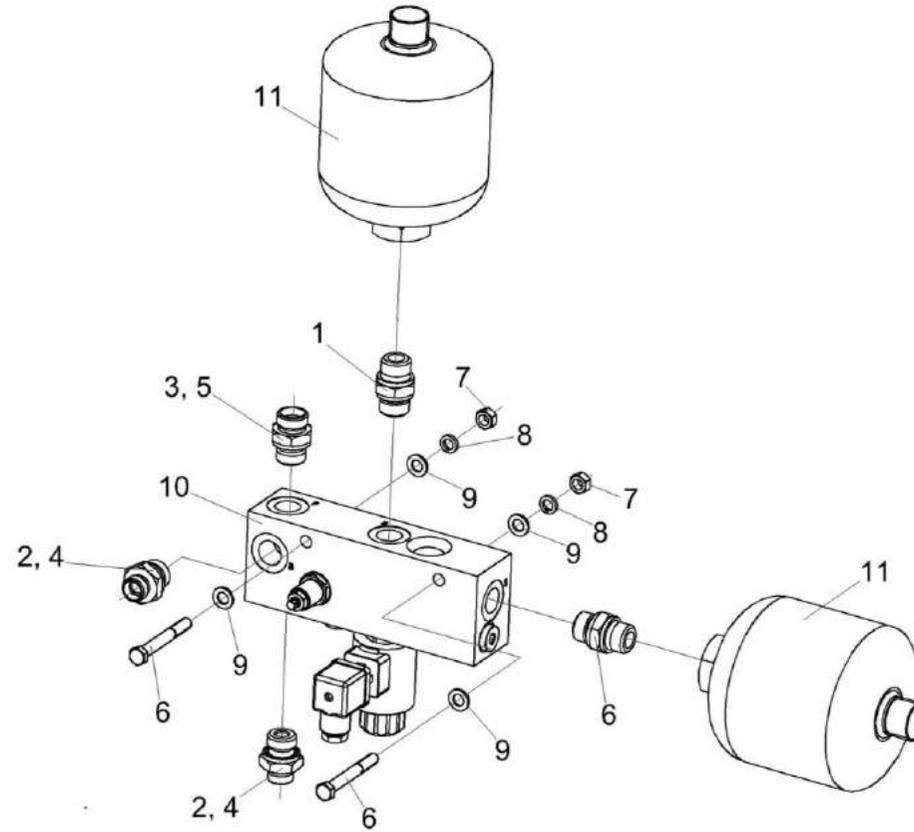
Рисунок 261 – Гидроблок демпфирования КЗК-16-1-0602300
