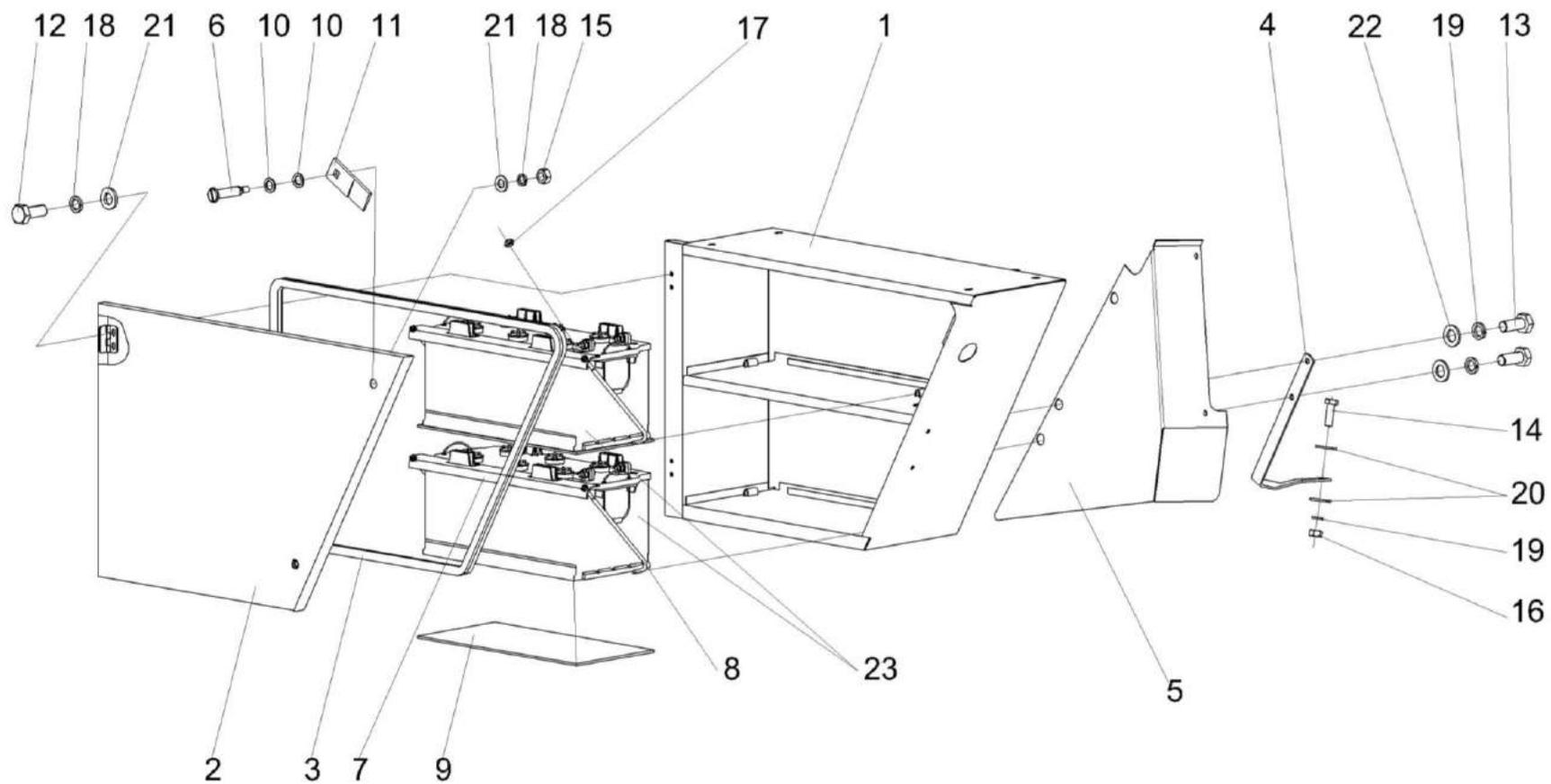
Рисунок 245 – Установка ящика аккумуляторного КЗК-14-0129000
