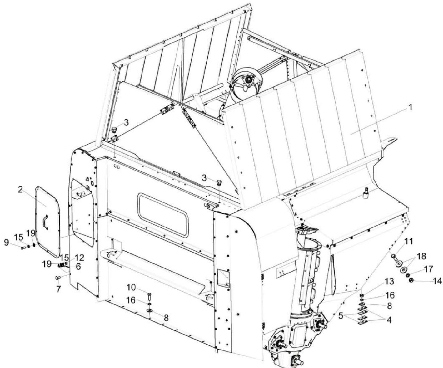
Рисунок 141 – Установка бункера КЗК-16-1-0203000
