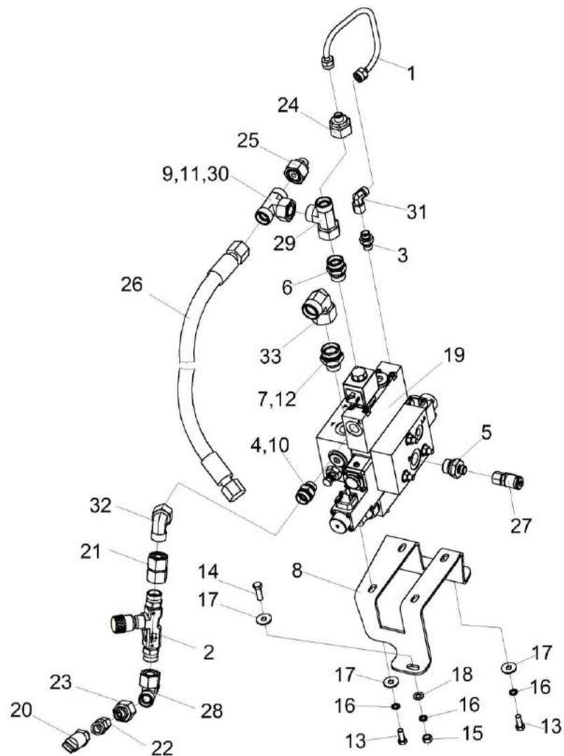
Рисунок 262 – Гидроблок навески КЗК-16-1-0602360
