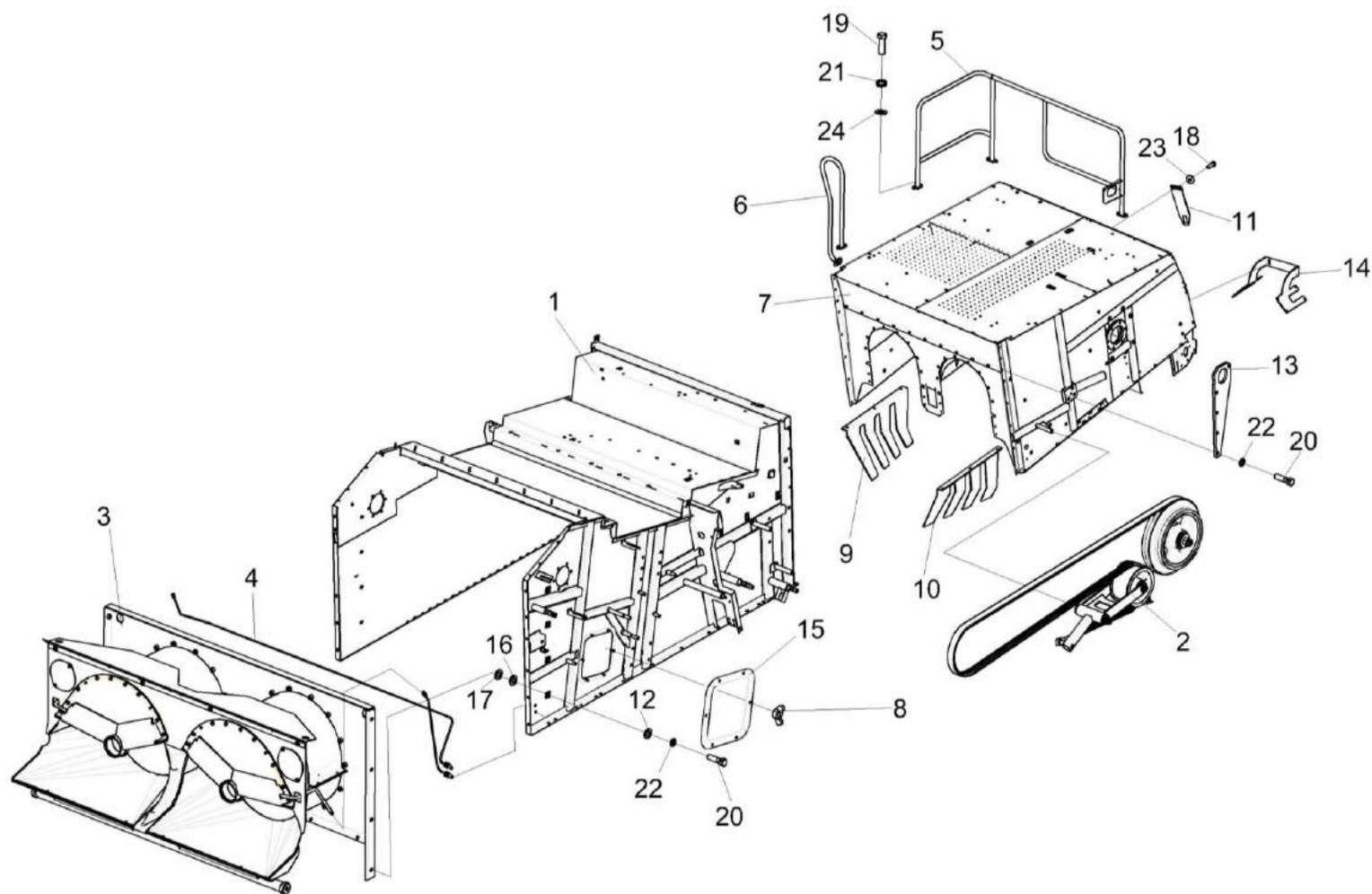
Рисунок 53 – Соломосепаратор роторный КЗК-16-6-0212010 (лист 1)
