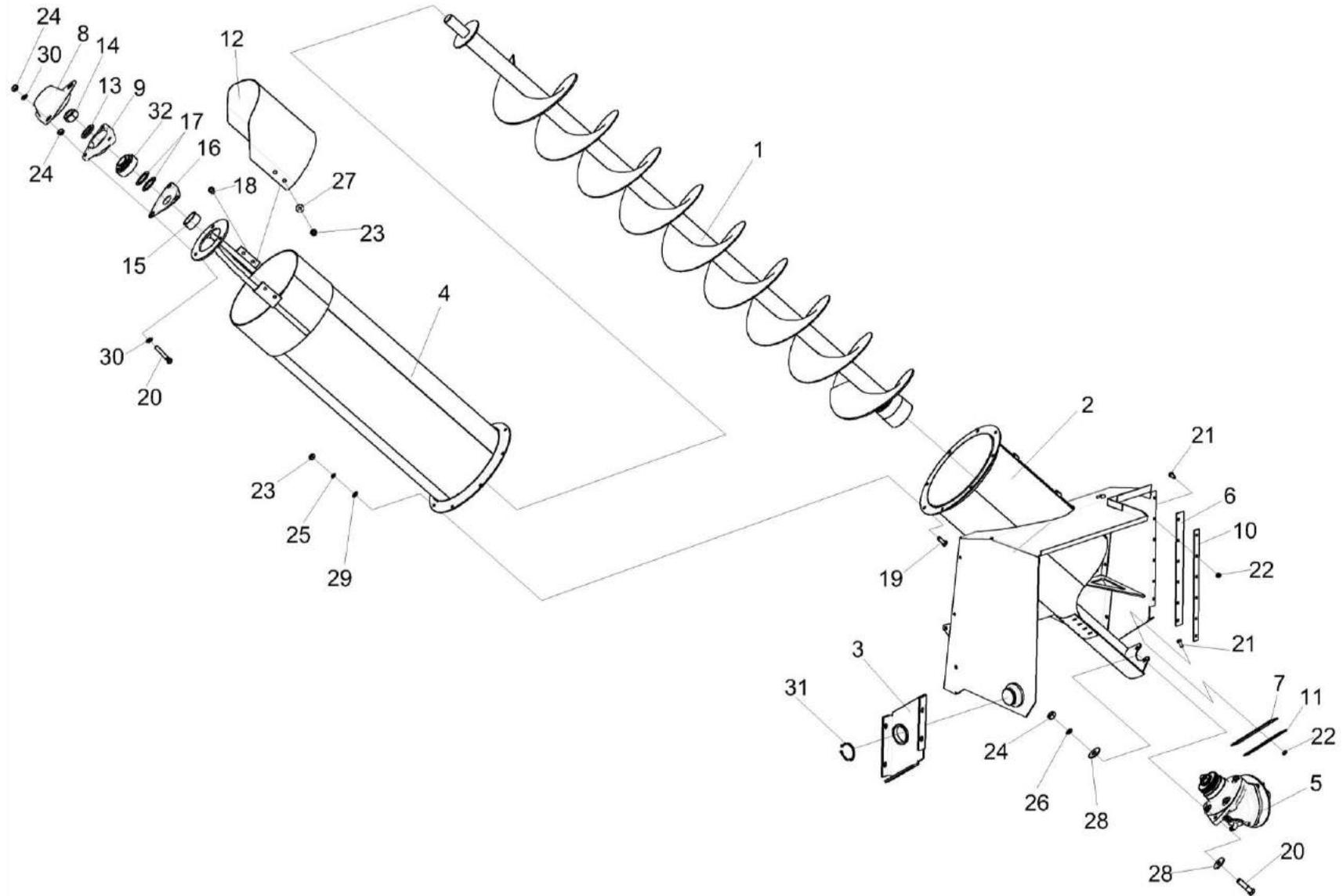
Рисунок 148 – Шнек загрузки КЗК-14-0216000А
