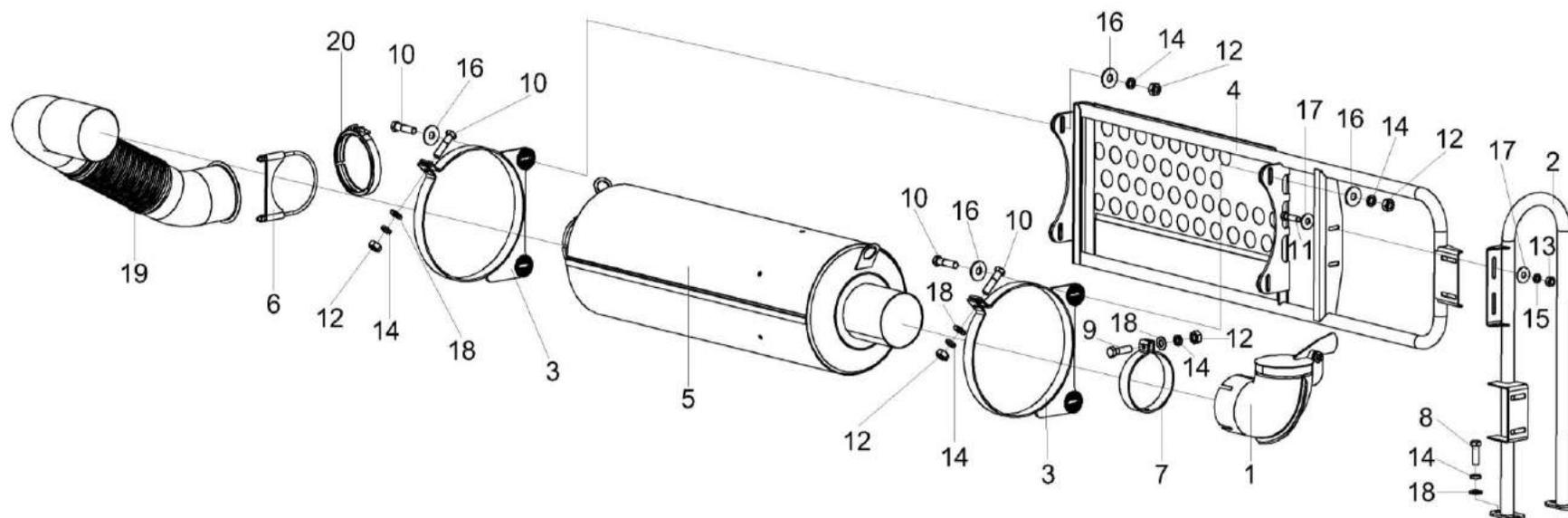
Рисунок 134 – Установка глушителя КЗК-16-6-0106060
