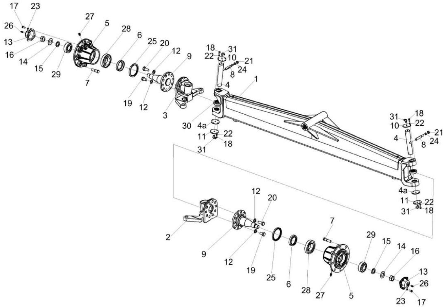
Рисунок 109 – Мост управляемых колес КЗК-1420-0109000 (лист 1)
