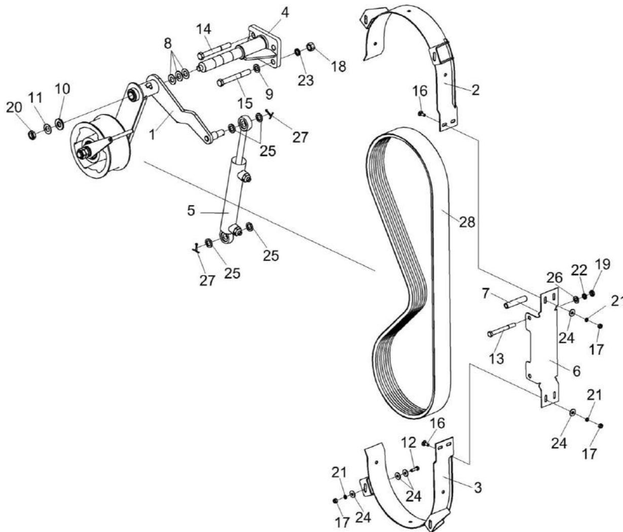
Рисунок 185 – Установка первой ступени привода соломоизмельчителя КЗК-16-1-0290900А
