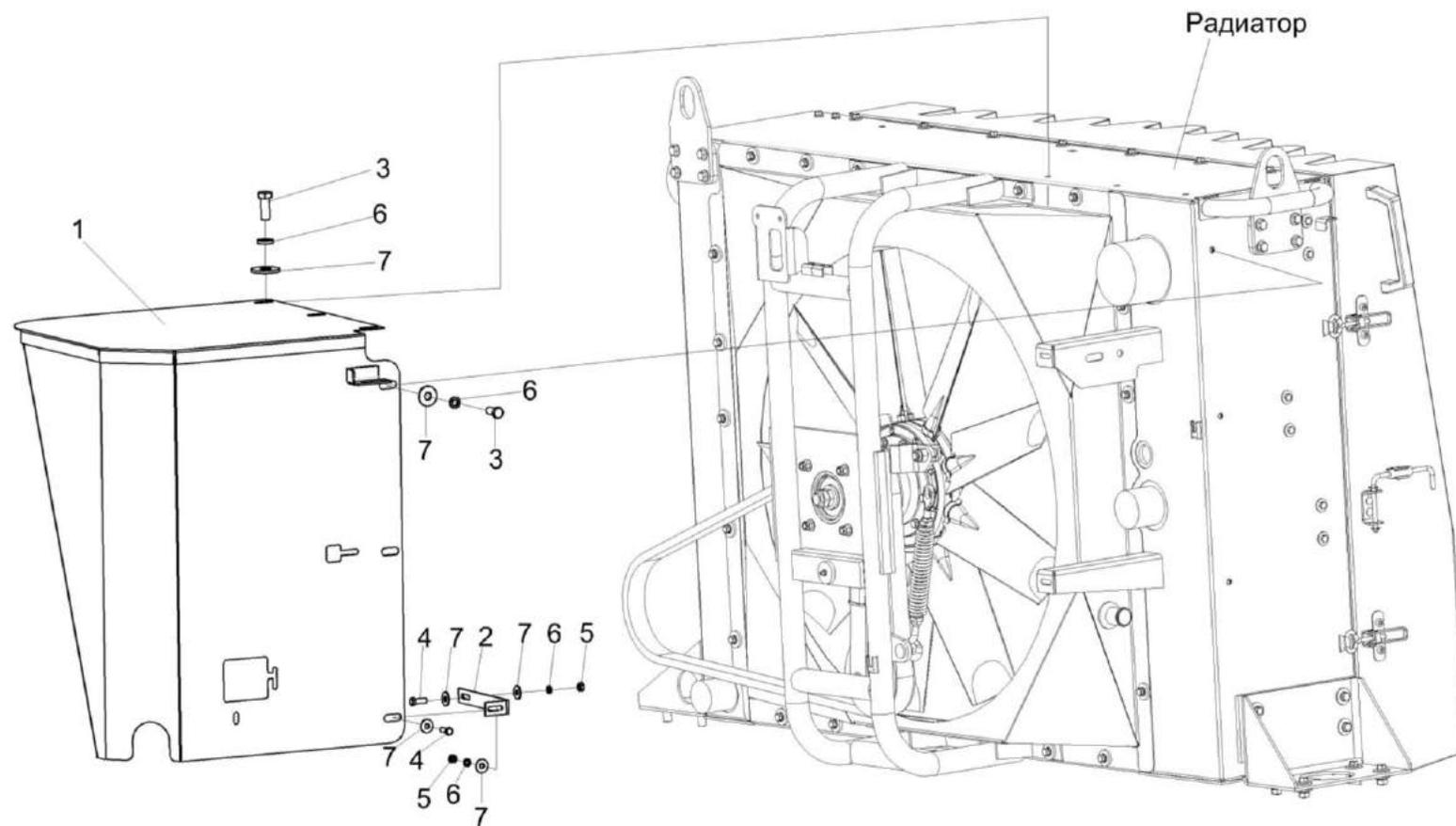
Рисунок 137 – Установка ограждений КЗК-16-6-0106430
