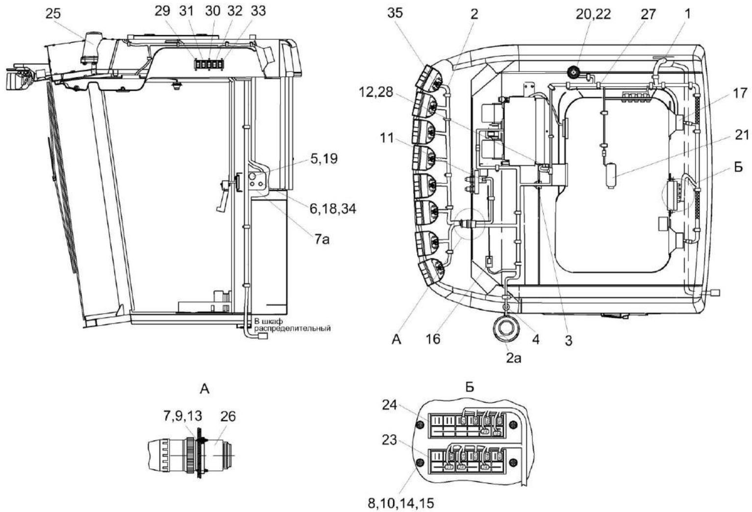
Рисунок 213 – Установка электрооборудования кабины КЗК-1420-0722000
