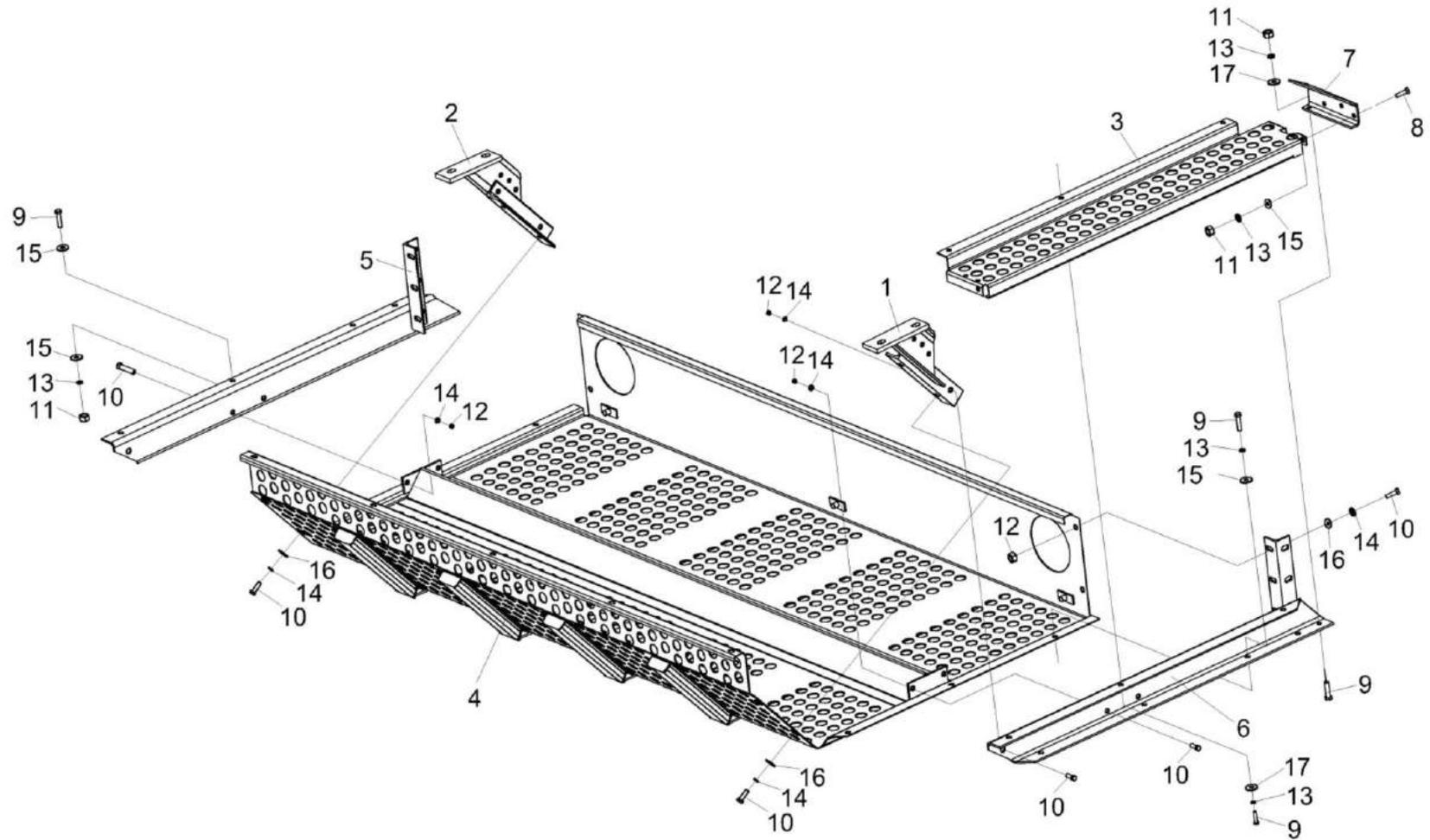
Рисунок 115 – Защита вентилятора КЗК-16-1-0217900
