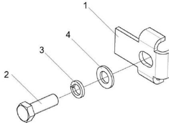
Рисунок 223 – Установка прижима КЗК-8-3-0113100
