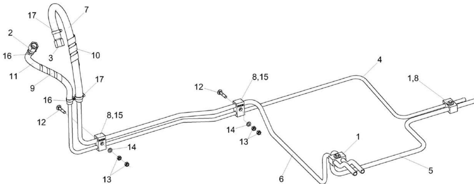
Рисунок 121 – Установка топливопроводов КЗК-16-6-0126100
