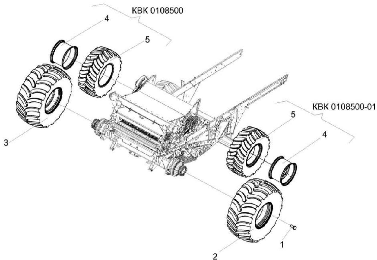
Рисунок 116 – Установка колес КЗК-1420-0100040
