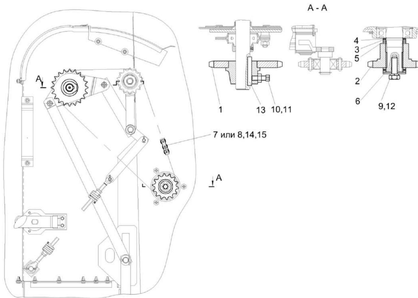
Рисунок 34 – Установка цепной передачи КЗК-2124-0214500
