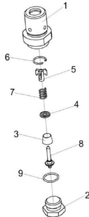
Рисунок 295 – Клапан сливной КВС-1-0103180
