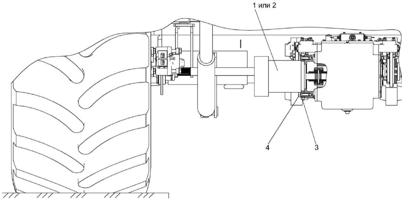
Рисунок 256 – Установка гидромотора КЗК-1420-0100070 и КЗК-1420-0100070-01
