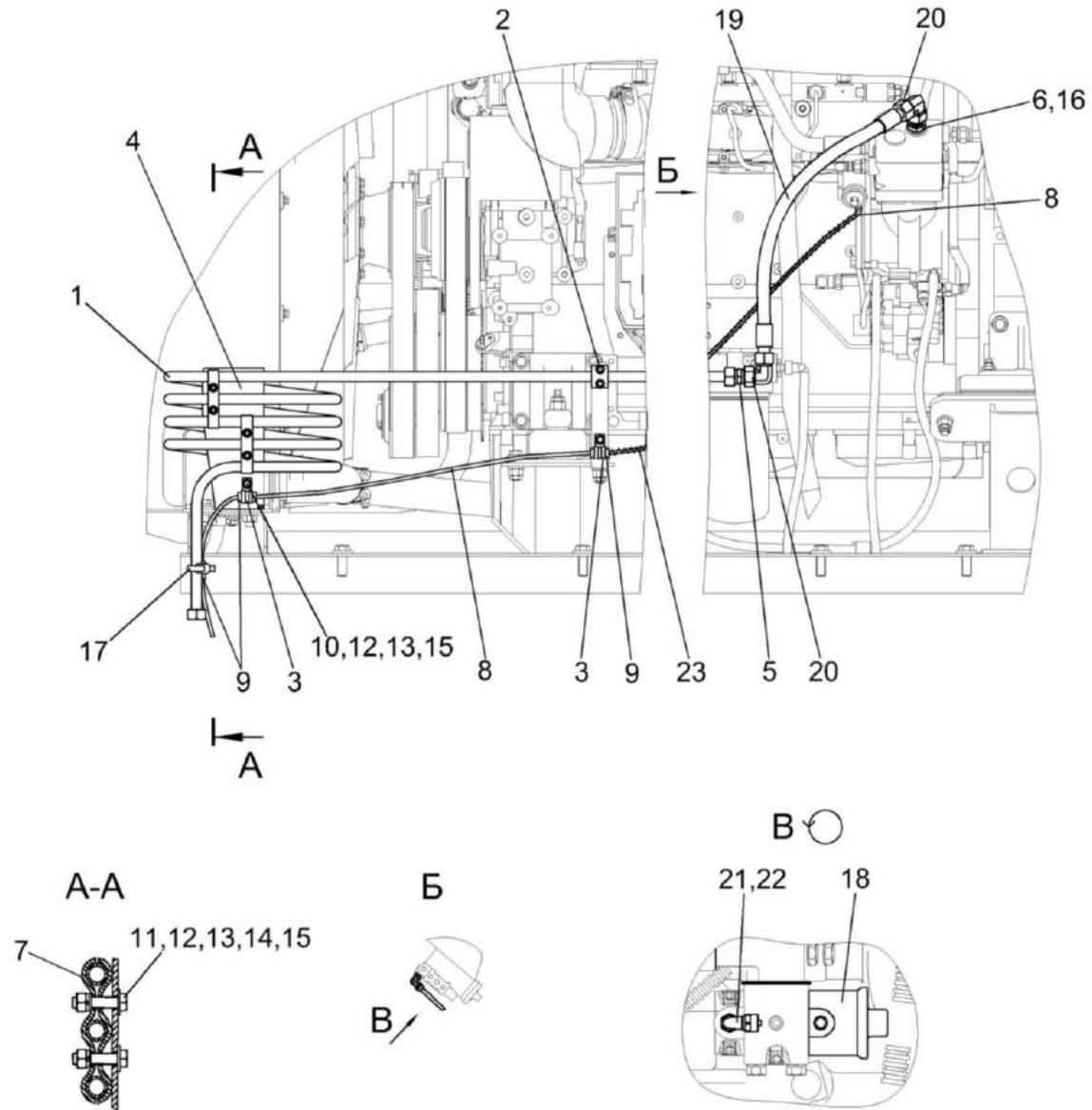
Рисунок 139 – Установка элементов пневмосистемы КЗК-16-6-0800010
