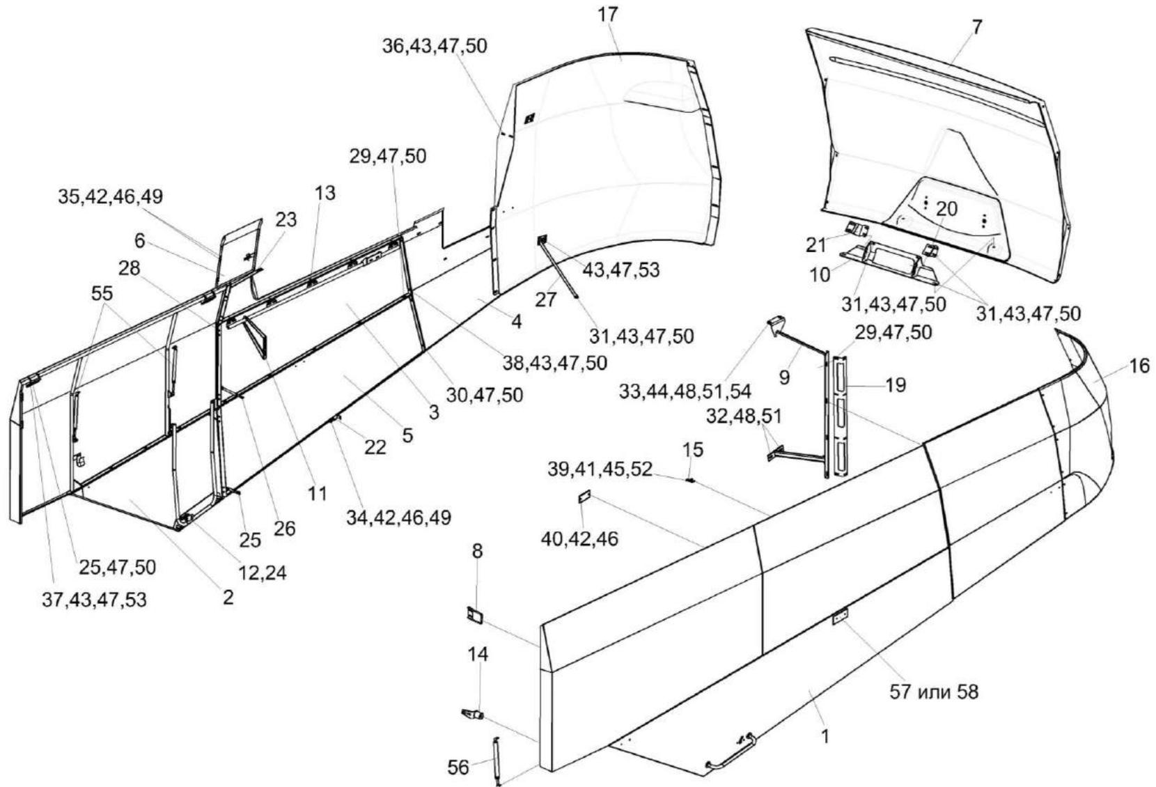
Рисунок 235 – Установка капотов и ограждений КЗК-2124-0128000
