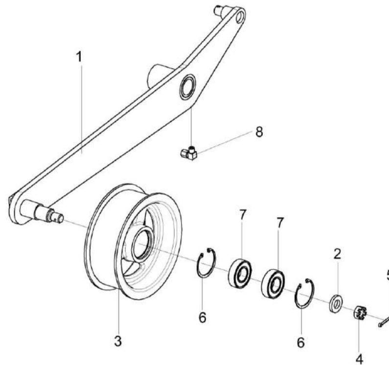
Рисунок 321 – Устройство натяжное КЗК-14-0125200 и КЗК-14-0125220
