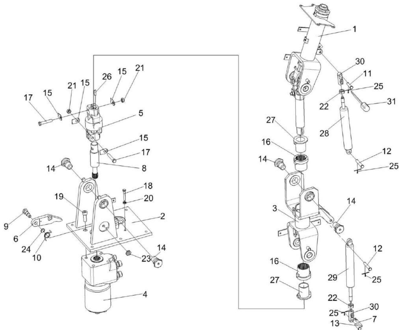
Рисунок 198 – Привод КЗК-1420-0119240
