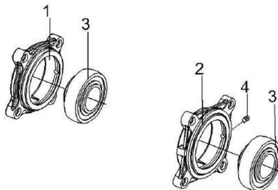
Рисунок 80 – Опоры КЗК-1420-0102420 и КЗК 0102350
