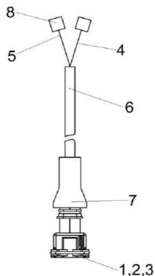
Рисунок 252 – Жгут датчика фильтра КВК 0700300
