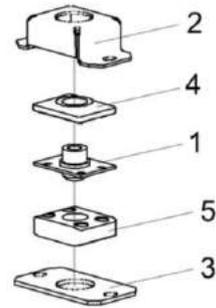
Рисунок 123 – Амортизатор СЭУ 0400410
