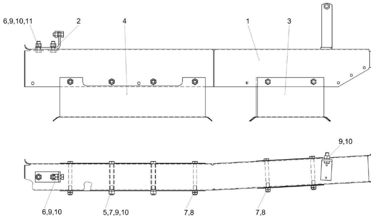
Рисунок 231 – Установка короба маслопроводов КЗК-1420-0100060А
