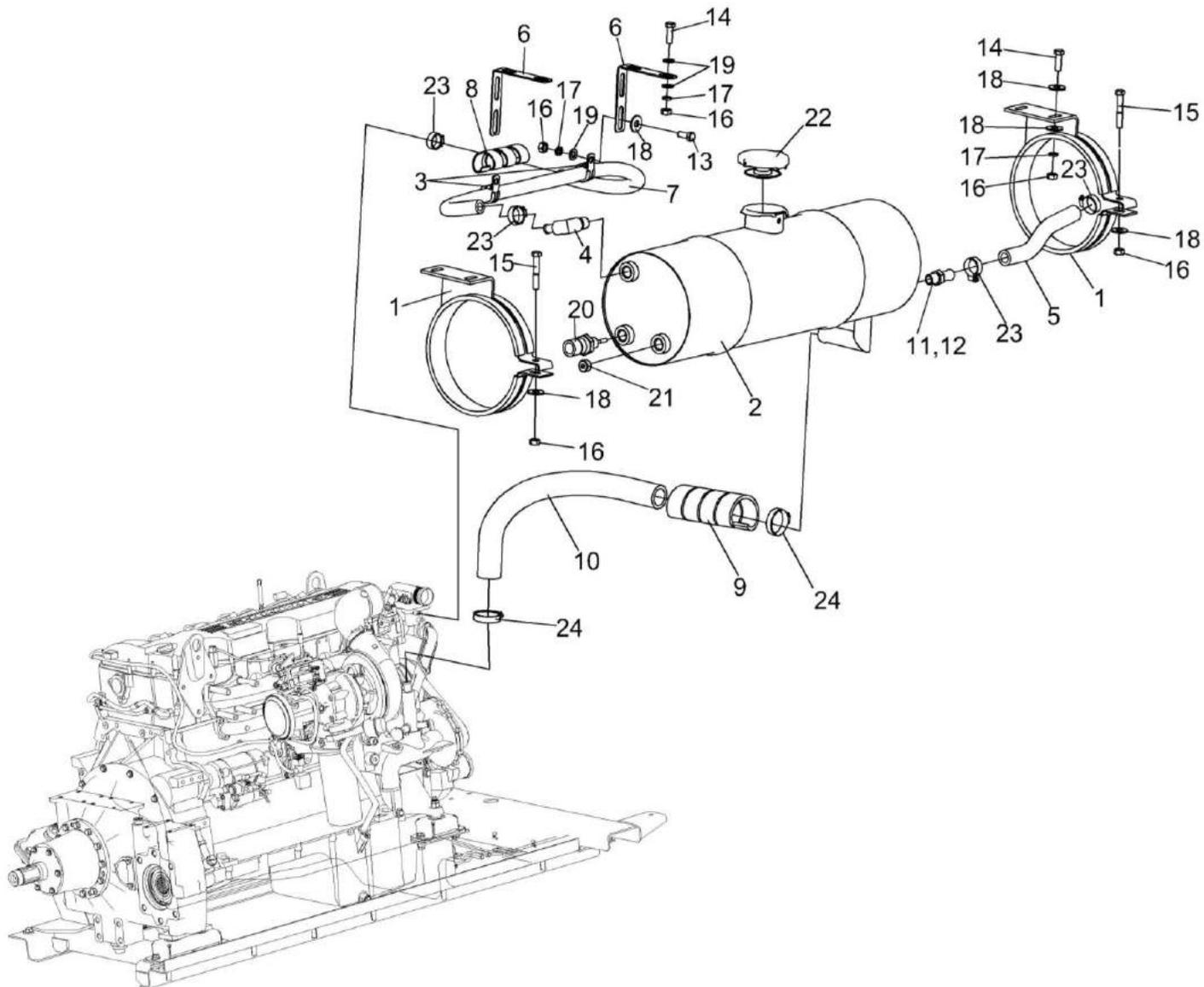
Рисунок 135 – Установка бачка расширительного КЗК-16-6-0106070
