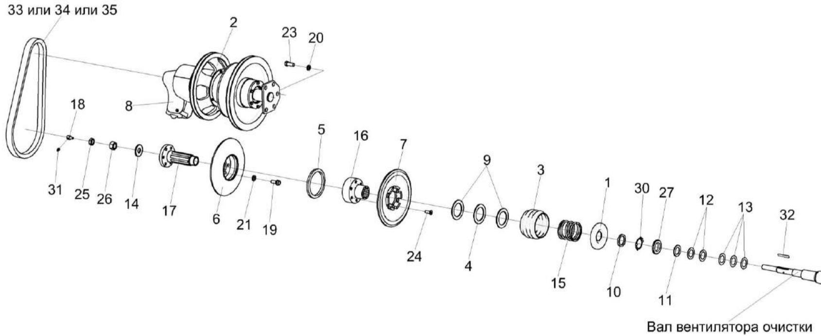
Рисунок 16 – Установка привода вентилятора КЗК-1420-0202450
