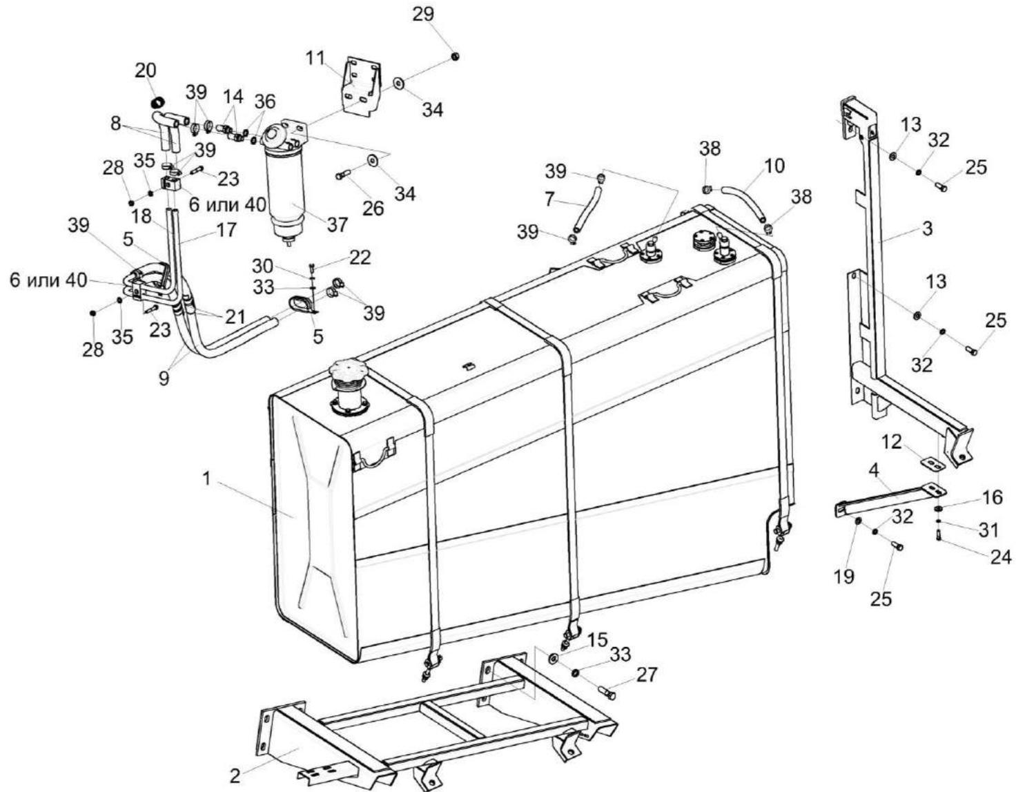
Рисунок 293 – Установка топливной системы КЗК-16-6-0126000 (лист 1)
