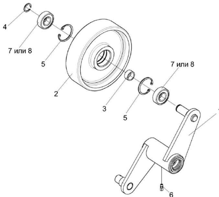
Рисунок 77 – Ролик КЗК-1420-0102320
