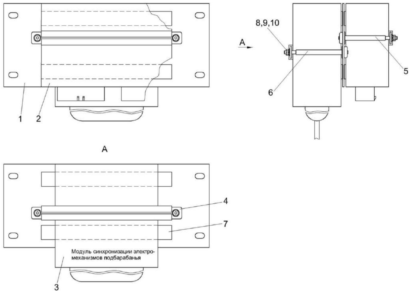
Рисунок 311 – Панель модулей нижняя КЗК-1420-0701170
