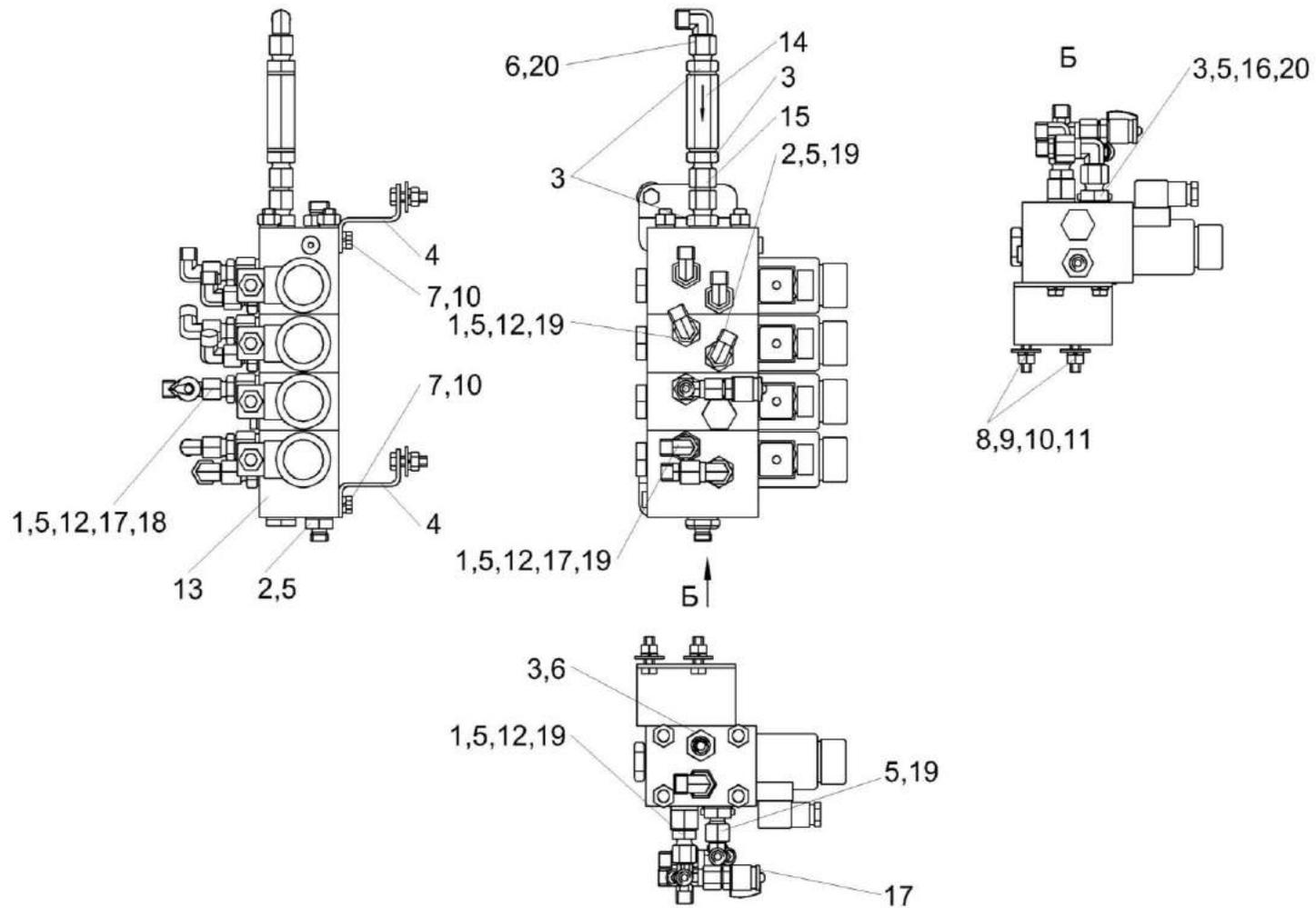
Рисунок 287 – Гидроблок низкого давления КЗК-16-1-0609330
