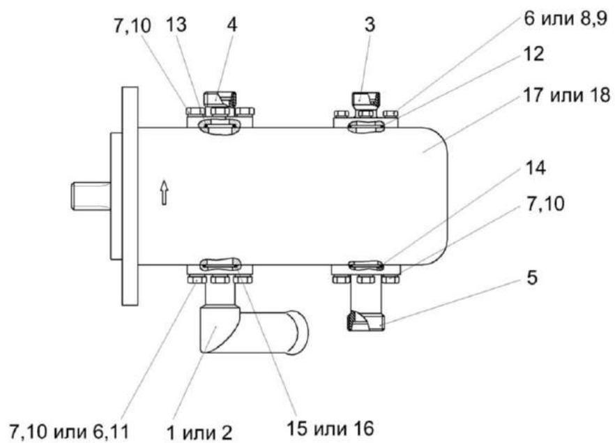
Рисунок 271 – Гидронасос двухсекционный КЗК-16-1-0602100 и КЗК-16-1-0602140
