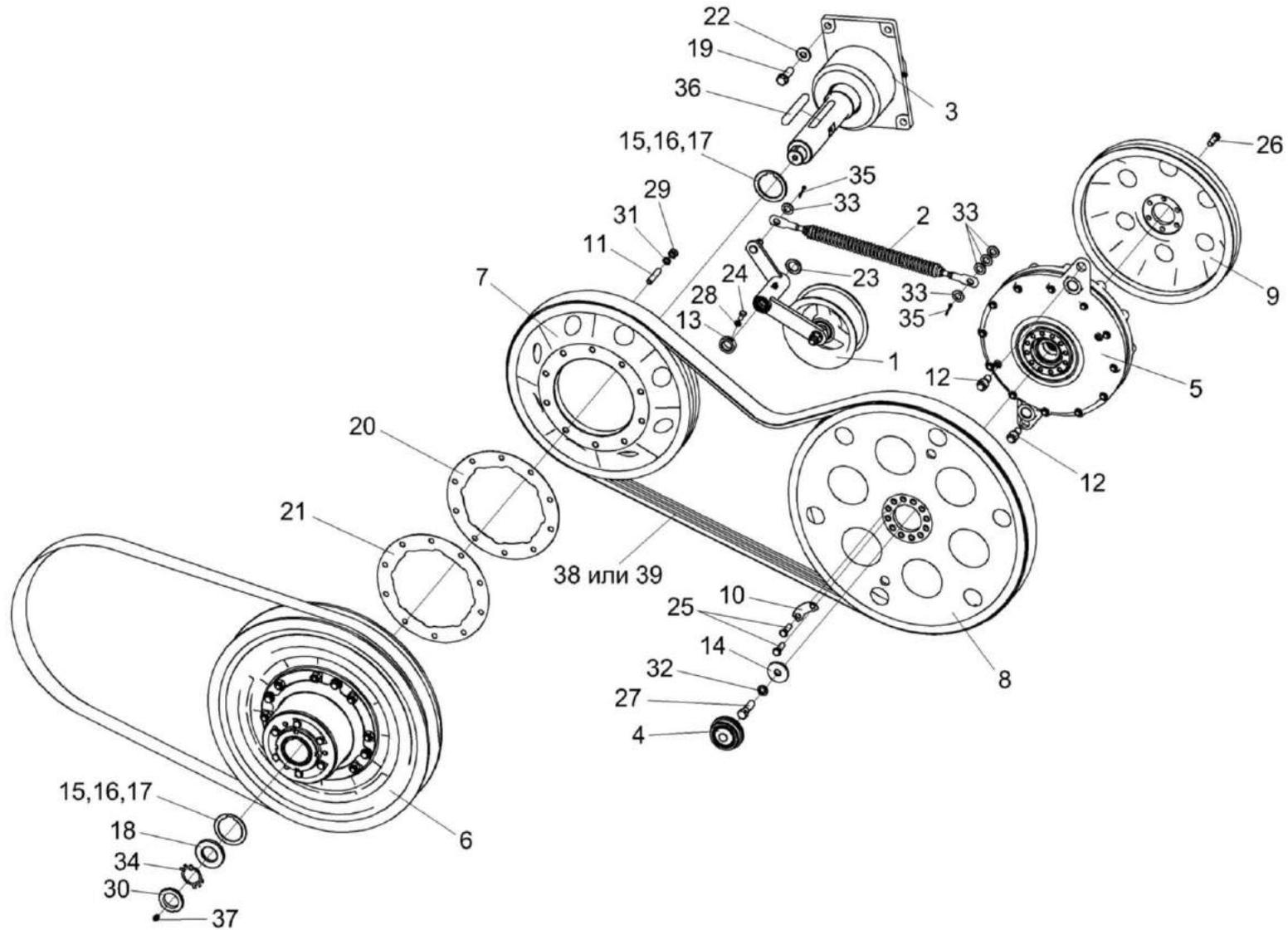
Рисунок 90 – Привод молотильного барабана КЗК-14-0134000
