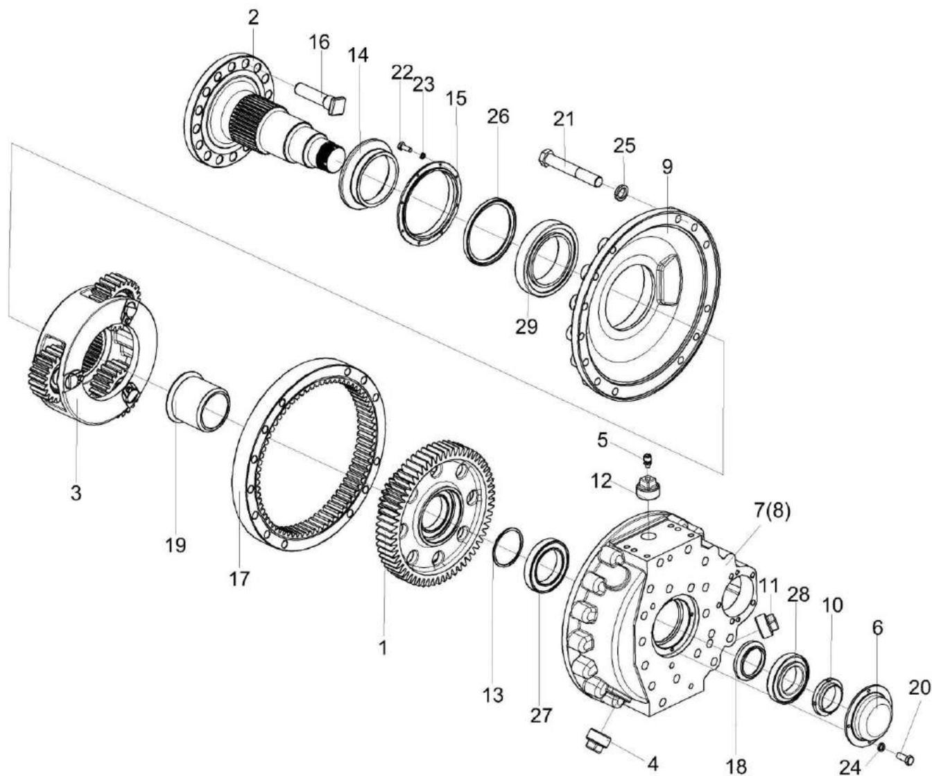
Рисунок 101– Редукторы бортовые КЗК-14-0107020-01 (изображен) и КЗК-14-0107020 (зеркальное отражение) (лист 1)
