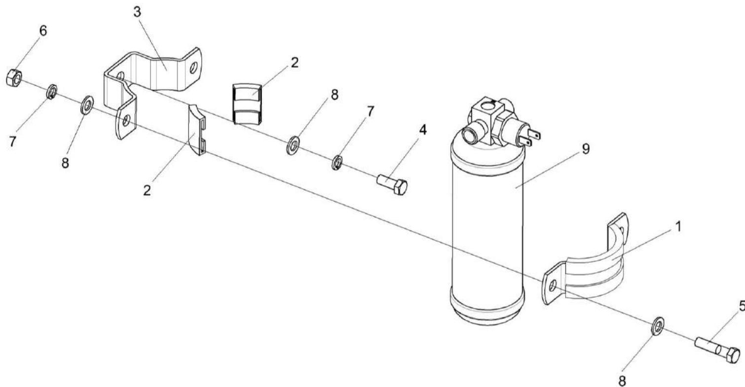
Рисунок 219 – Установка ресивера КЗК-8-3-0113050
