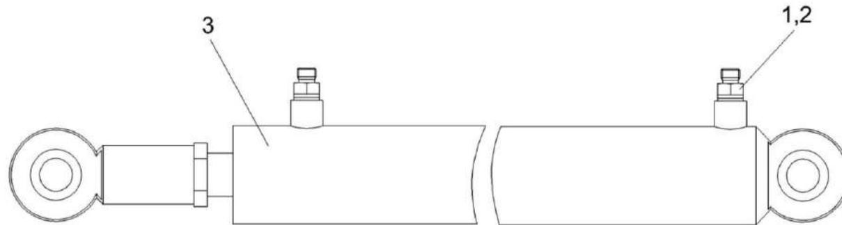
Рисунок 164 – Гидроцилиндр поворота выгрузного шнека КЗК-1420-0602500
