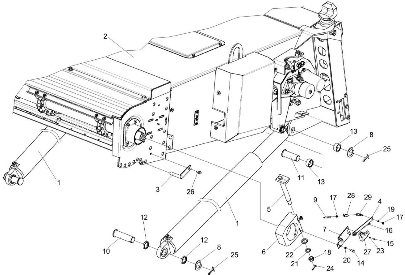
Рисунок 2 – Установка камеры наклонной КЗК-1420-1800000А (лист 2)
