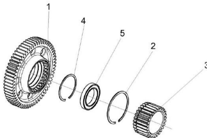
Рисунок 104 – Колесо зубчатое КВК 0106140
