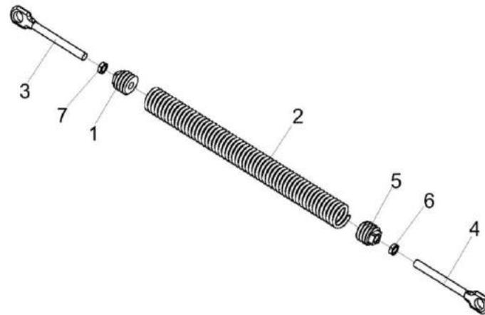
Рисунок 30 – Пружина КЗК-2124-0214150
