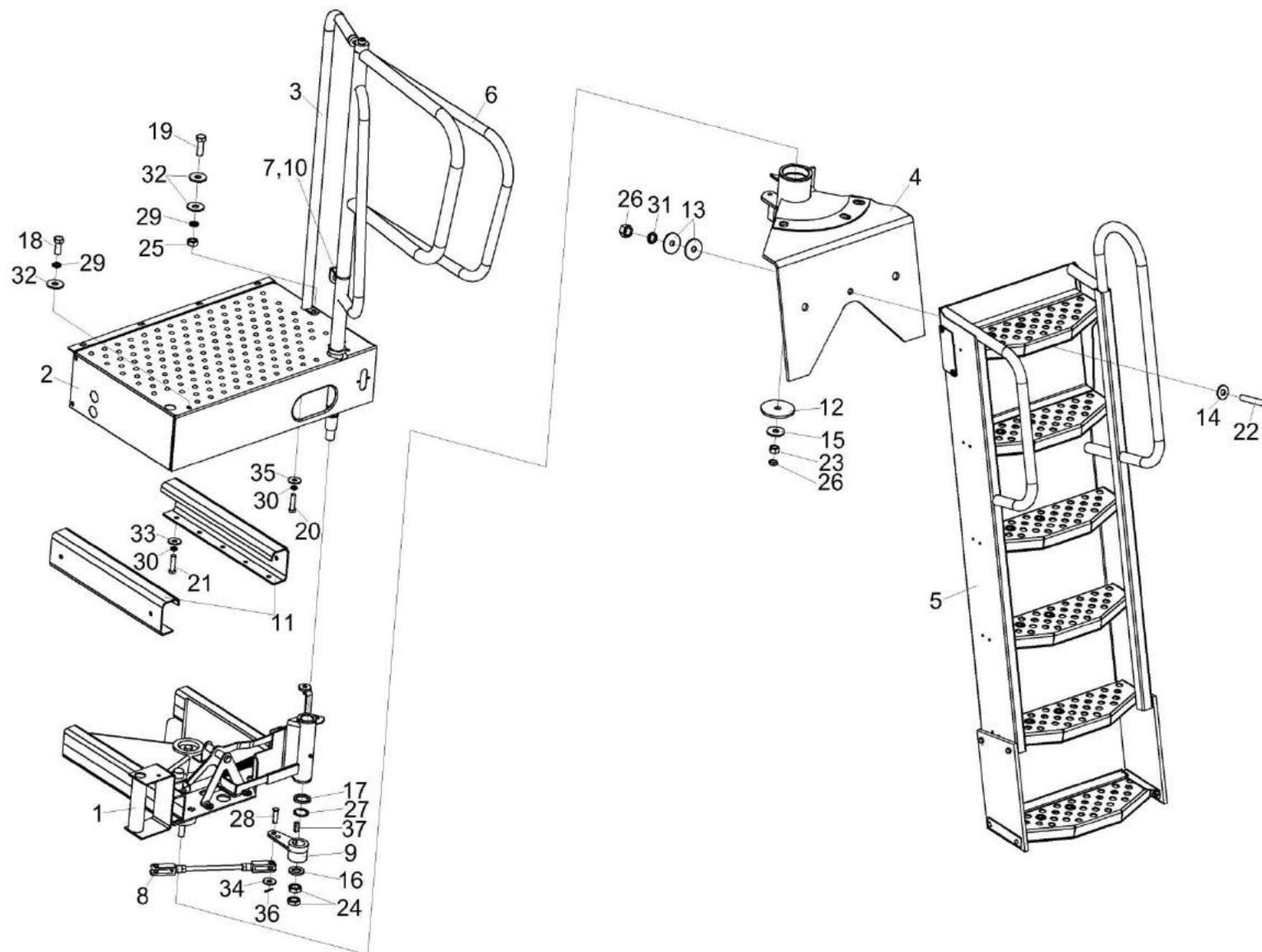
Рисунок 225 – Установка трапа КЗК-2124-0117000
