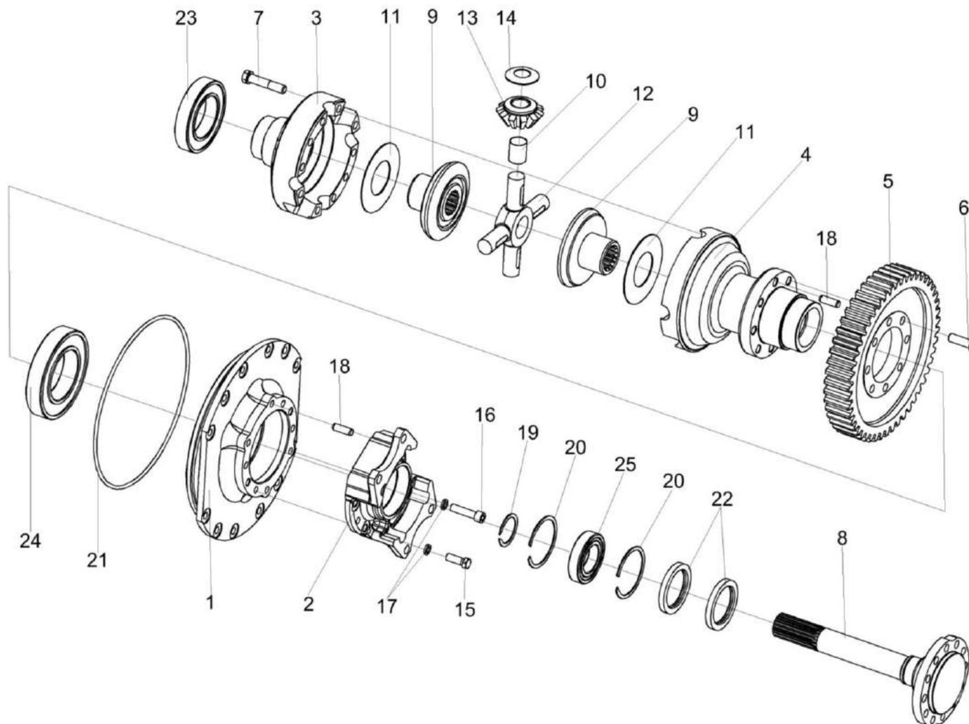
Рисунок 107 – Блок дифференциала КЗК-1624-0107210
