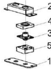
Рисунок 122 – Амортизатор КЗК-10-0106160
