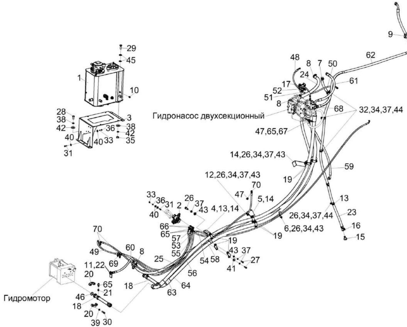
Рисунок 248 – Гидросистема привода ходовой части комбайна КЗС-1624-1 КЗК-16-1-0601000
