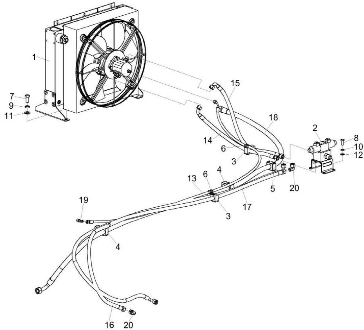
Рисунок 273 – Гидросистема привода радиатора комбайна КЗС-1624-1 КЗК-16-1-0604000
