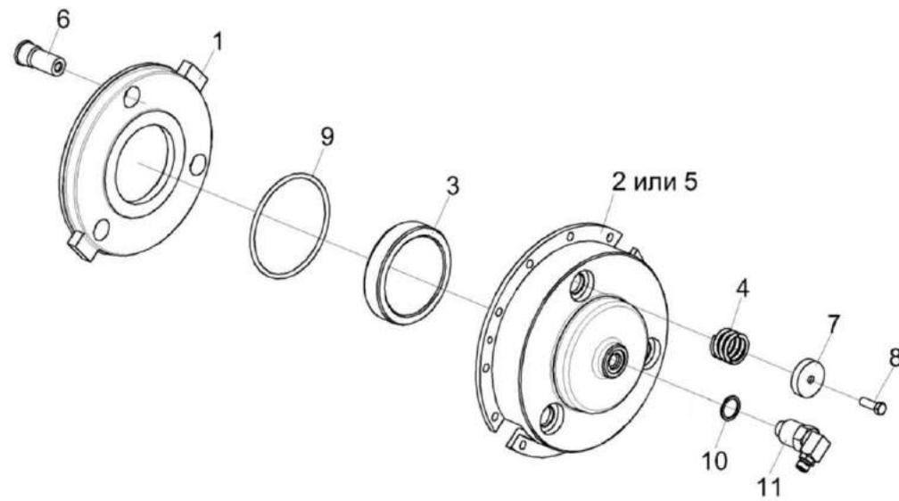
Рисунок 319 – Гидромуфта КЗК-14-0125040
