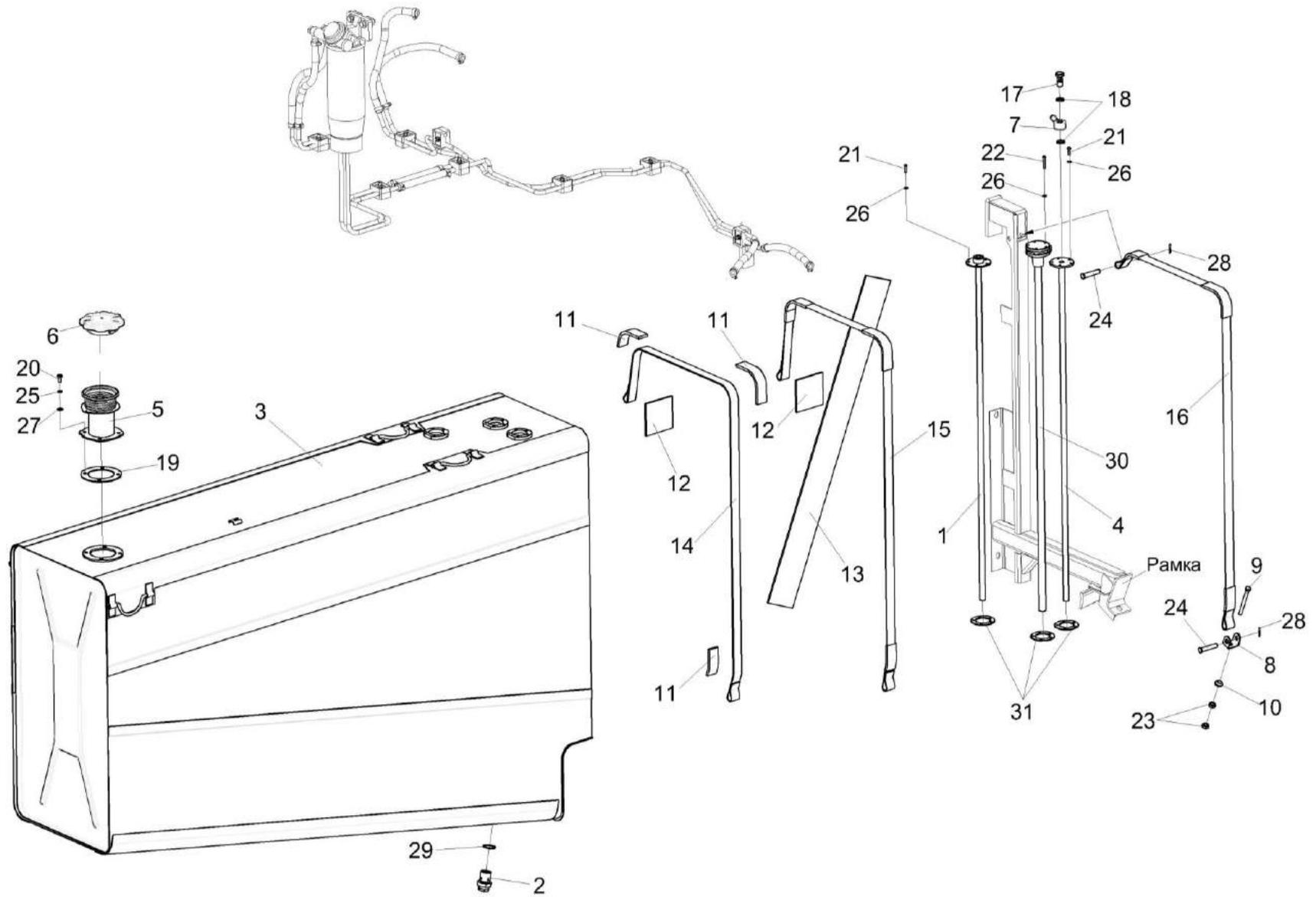
Рисунок 294 – Установка топливной системы КЗК-16-6-0126000 (лист 2)
