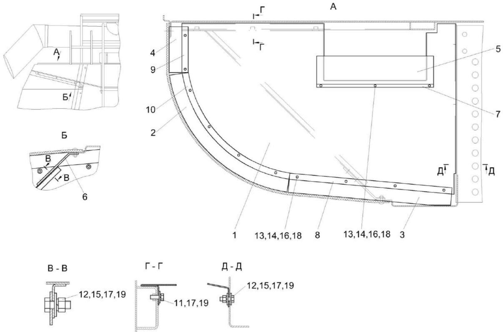
Рисунок 239– Установка щита КЗК-16-1-0100500
