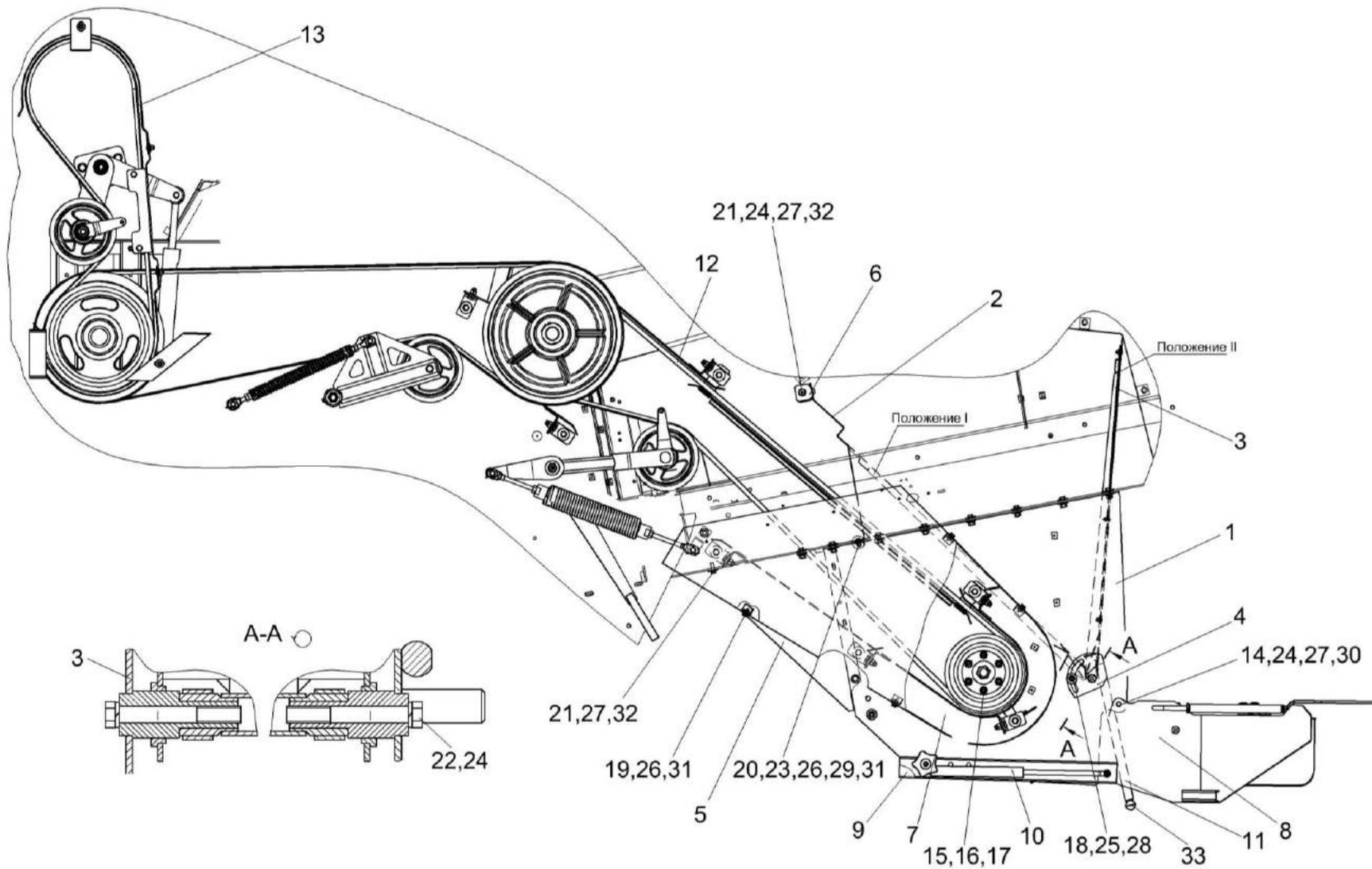
Рисунок 170 – Установка соломоизмельчителя КЗК-2124-0290500
