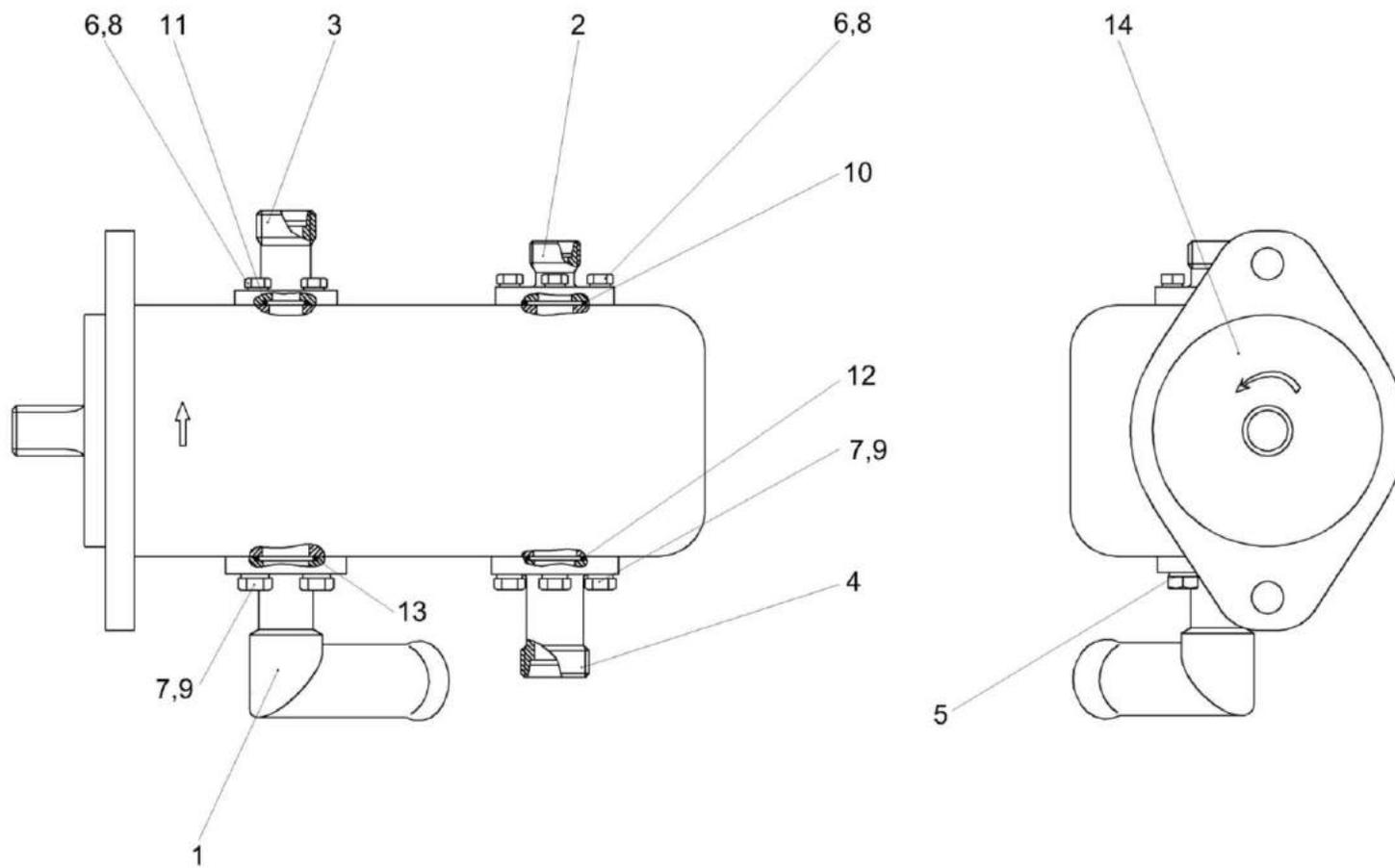
Рисунок 272 – Гидронасос двухсекционный КЗК-16-1-0602160
