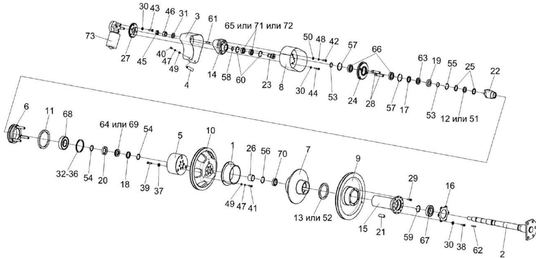
Рисунок 17 – Контрпривод вариатора КЗК-1420-0202500
