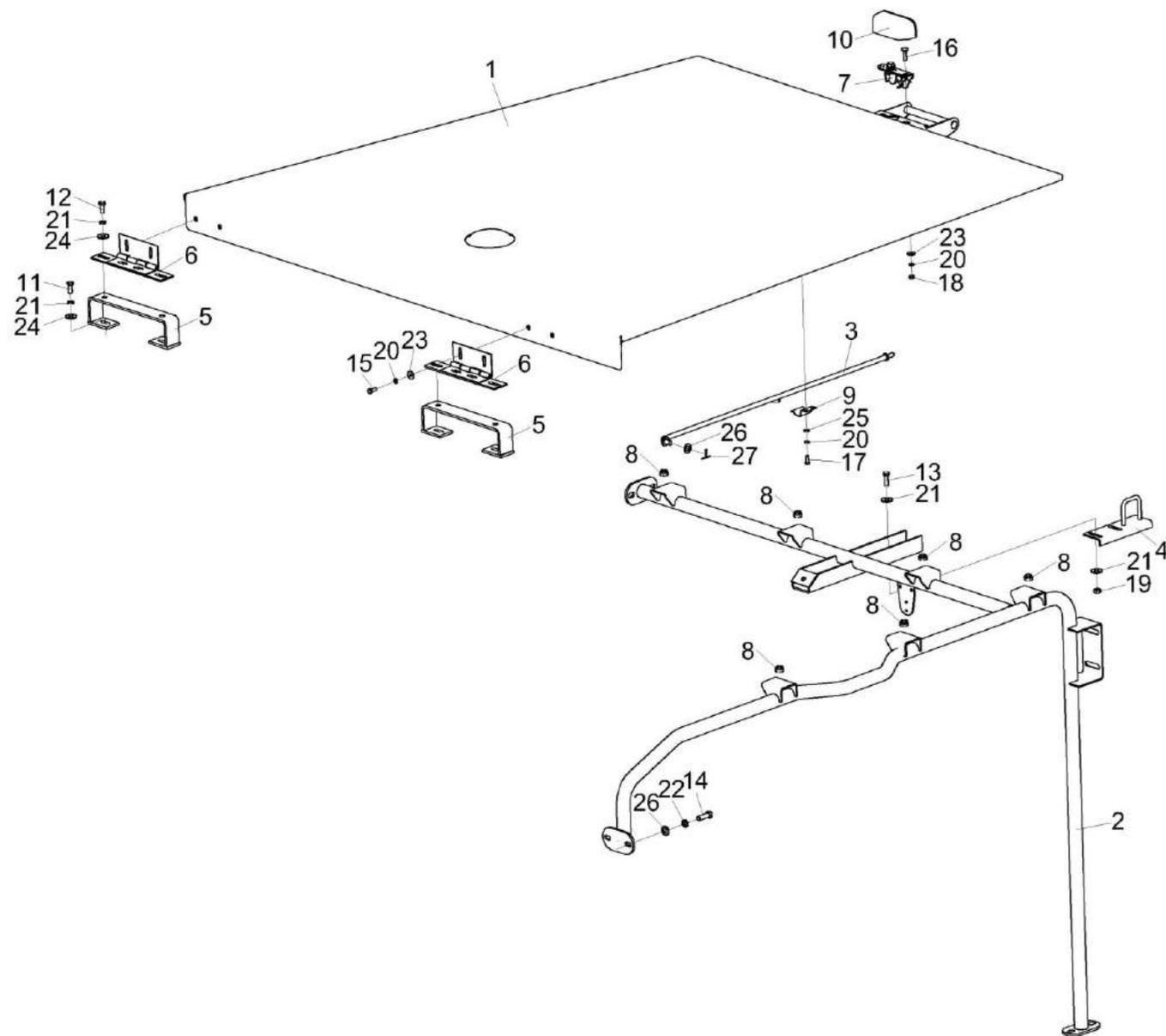
Рисунок 233 – Установка крыши моторного отсека КЗК-16-6-0124000
