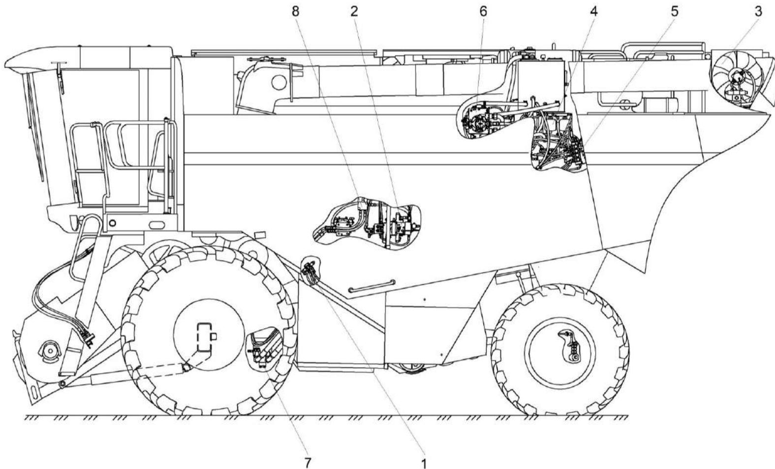
Рисунок 246 – Гидросистема КЗК-16-1-0600000
