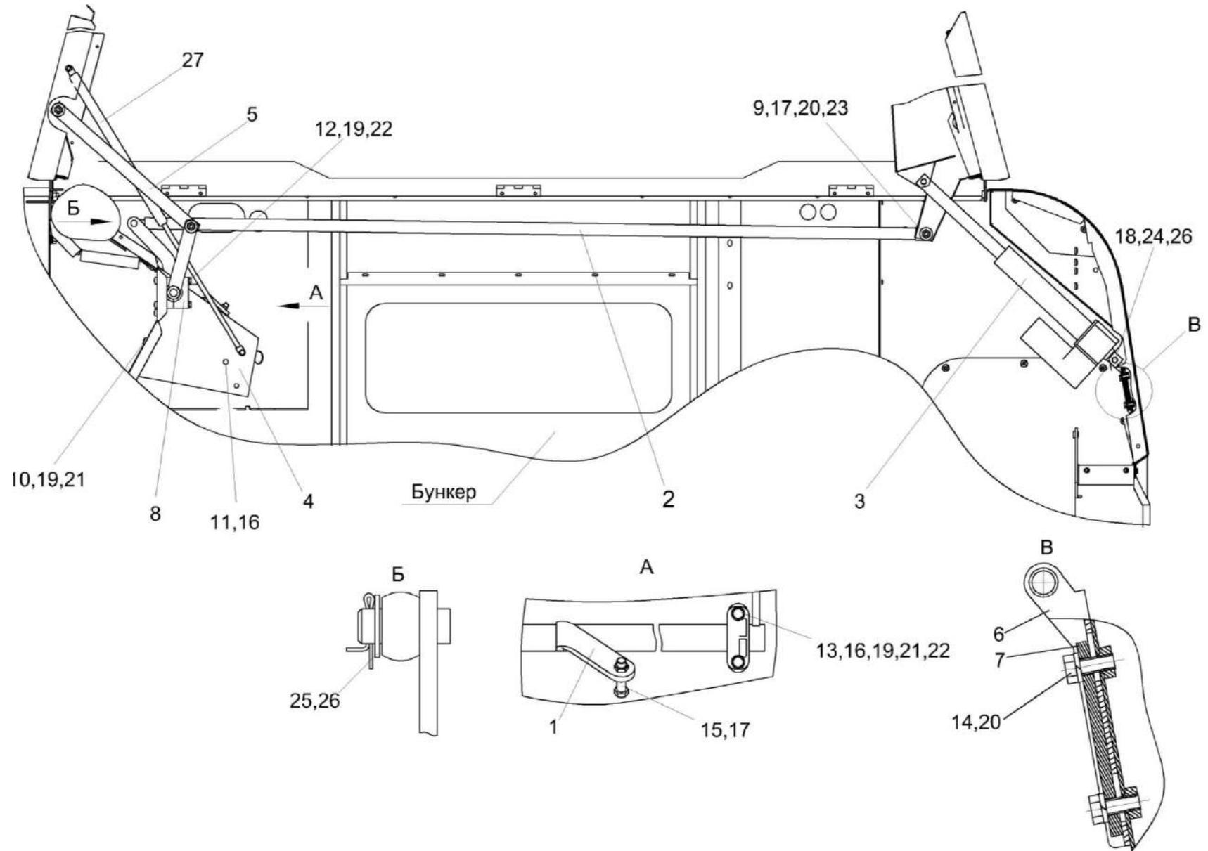
Рисунок 155 – Установка механизма трансформации КЗК-14-0204040А
