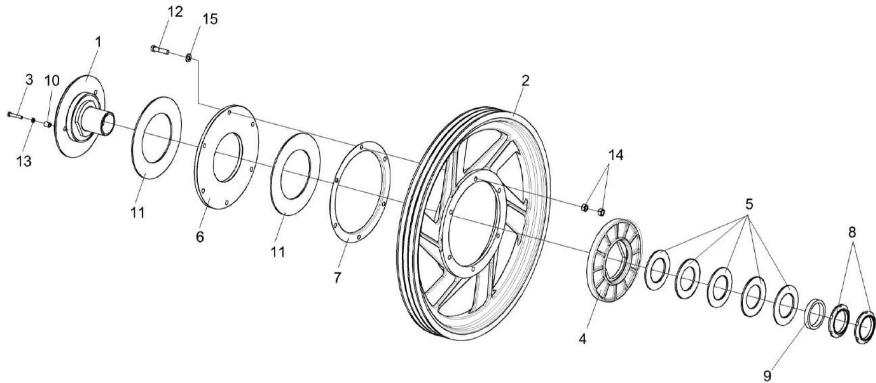
Рисунок 20 – Муфта предохранительная КЗК-1420-1800420
