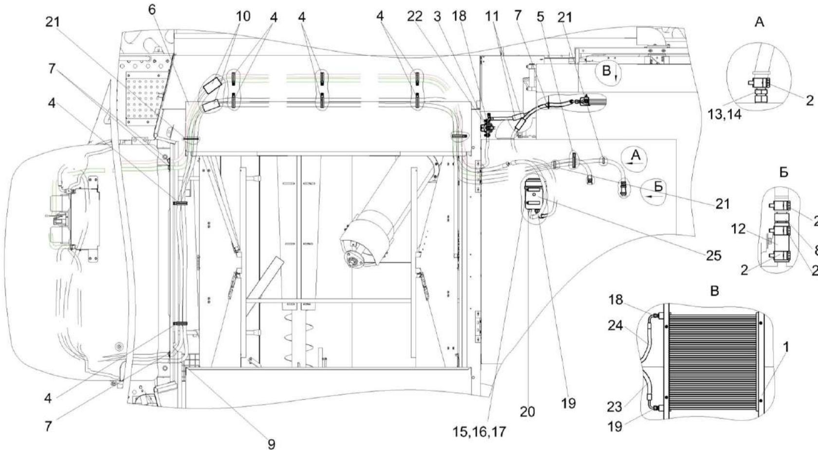
Рисунок 216 – Установка оборудования кондиционера КЗК-16-6-0113010
