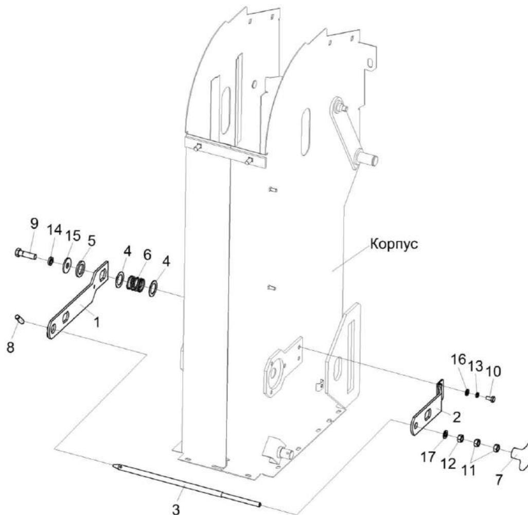
Рисунок 31 – Установка датчиков КЗК-2124-0214200
