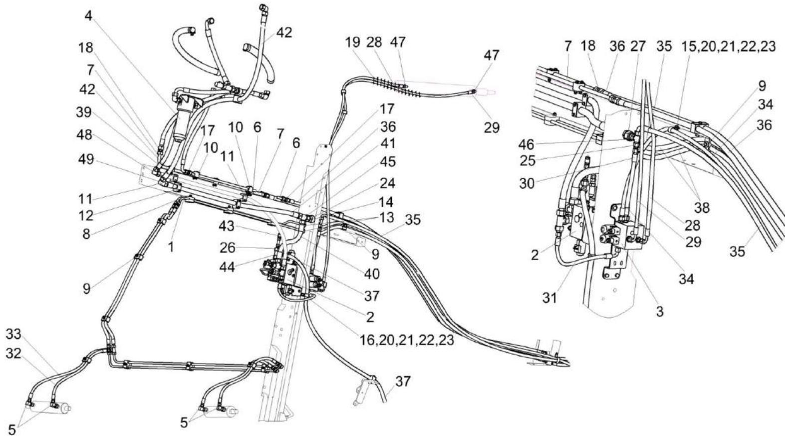
Рисунок 260 – Гидросистема рулевого управления и силовых гидроцилиндров комбайна КЗС-1624-1
