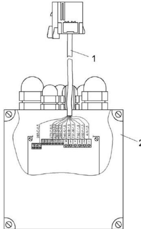
Рисунок 313– Модуль синхронизации КЗК-1420-0701880
