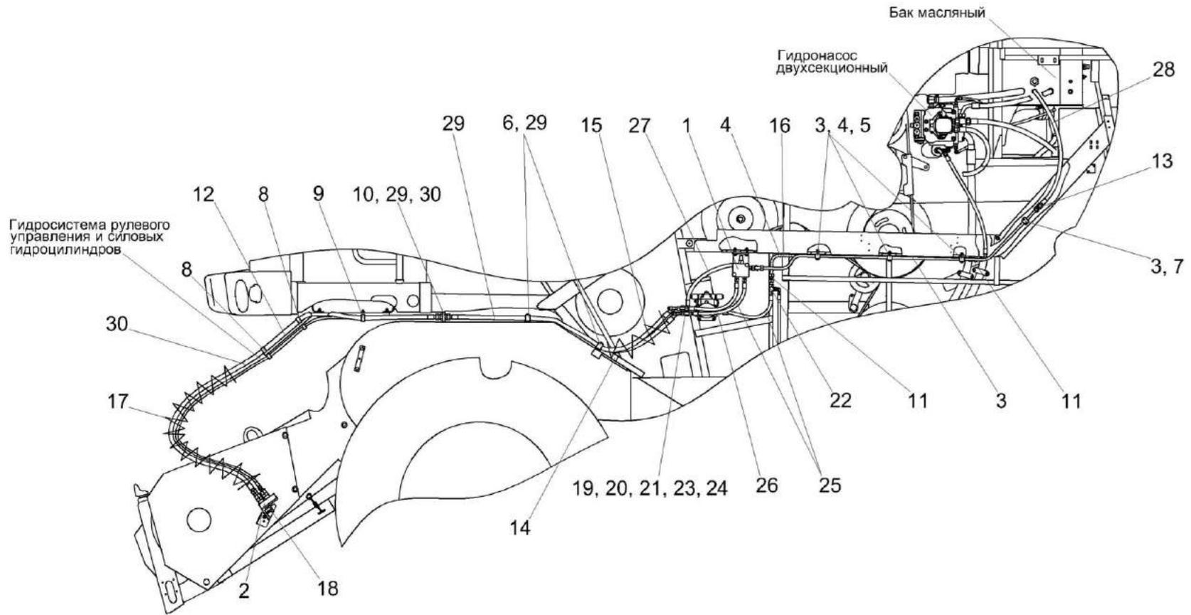
Рисунок 284 – Гидросистема привода мотовила комбайна КЗК-1420-0608000
