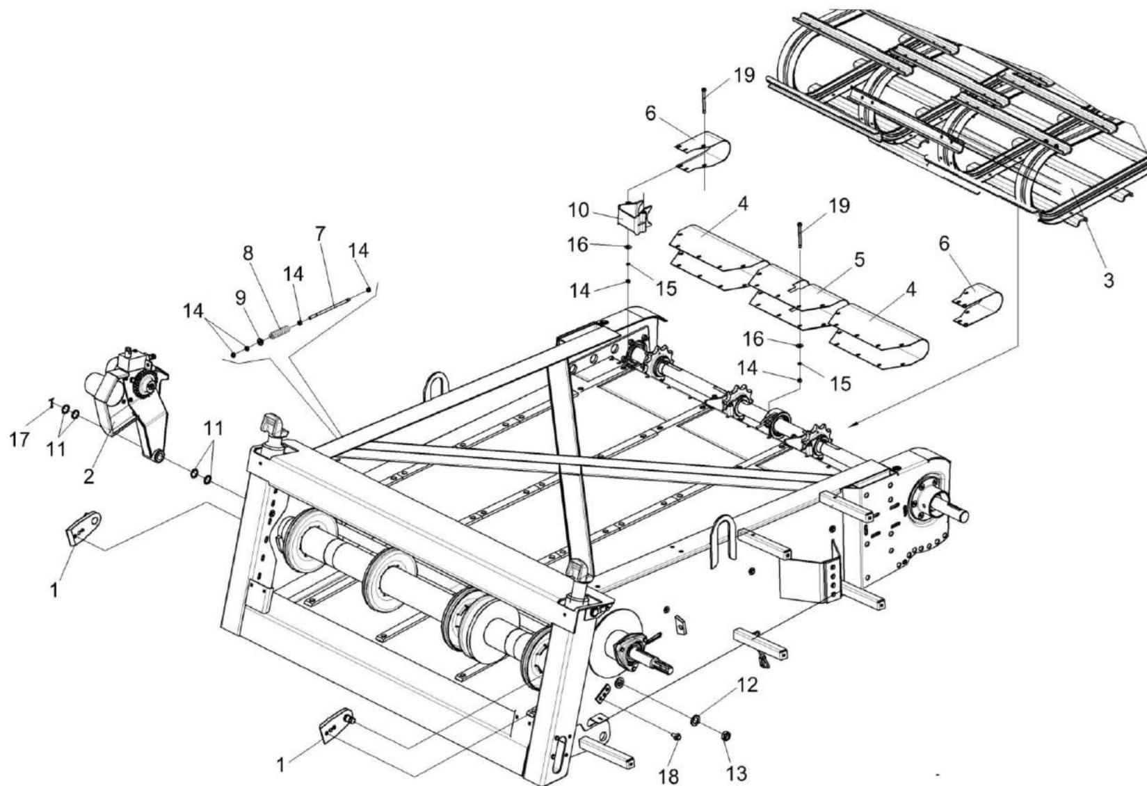
Рисунок 7 – Камера наклонная КЗК-1420-1810010 (лист 3)
