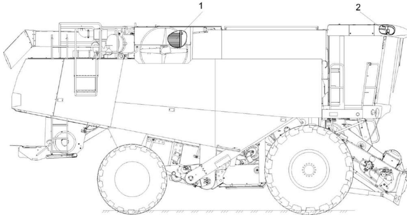
Рисунок 215 – Установка климатическая КЗК-16-6-0113000
