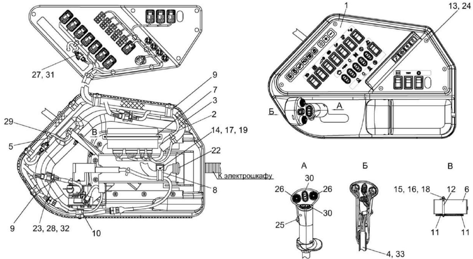
Рисунок 211 – Установка электрооборудования пульта КЗК-16-6-0725000
