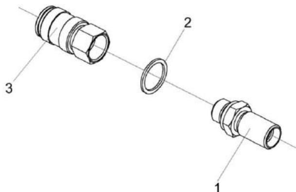
Рисунок 300 – Пневмовывод КНС-6028-0180110 и КЗК-16-1-0800110
