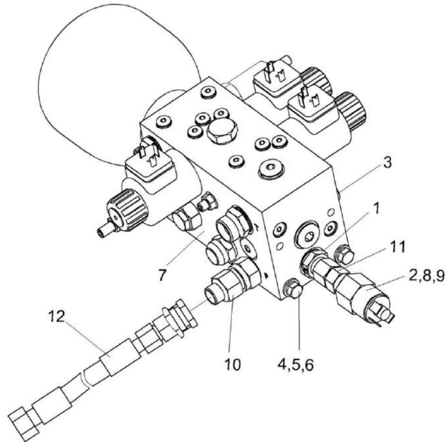
Рисунок 12 – Гидроблок поперечного копирования и реверса наклонной камеры КЗК-1420-0679330
