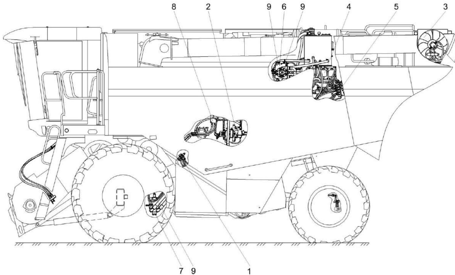
Рисунок 247 – Гидросистема КЗК-16-1-0600000-01
