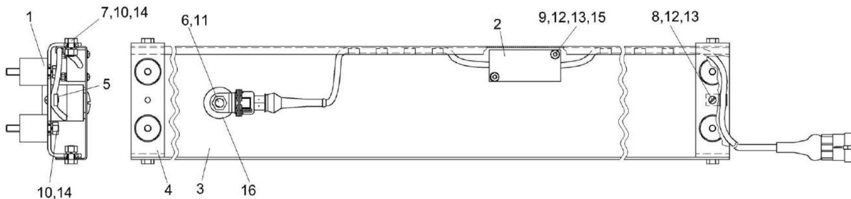
Рисунок 316– Датчик потерь зерна после очистки КЗК-1420-0701740
