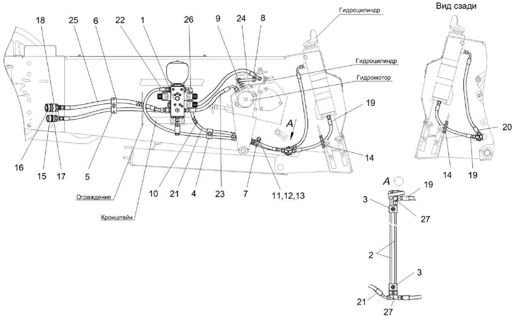
Рисунок 11 – Гидросистема наклонной камеры комбайна КЗС-1420 КЗК-1420-0679000
