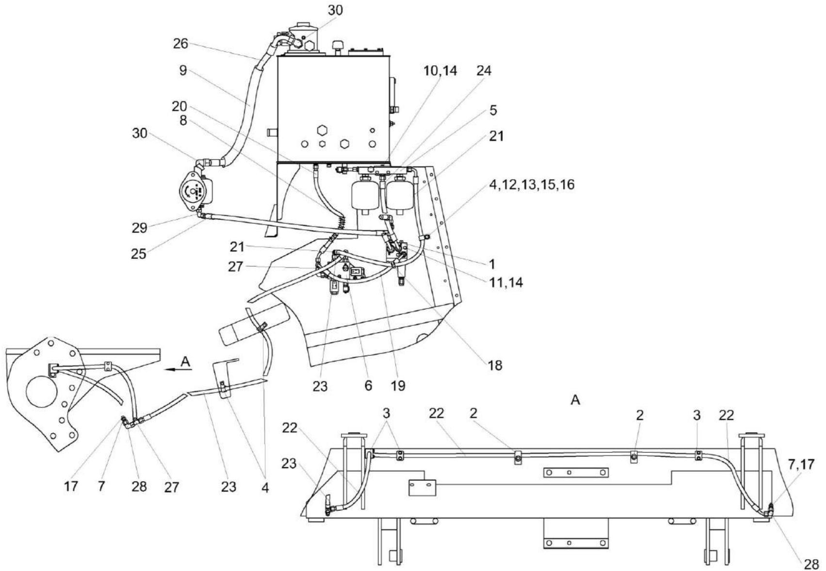
Рисунок 279 – Гидросистема привода стояночного тормоза КЗК-16-1-0606000
