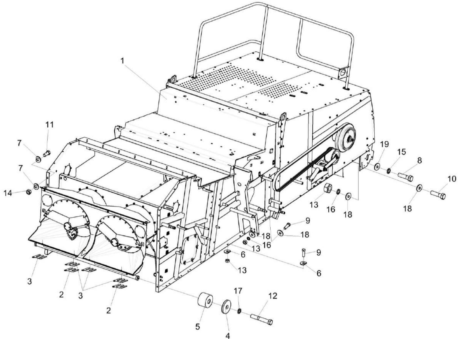
Рисунок 52 – Установка роторного соломосепаратора КЗК-16-6-0212000
