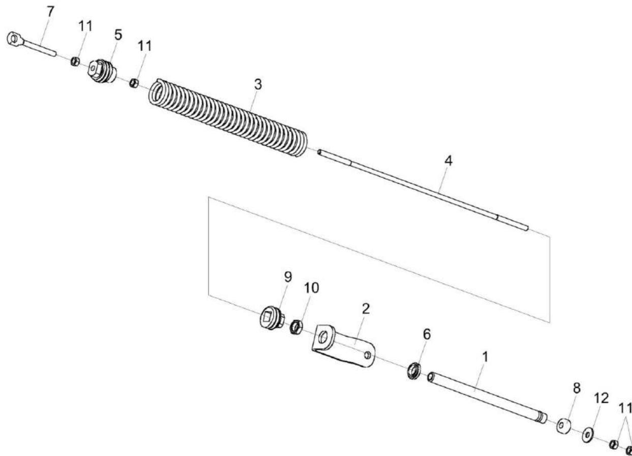
Рисунок 63 – Пружина КЗК-14-0212590
