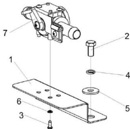
Рисунок 222 – Установка крана отопителя КЗК-8-3-0113070
