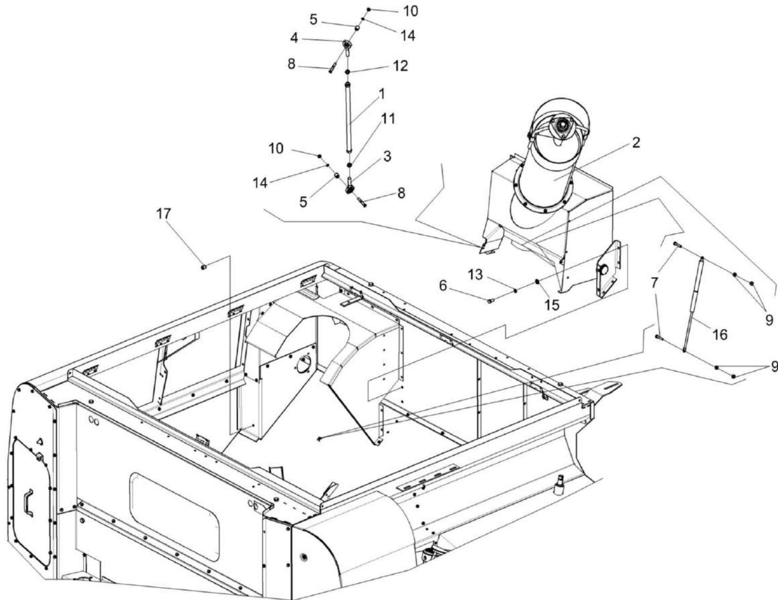
Рисунок 147 – Бункер. Установка шнека загрузки КЗК-14-0216000А
