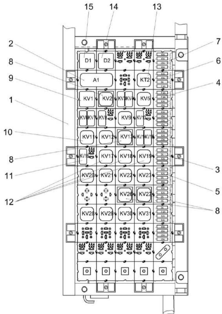
Рисунок 306 – Блок реле КЗК-16-1-0700890
