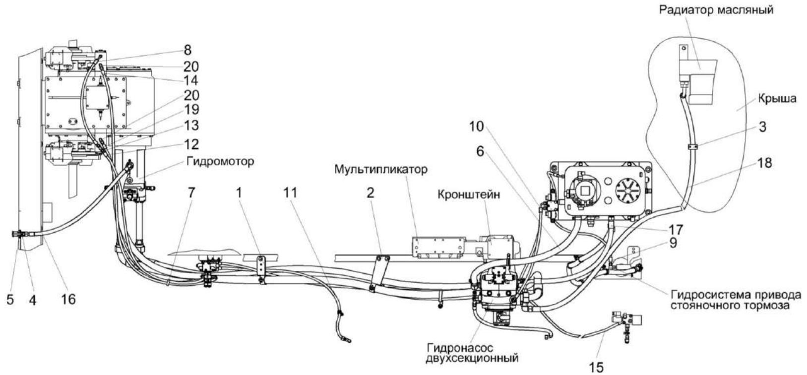
Рисунок 250 – Гидросистема привода ходовой части комбайна КЗС-1624-1 КЗК-16-1-0611000 (лист 2)
