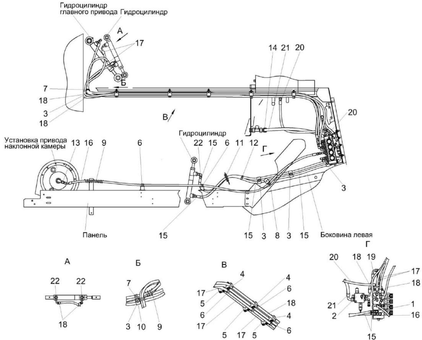
Рисунок 286 – Гидросистема низкого давления КЗК-16-1-0609000А
