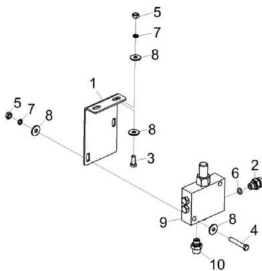
Рисунок 285 – Клапан промывочный КЗК-1420-0608310
