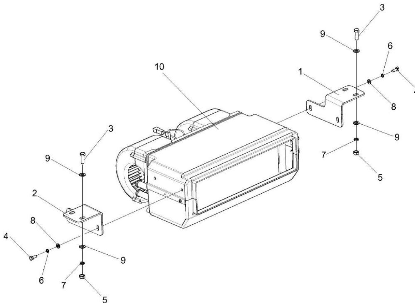
Рисунок 221 – Установка блока испарительно-отопительного КЗК-1420-0113060
