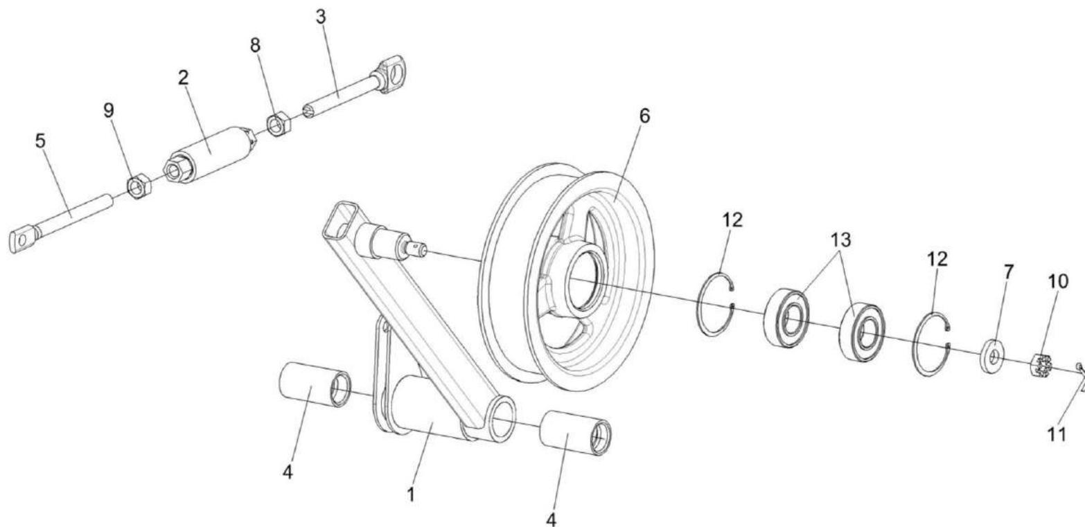
Рисунок 13 – Стяжка КЗК-1420-0202090 и рычаг КЗК-14-0202230
