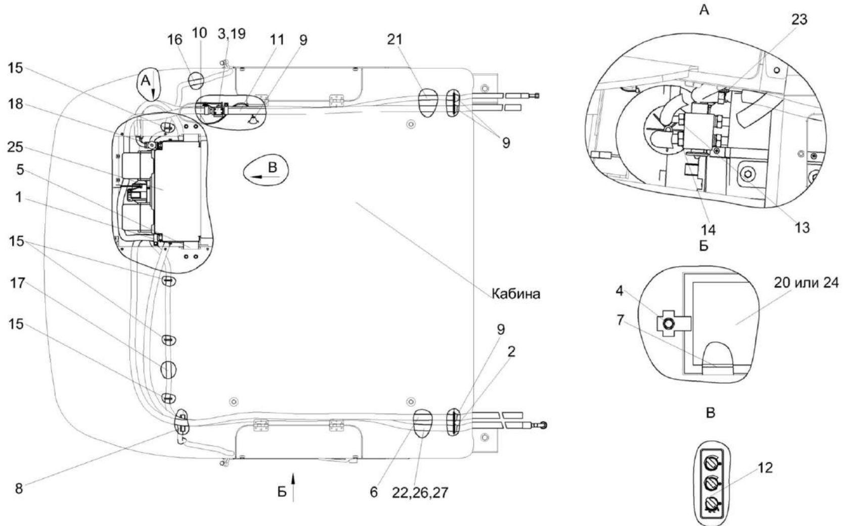
Рисунок 220 – Установка испарителя КЗК-16-6-0113020
