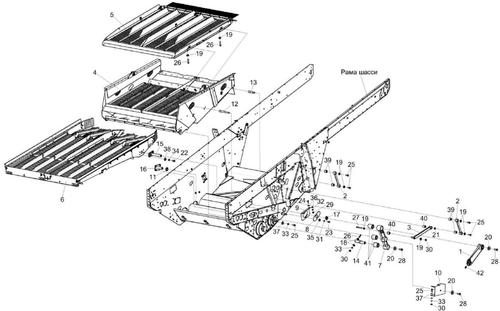
Рисунок 8 – Очистка. Установка стана решётного верхнего КЗК-14-0260000А (лист 1)
