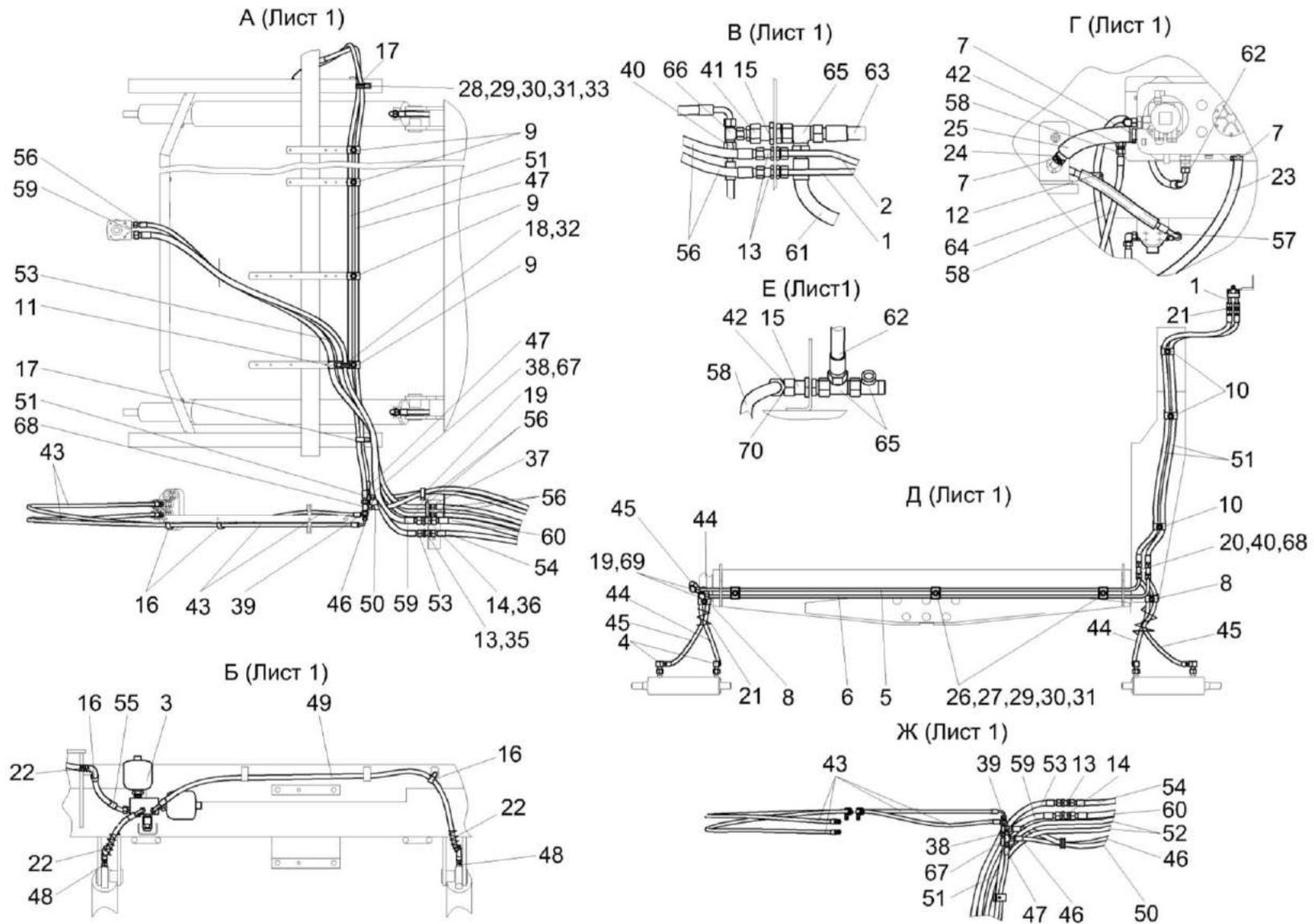
Рисунок 259 – Гидросистема рулевого управления и силовых гидроцилиндров комбайна КЗС-1624-1 КЗК-16-1-0602000 (лист 2)
