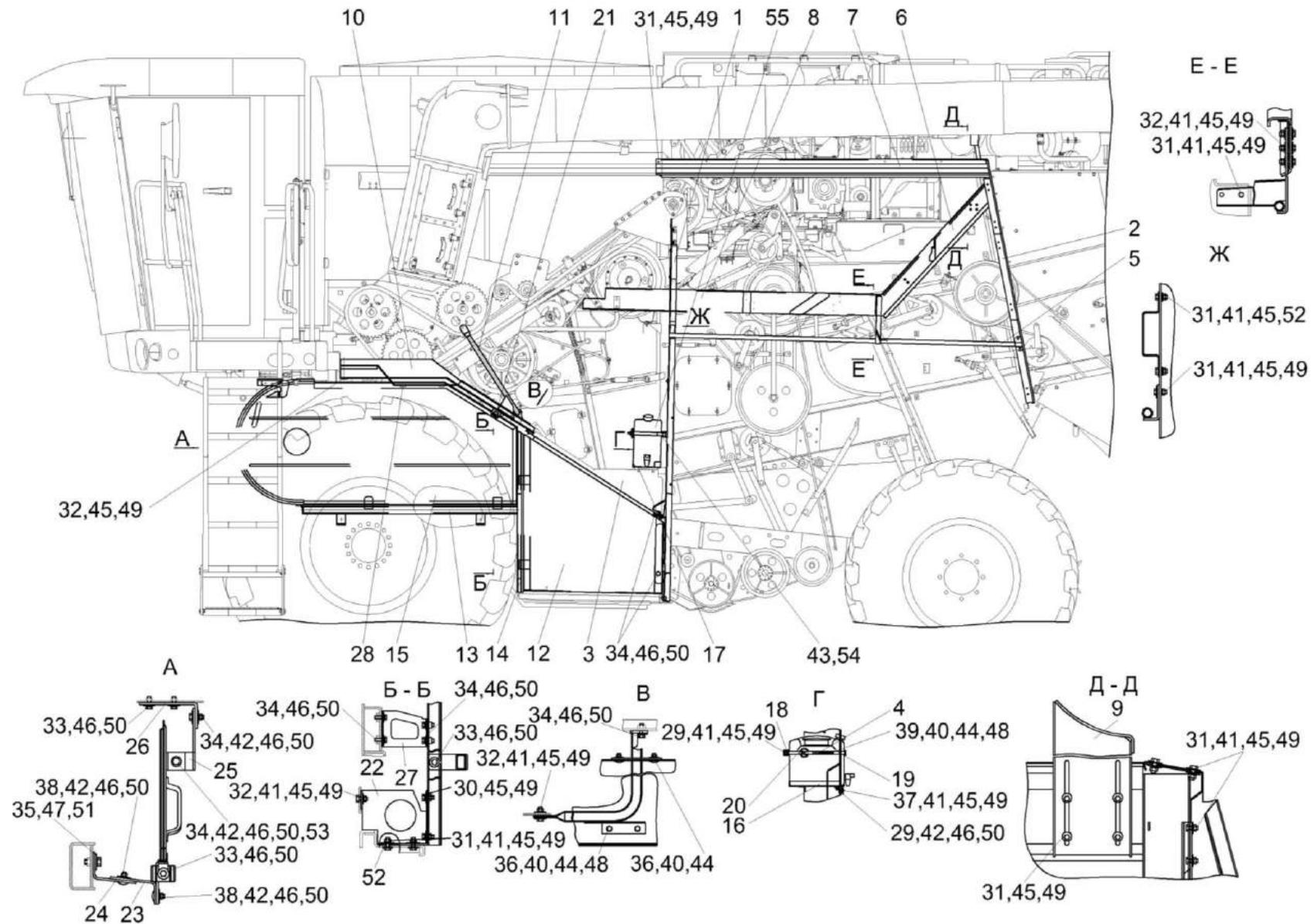
Рисунок 242 – Установка опор капотов КЗК-2124-0132000
