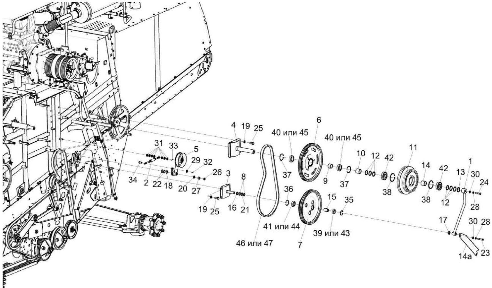
Рисунок 6 – Очистка. Установка шкивов КЗК-14-0202160, КЗК-14-0202170 и КЗК-14-0290460
