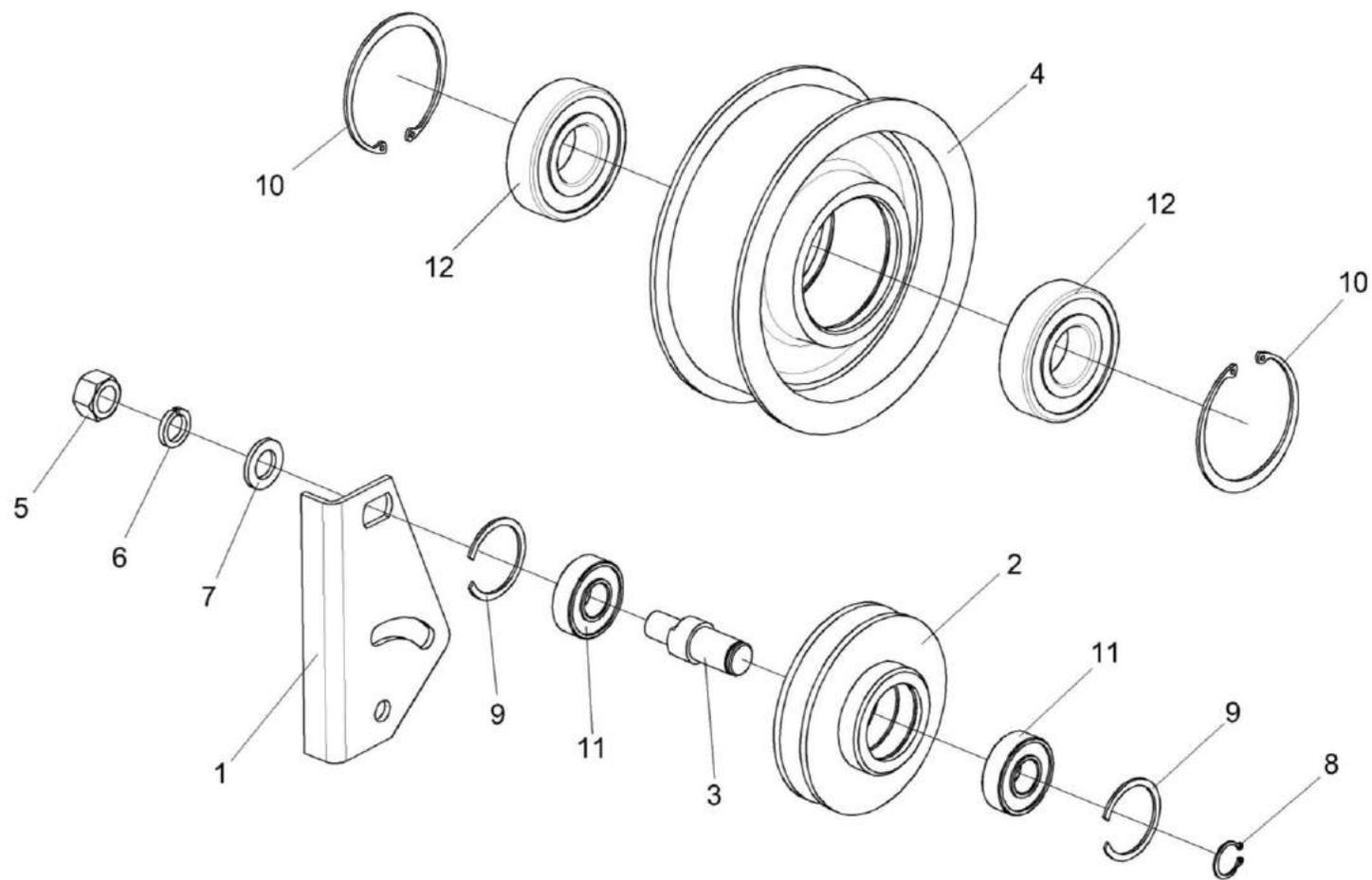
Рисунок 24 – Ролик натяжной КЗК-1420-1808070А и ролик КЗК-1420-1819030
