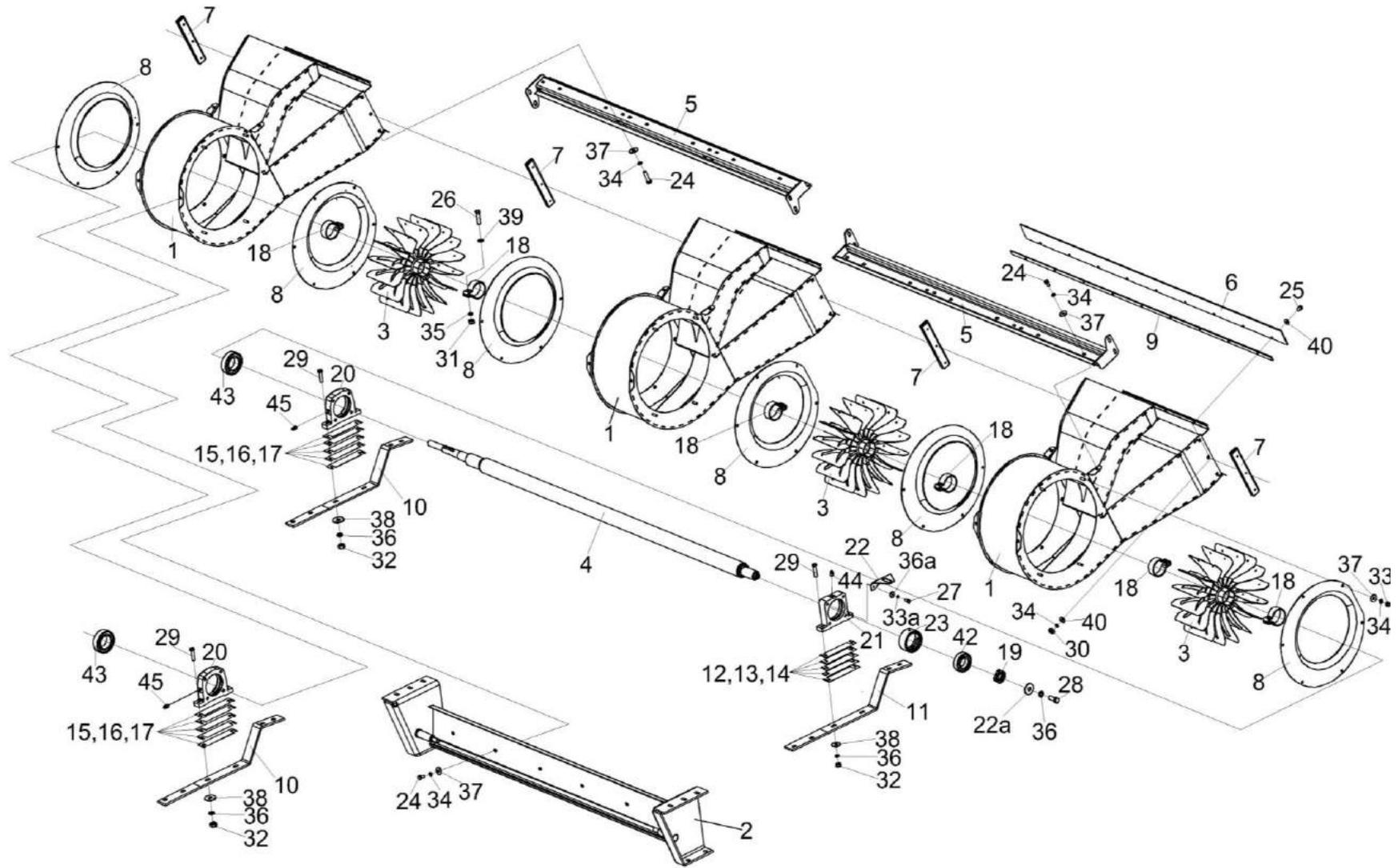
Рисунок 114 – Вентилятор очистки КЗК-14-0217000
