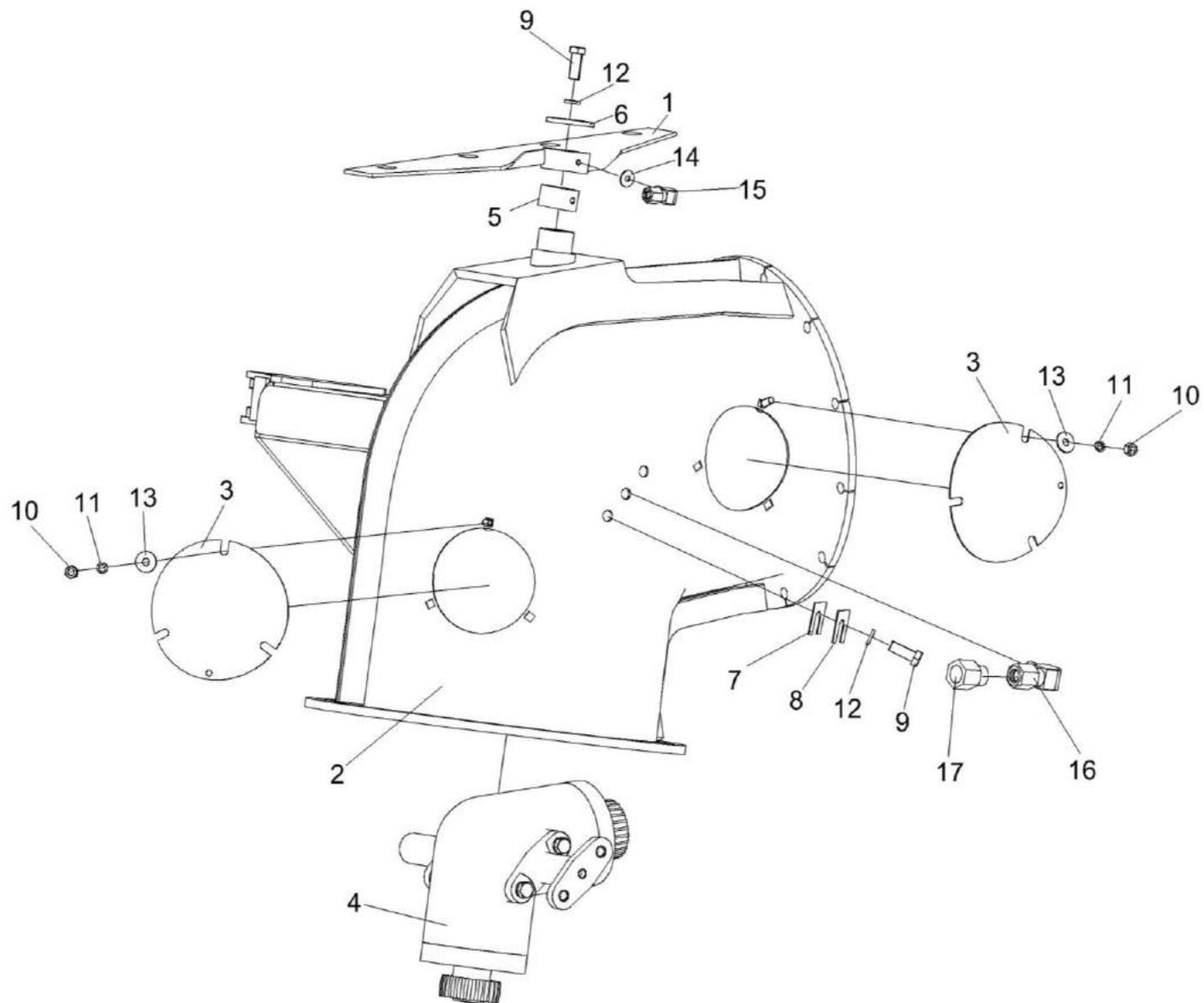
Рисунок 161– Отвод с редуктором КЗК-1420-0206110
