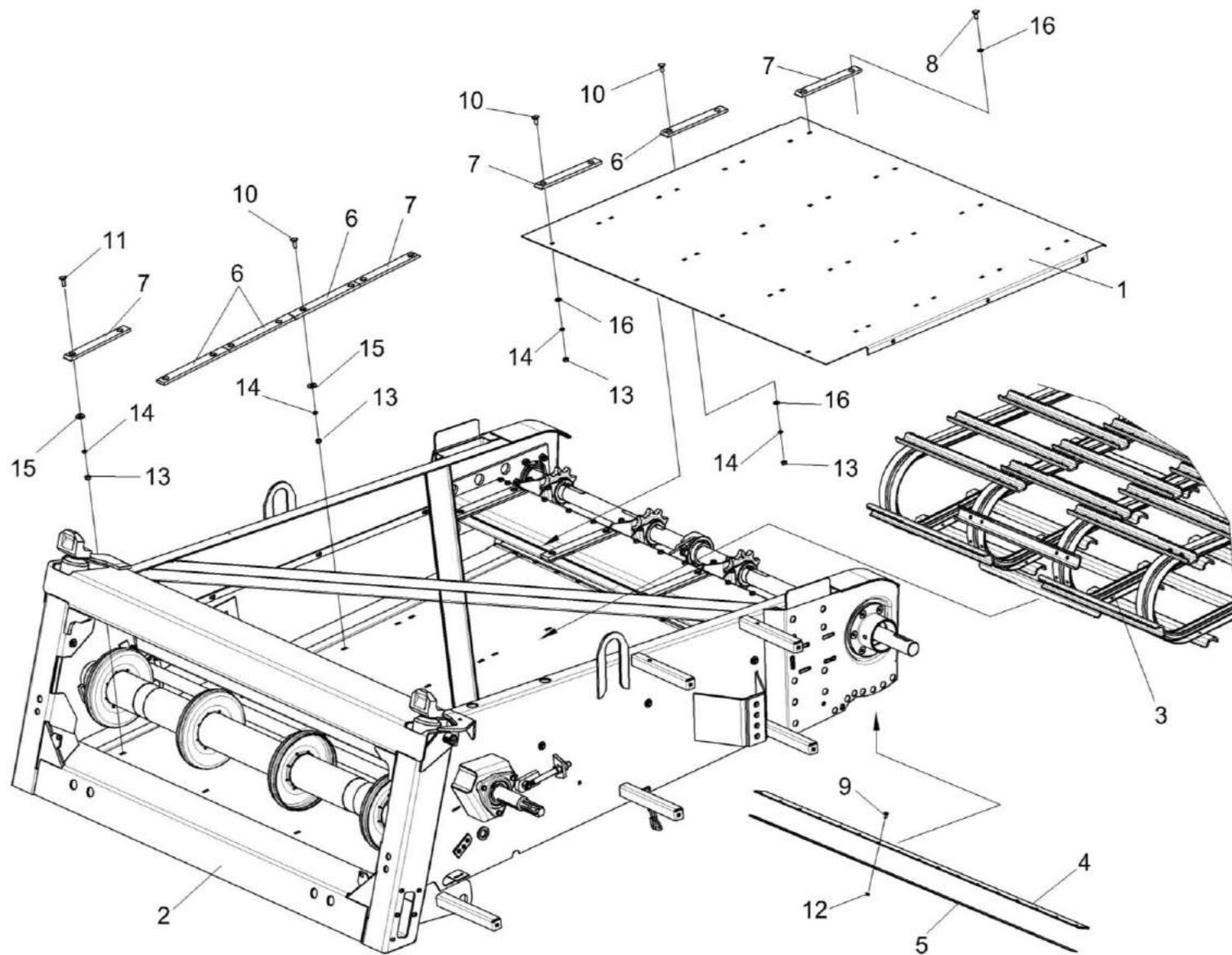
Рисунок 8 – Камера наклонная КЗК-1420-1810010 (лист 4)
