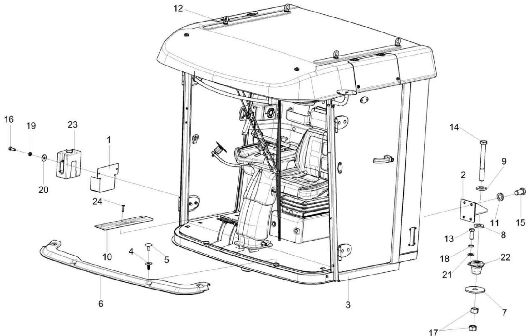
Рисунок 188 – Установка кабины КЗК-16-6-0120000
