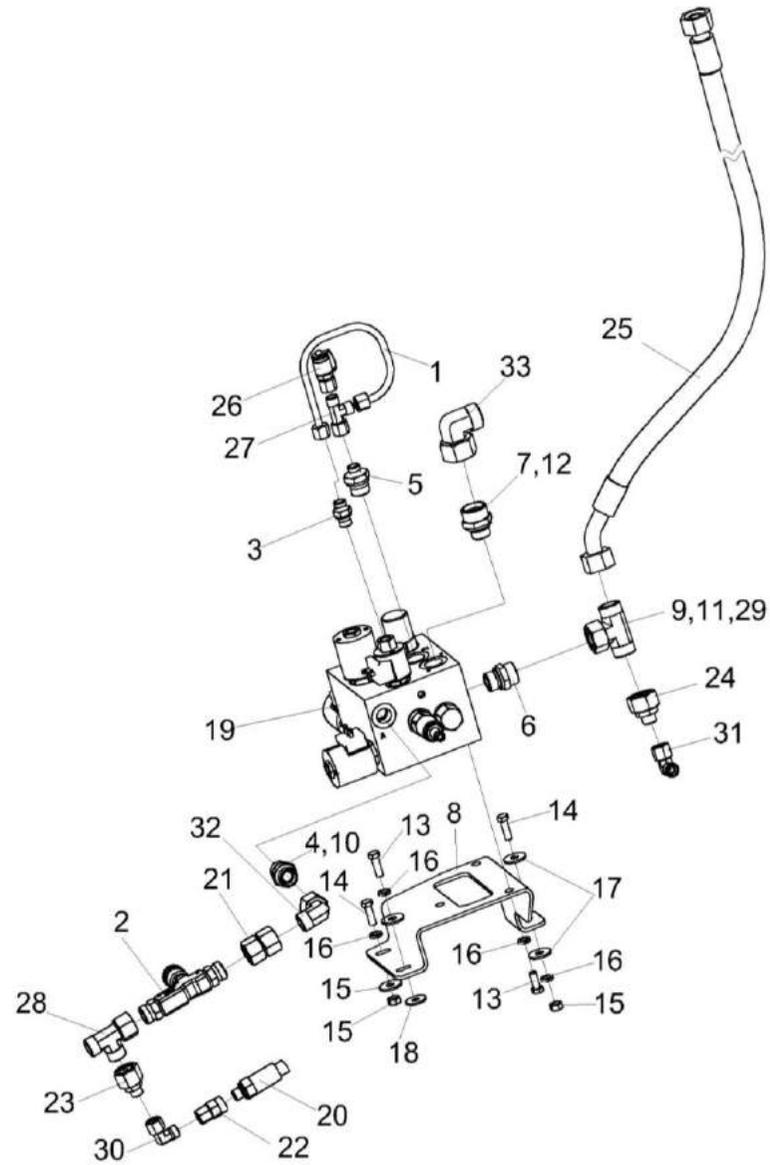
Рисунок 263– Гидроблок навески КЗК-16-1-0602370
