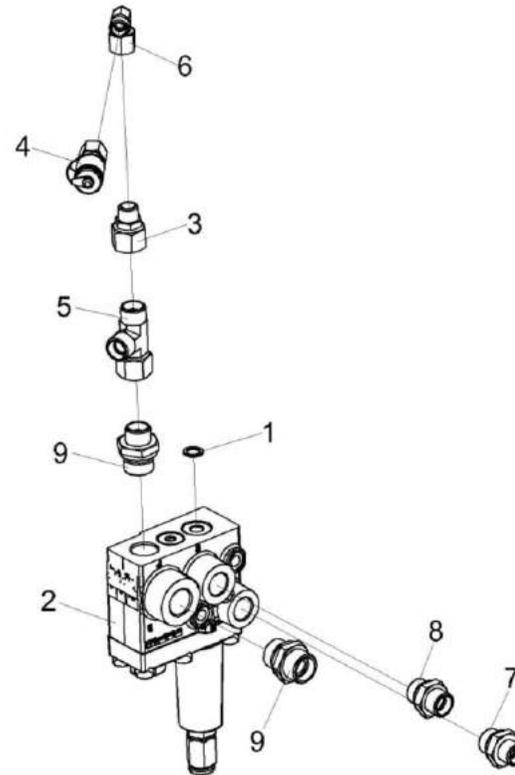
Рисунок 281 – Клапан зарядки пневмогидроаккумулятора КЗК-16-1-0606390
