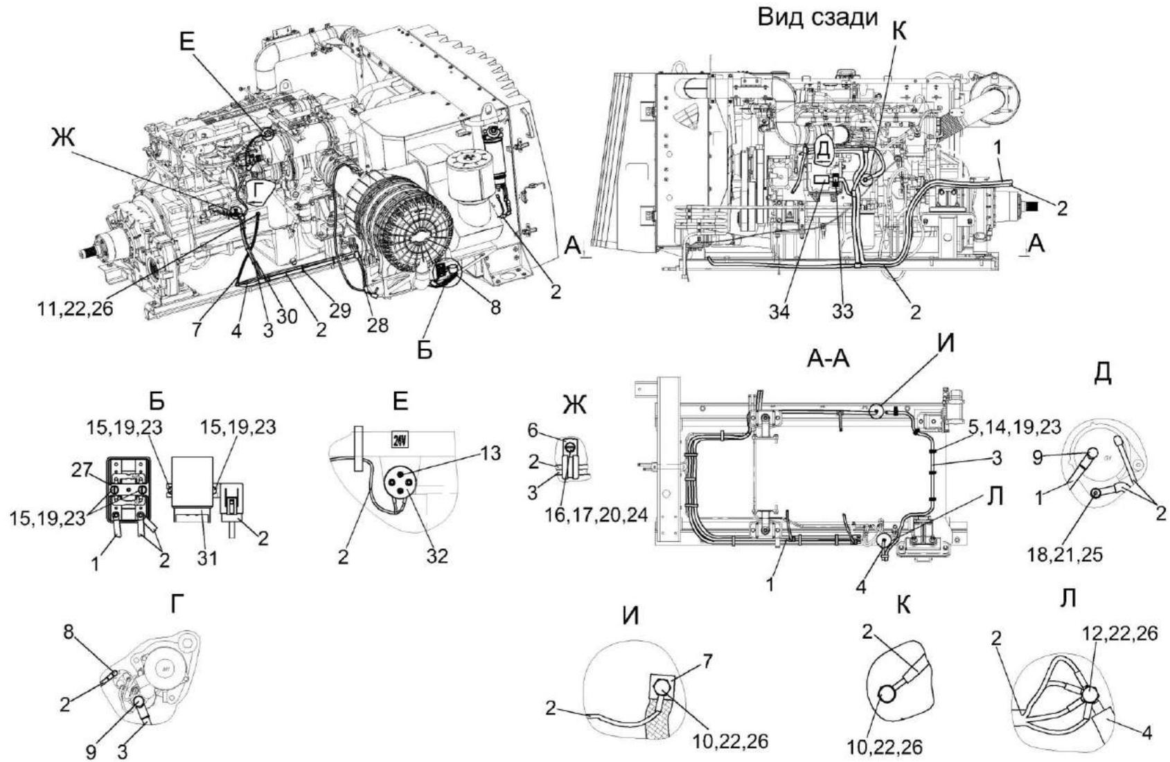
Рисунок 140 – Установка электрооборудования моторной установки КЗК-16-6-0726000
