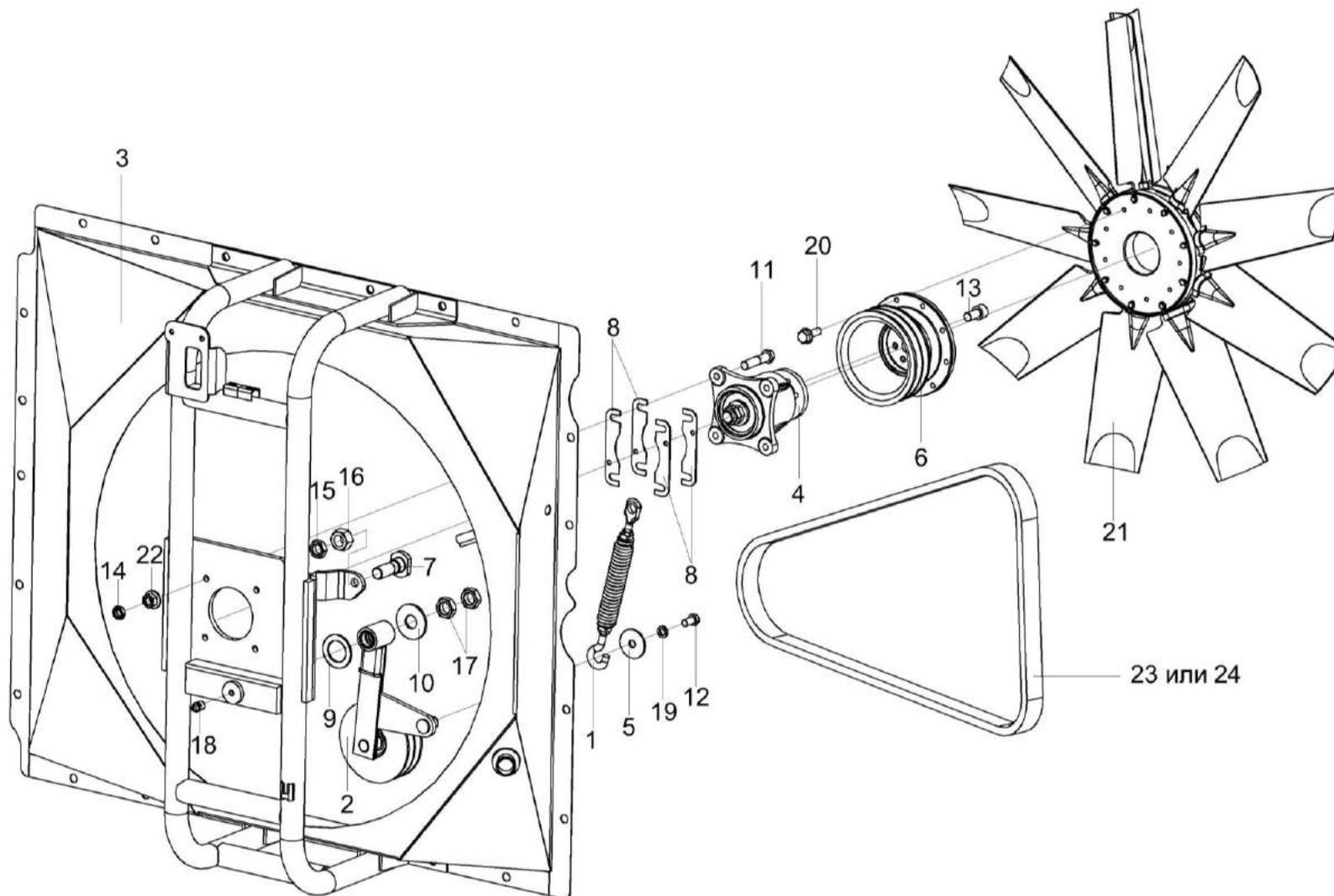
Рисунок 126 – Установка вентилятора КЗК-16-6-0106400
