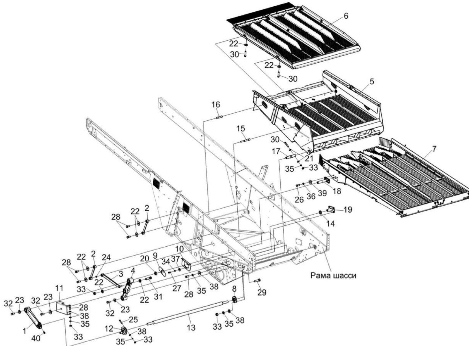
Рисунок 9 – Очистка. Установка стана решётного верхнего КЗК-14-0260000А (лист 2)
