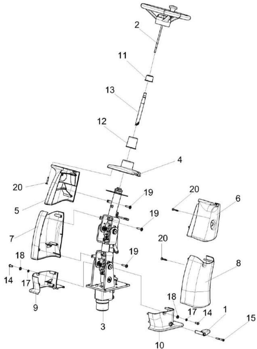
Рисунок 197 – Колонка рулевая КЗК-16-6-0119230
