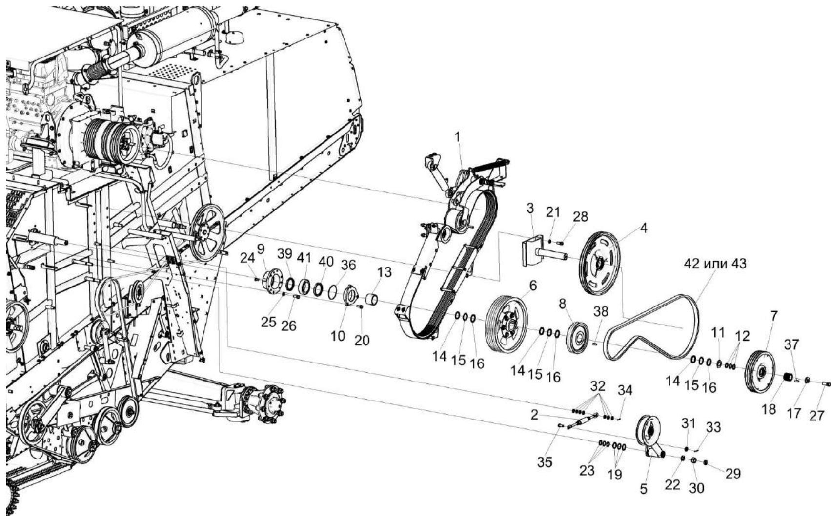
Рисунок 5 – Очистка. Установка привода главного контрпривода КЗК-2124-0220000
