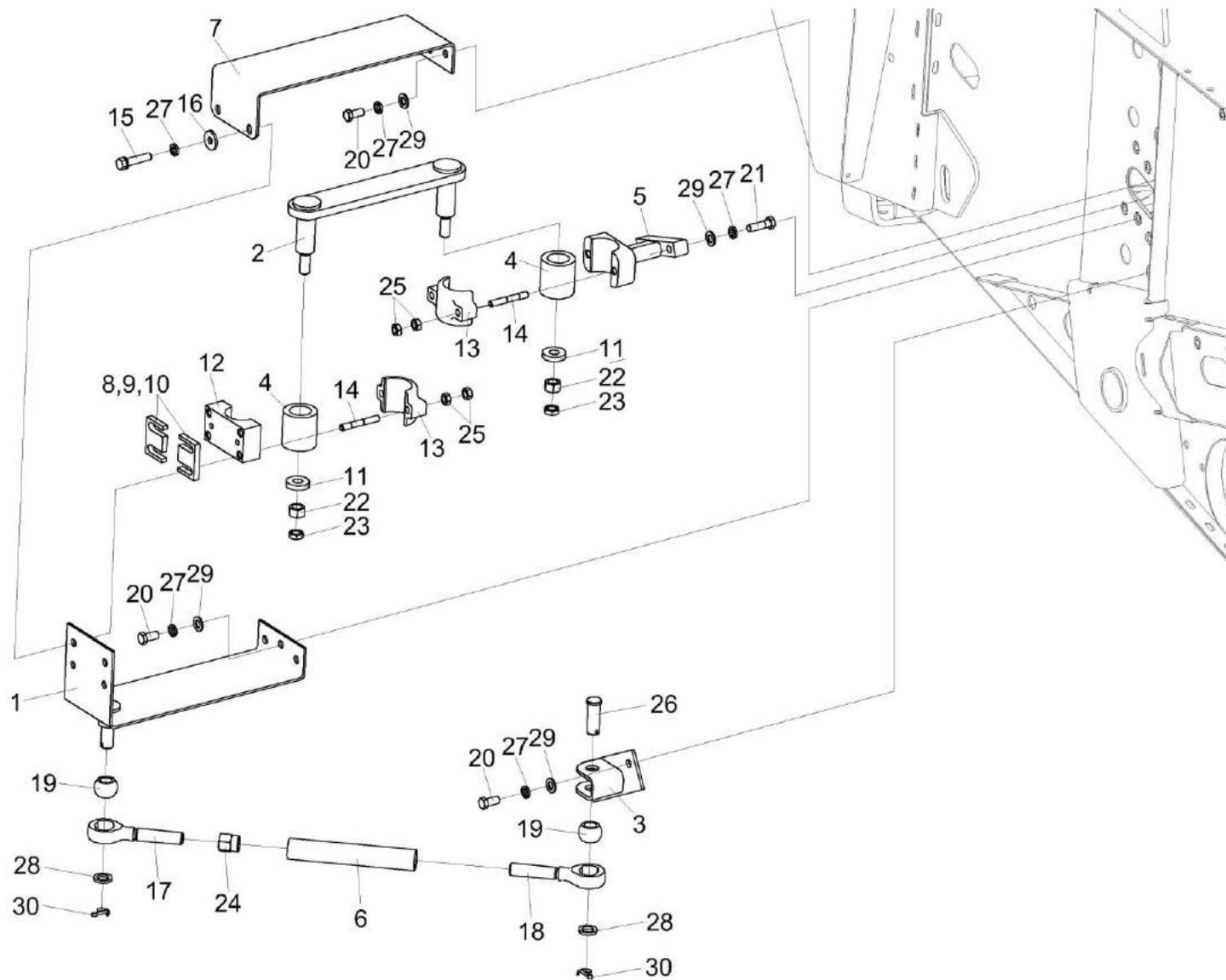
Рисунок 21 – Установка механизма удерживания КЗК-16-1-0202210
