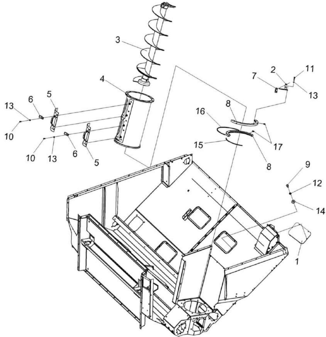
Рисунок 146 – Бункер. Установка шнека вертикального КЗК-14-0206650Б
