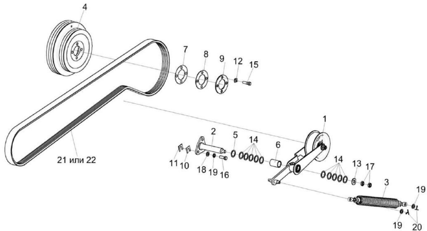
Рисунок 61 – Установка привода соломосепаратора КЗК-16-1-0212100
