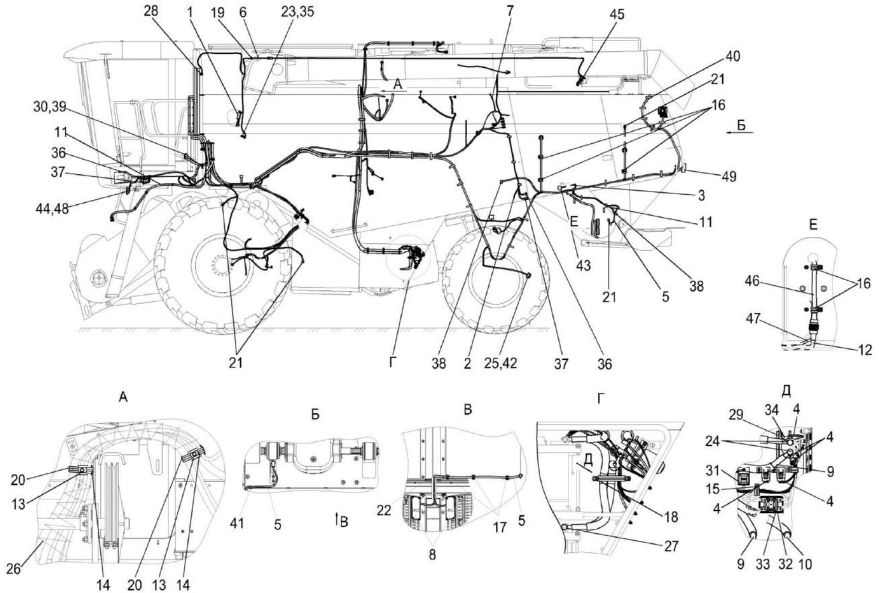
Рисунок 305 – Установка электрооборудования молотилки КЗК-16-6-0721000 (лист 4)
