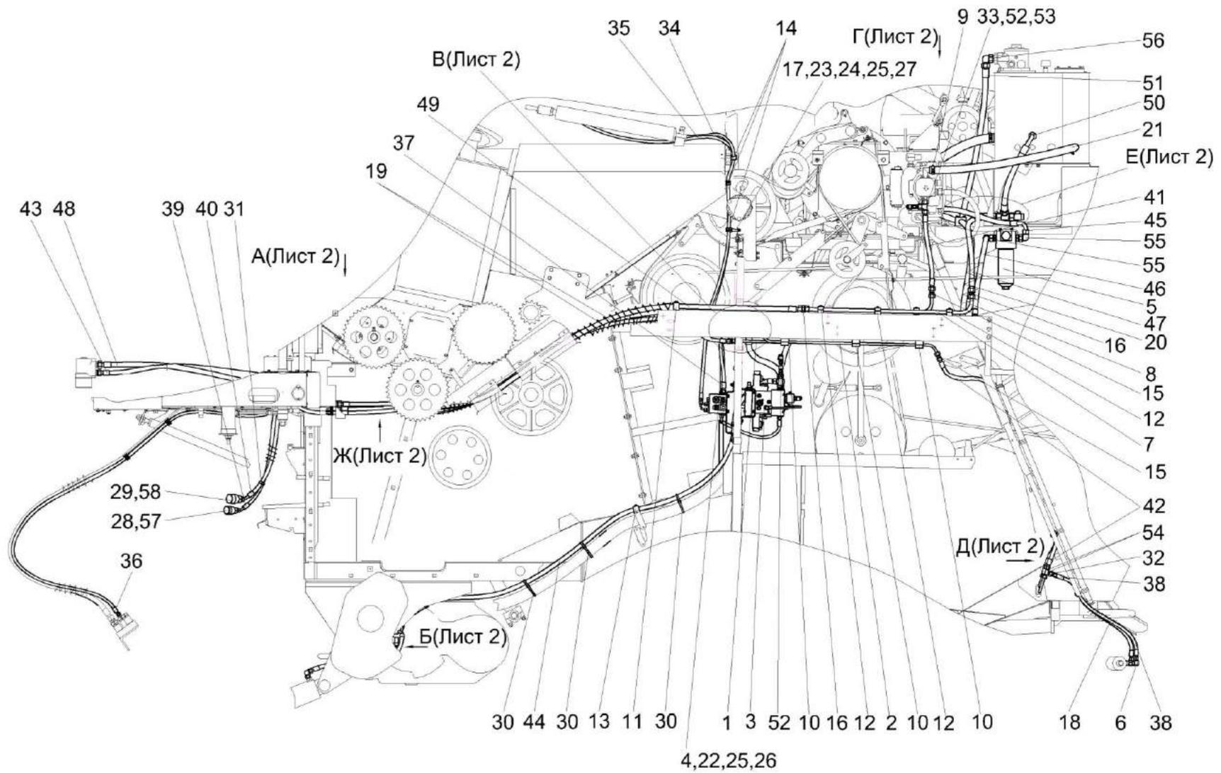
Рисунок 258— Гидросистема рулевого управления и силовых гидроцилиндров комбайна КЗС-1624-1 КЗК-16-1-0602000 (лист 1)
