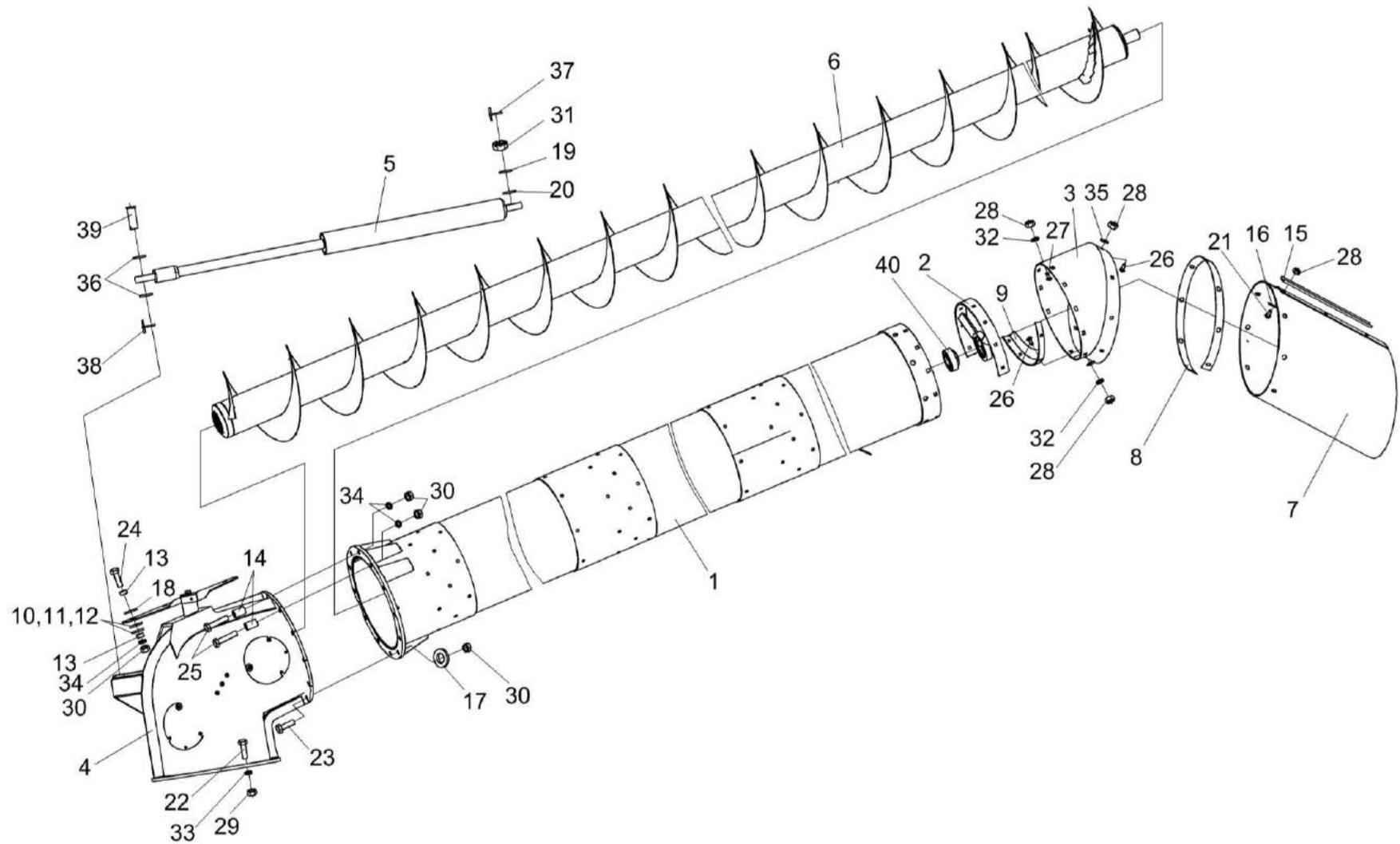
Рисунок 160 – Установка системы выгрузки КЗК-1420-0206000
