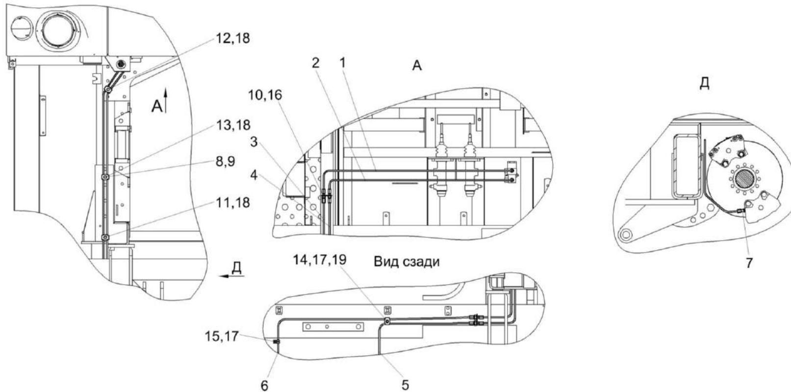
Рисунок 214 – Установка тормозных трубопроводов КЗК-1420-0119100А
