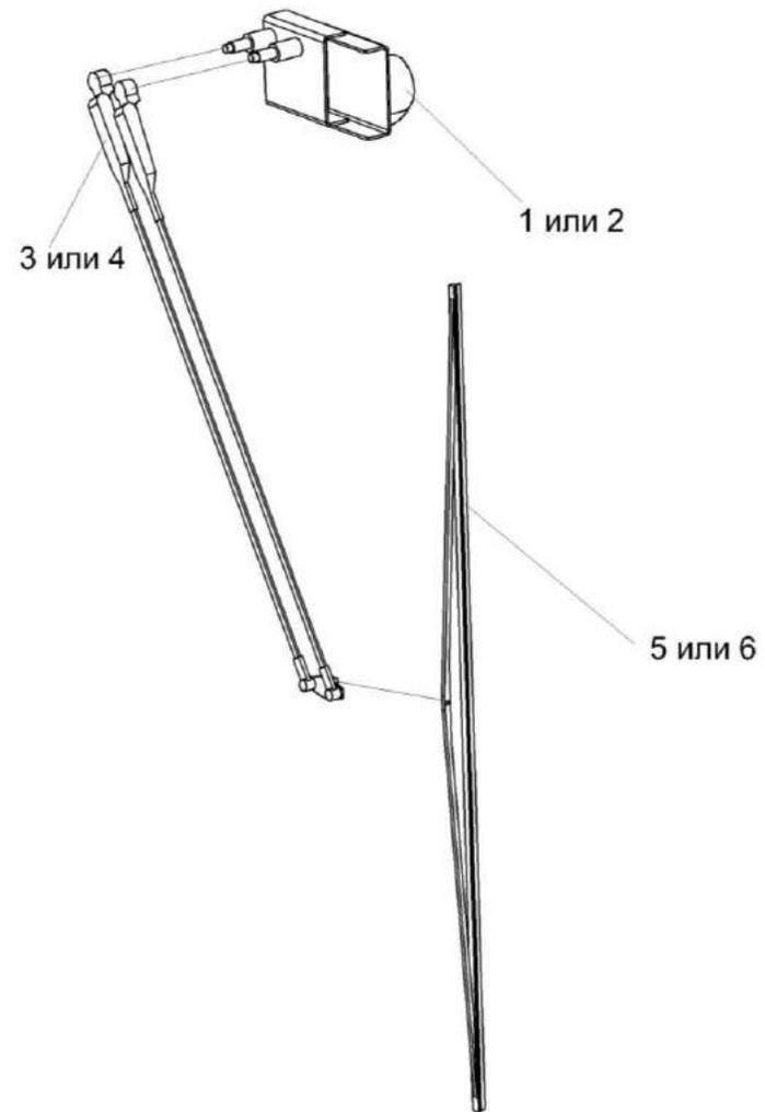
Рисунок 210 – Установка стеклоочистителя КЗК-12-0120810 или КЗК-12-0120810-01
