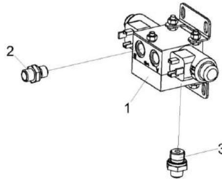
Рисунок 255 – Гидроблок доворота вала мотора ГСТ УЭС-16-0601060
