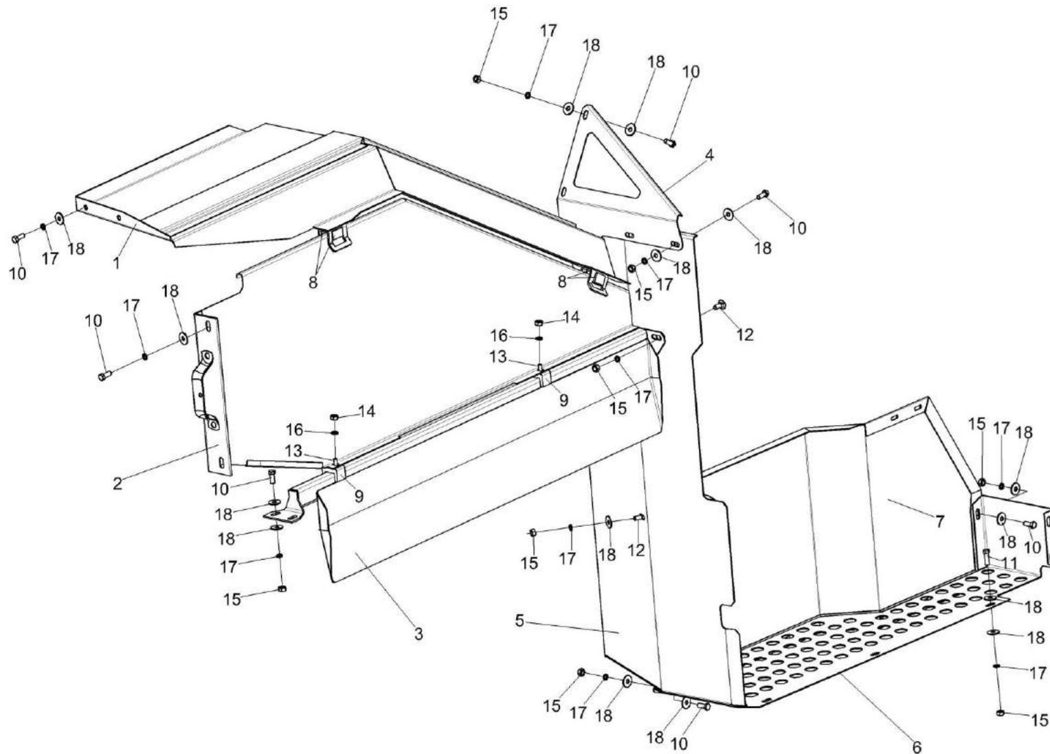
Рисунок 232 – Установка ограждения КЗК-1420-0100100
