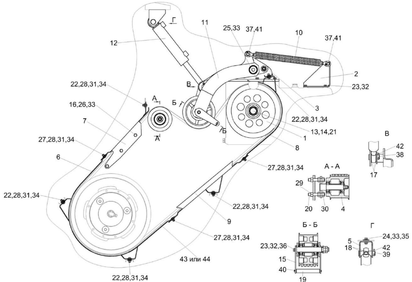
Рисунок 45 – Привод главного контрпривода КЗК-2124-0220000
