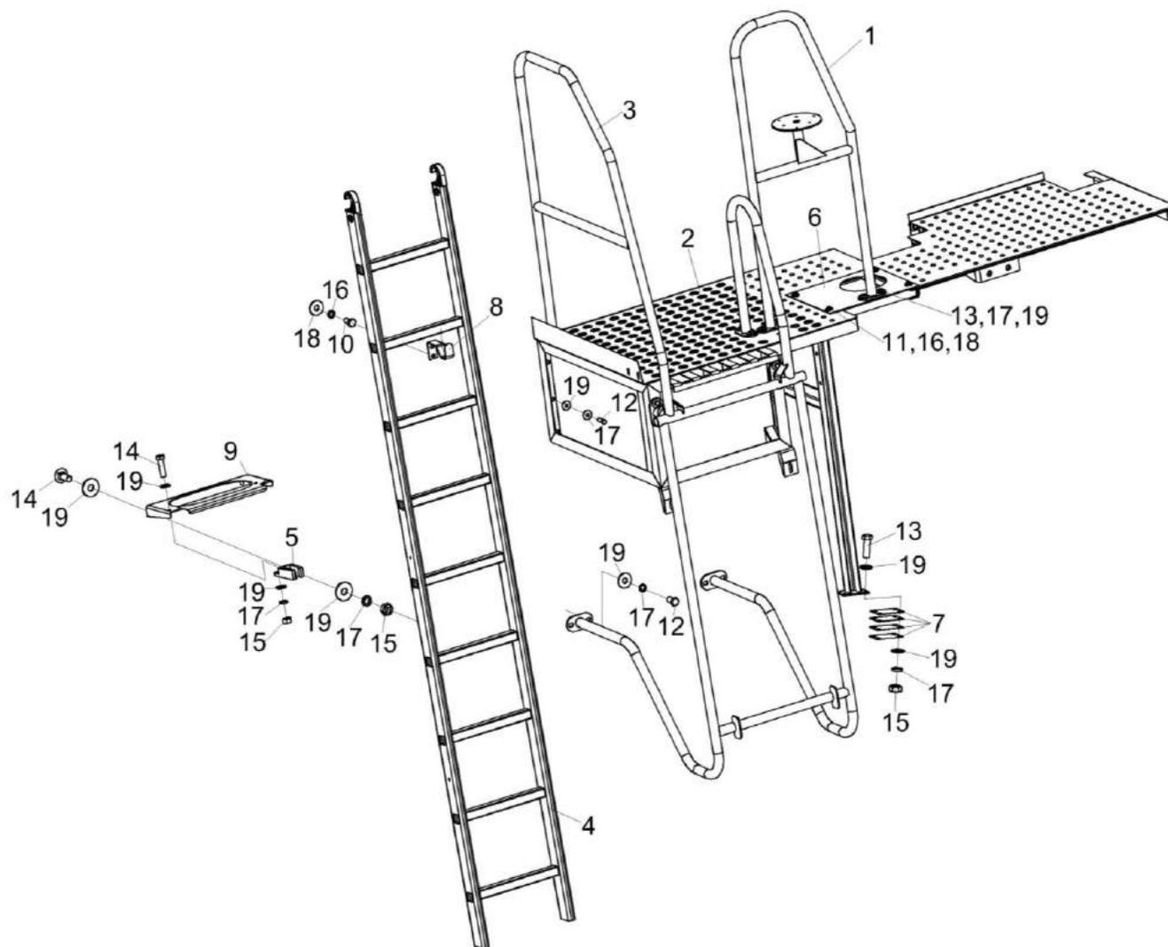
Рисунок 240 – Установка площадки обслуживания моторной установки КЗК-2124-0131000
