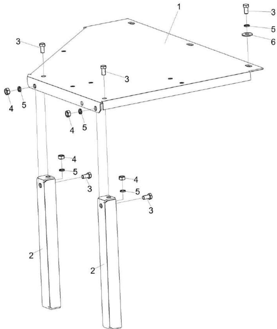
Рисунок 230 – Установка ступеньки КЗК-16-6-0100200
