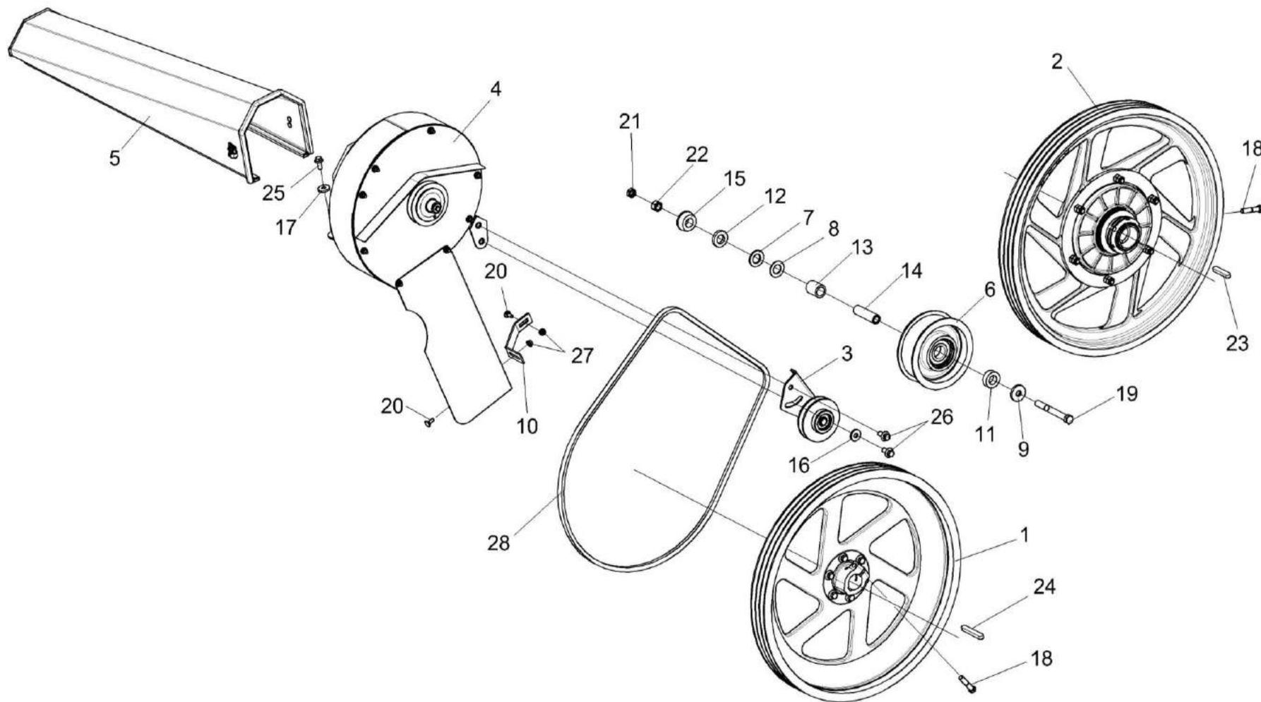
Рисунок 18 – Установка привода и вентилятора КЗК-1420-1819000
