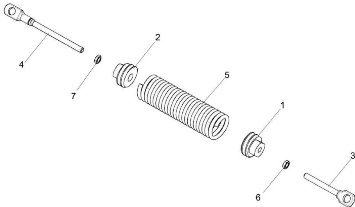
Рисунок 92 – Пружина КЗК-14-0134080
