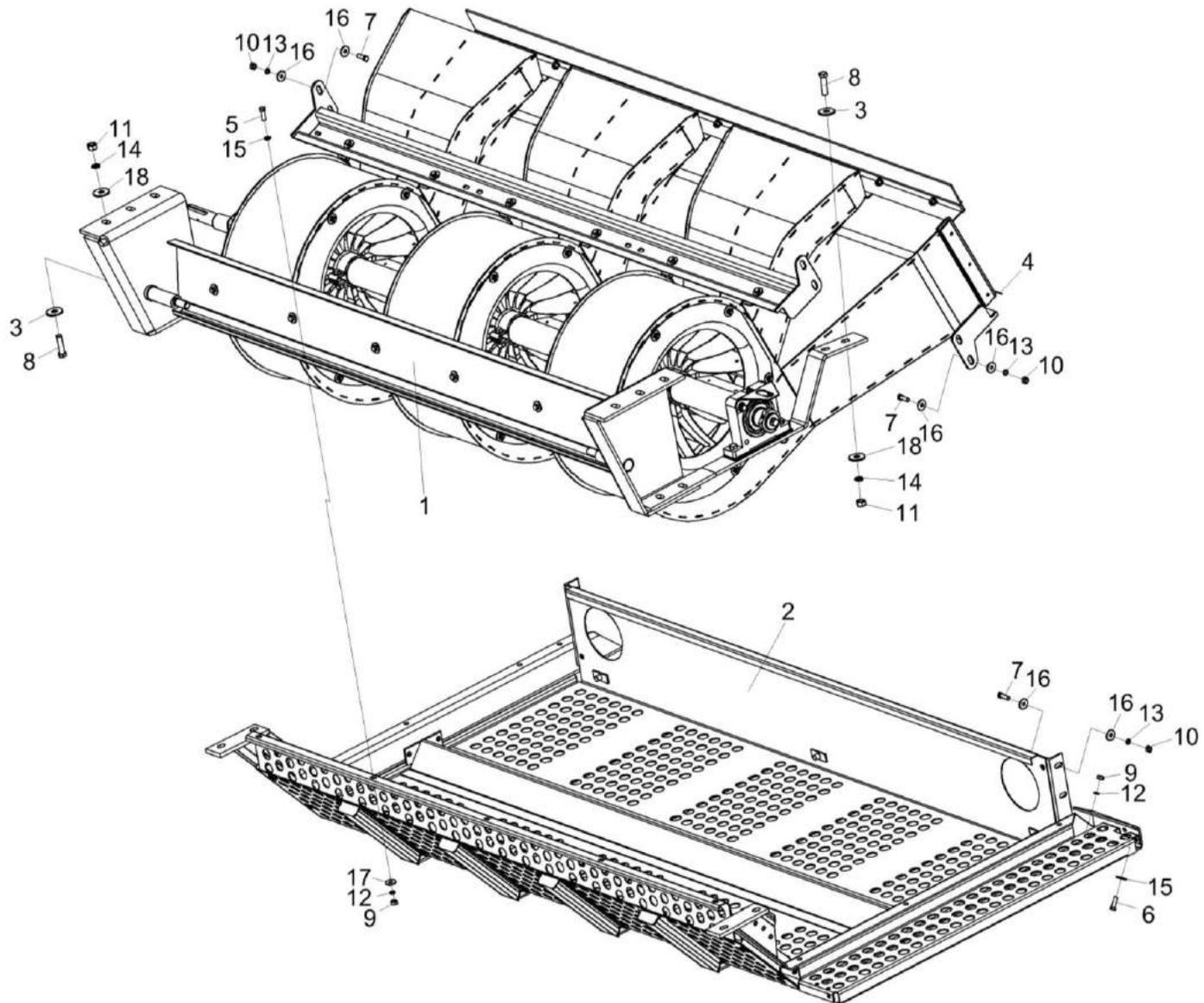
Рисунок 113 – Установка вентилятора очистки КЗК-1420-0217500
