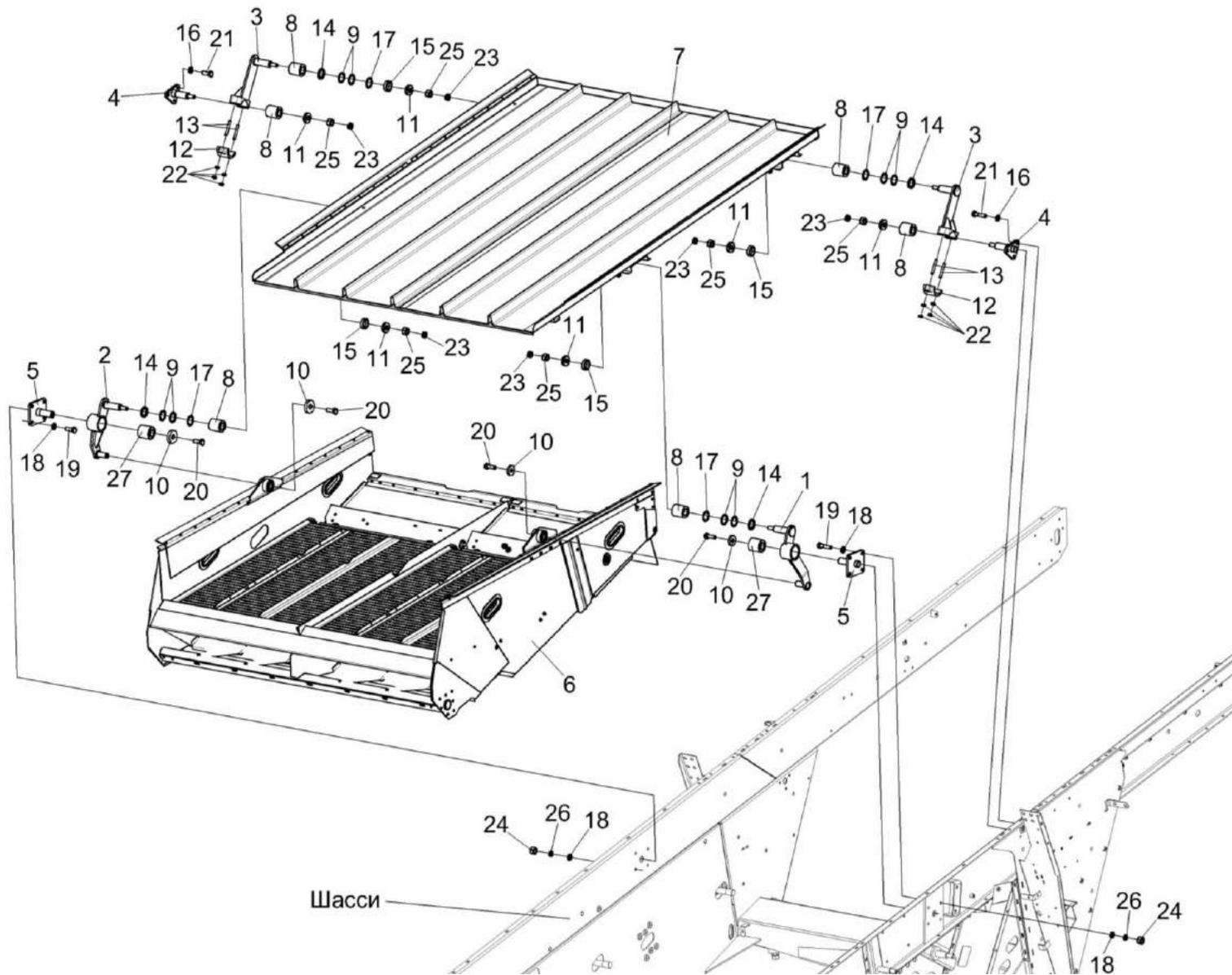
Рисунок 11 – Очистка. Установка стана решетчатого нижнего КЗК-14-0240000А
