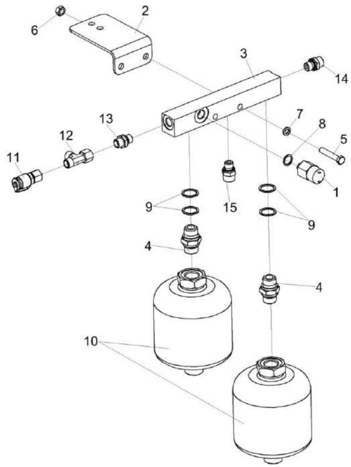
Рисунок 280 – Блок пневмогидроаккумуляторов КЗК-1420-0606370
