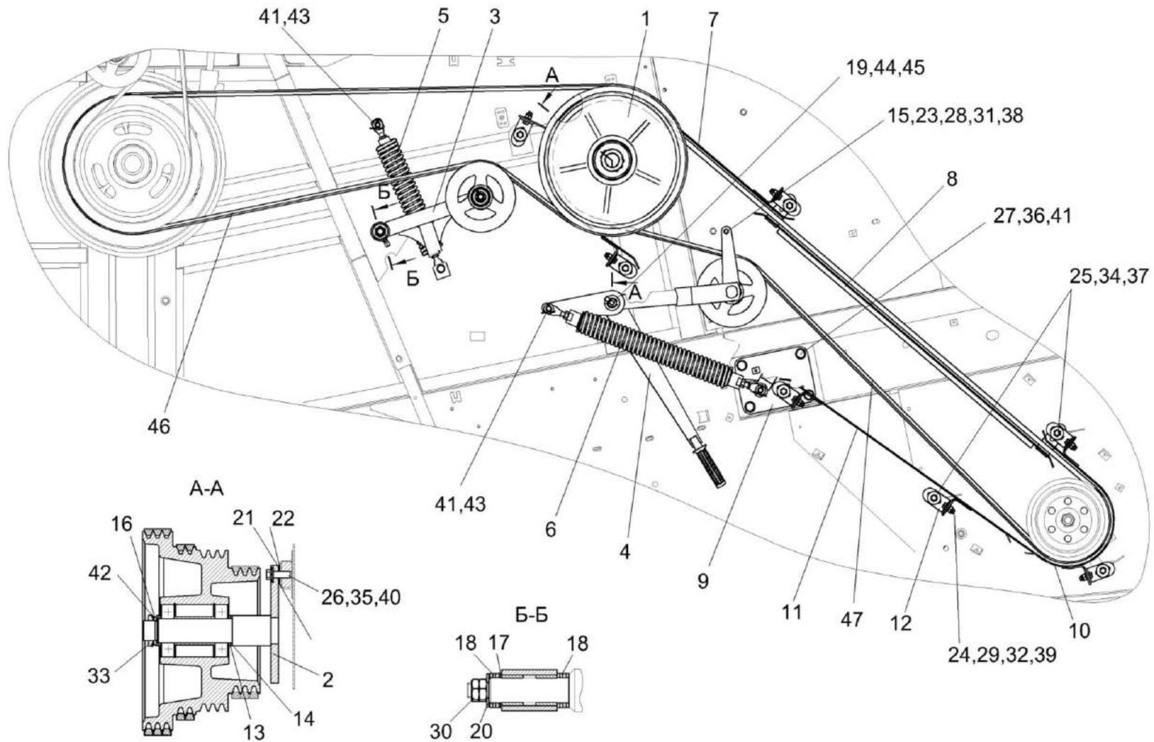
Рисунок 179 – Установка привода соломоизмельчителя КЗК-14-0290400В
