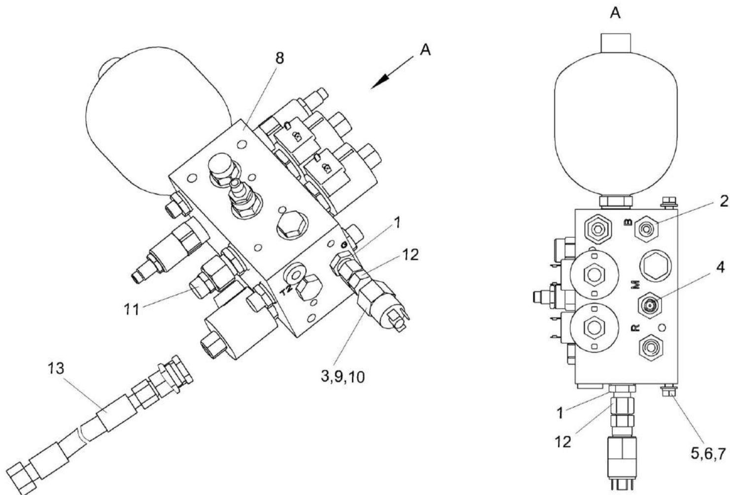
Рисунок 13 – Гидроблок поперечного копирования и реверса наклонной камеры КЗК-1420-0679340
