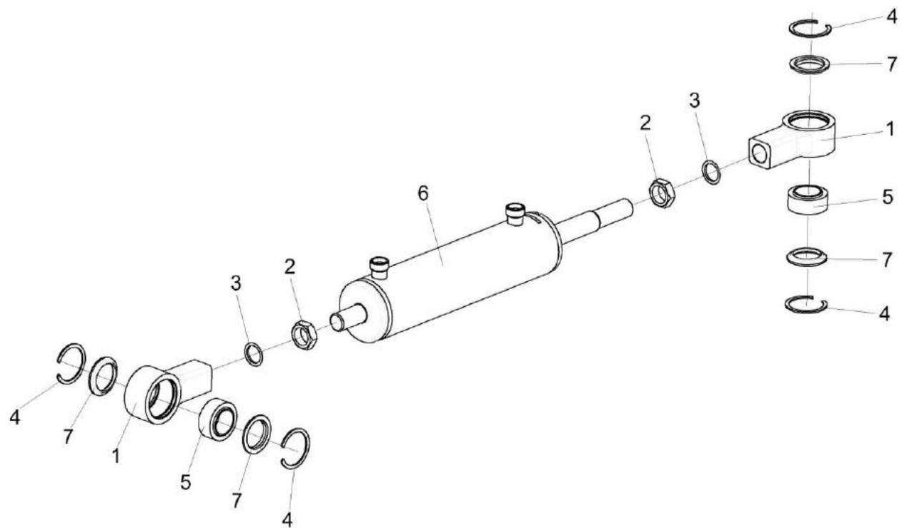
Рисунок 112 – Гидроцилиндр УЭС-7-0109200
