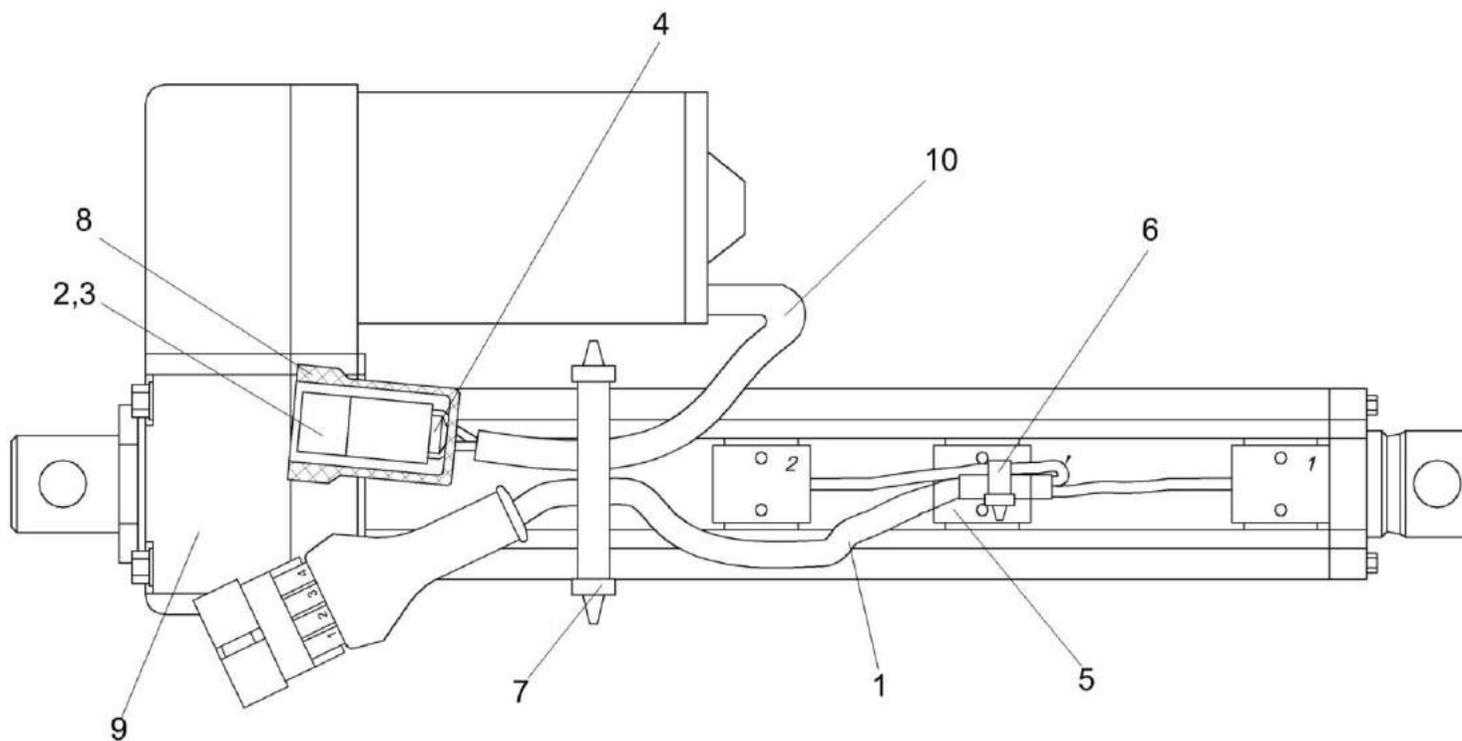
Рисунок 156 – Электромеханизм бункера КЗК-1420-0701090
