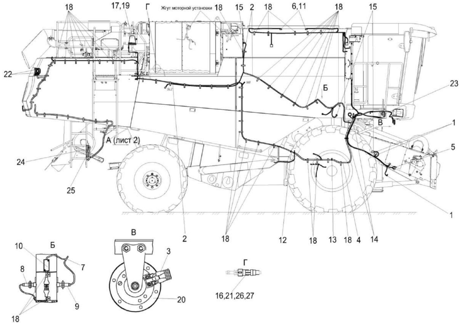
Рисунок 304 – Установка электрооборудования молотилки КЗК-16-6-0721000 (лист 3)
