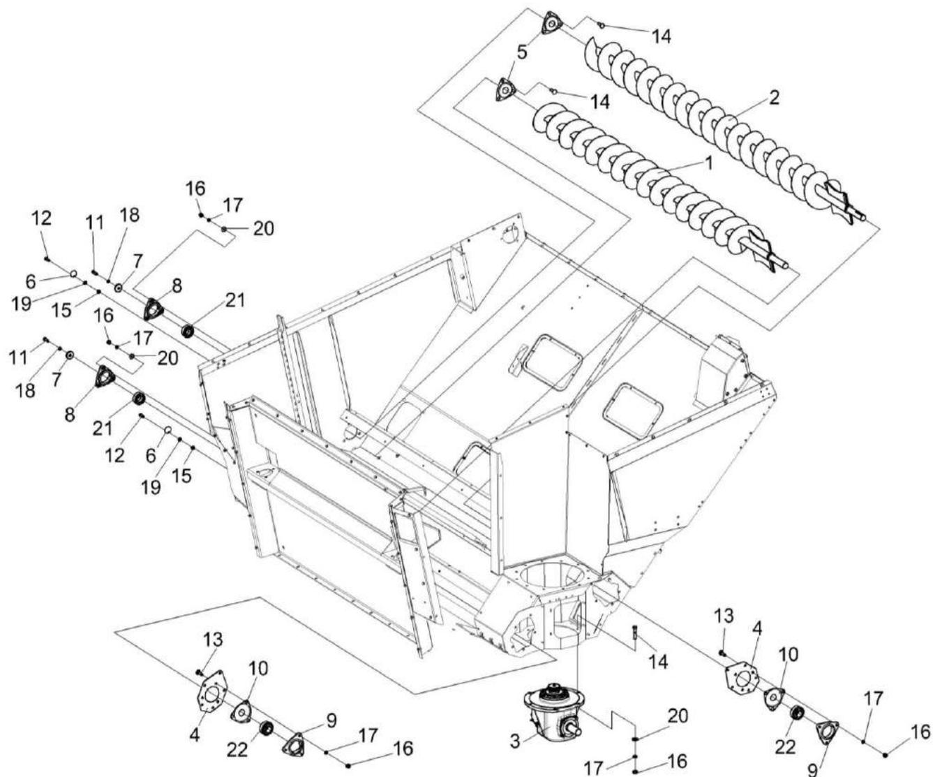
Рисунок 145 – Бункер. Установка шнеков горизонтальных КЗК-14-0206060А и КЗК-14-0206070А
