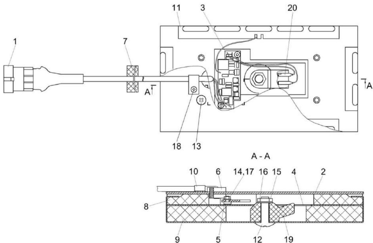
Рисунок 314 – Датчик потерь соломотряса КЗК-1420-0701640
