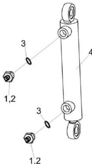
Рисунок 169 – Гидроцилиндр выгрузки зернового бункера КЗК-1420-0609510
