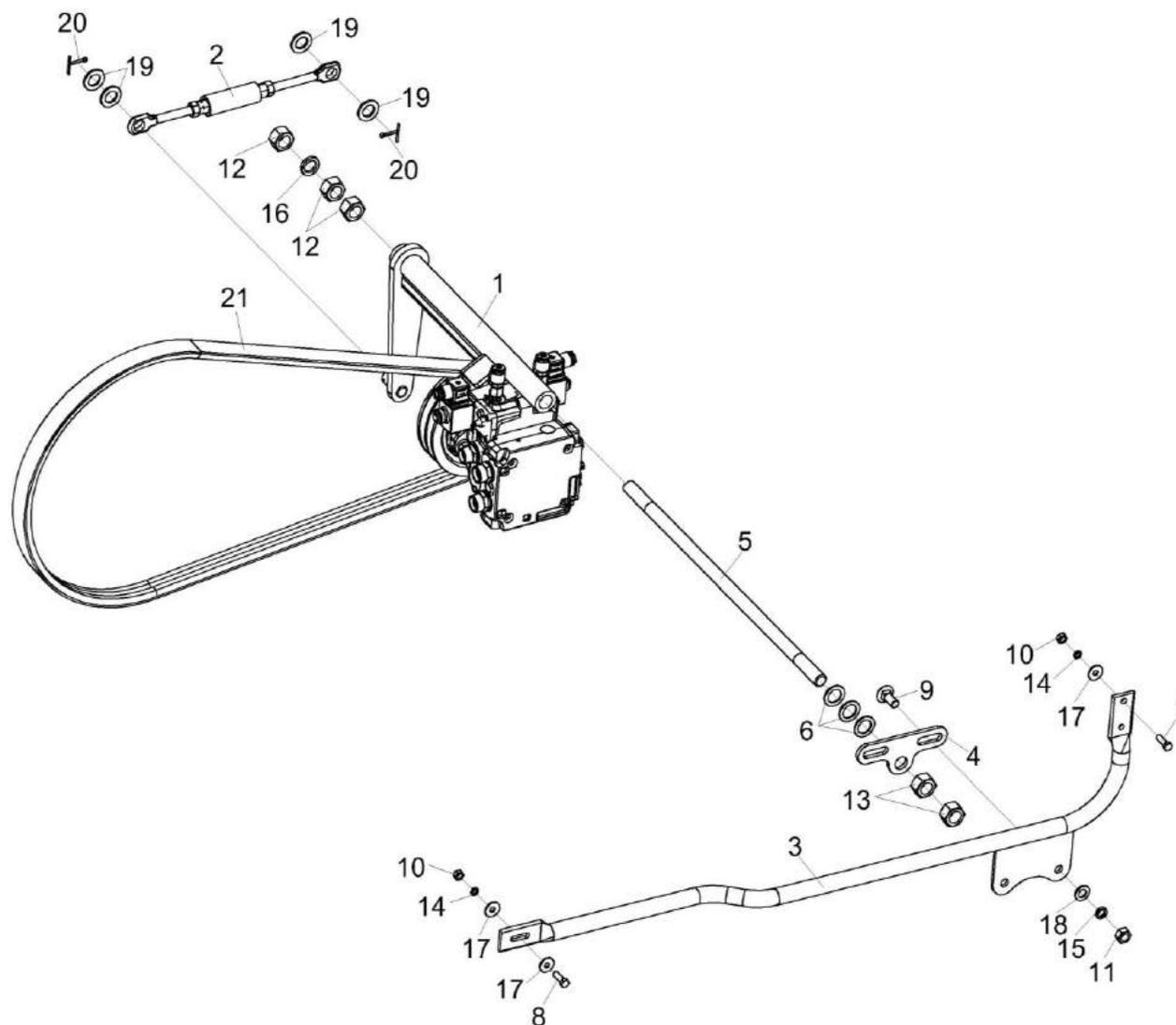
Рисунок 289– Установка привода гидронасоса мотвила КЗК-14-0127000Б
