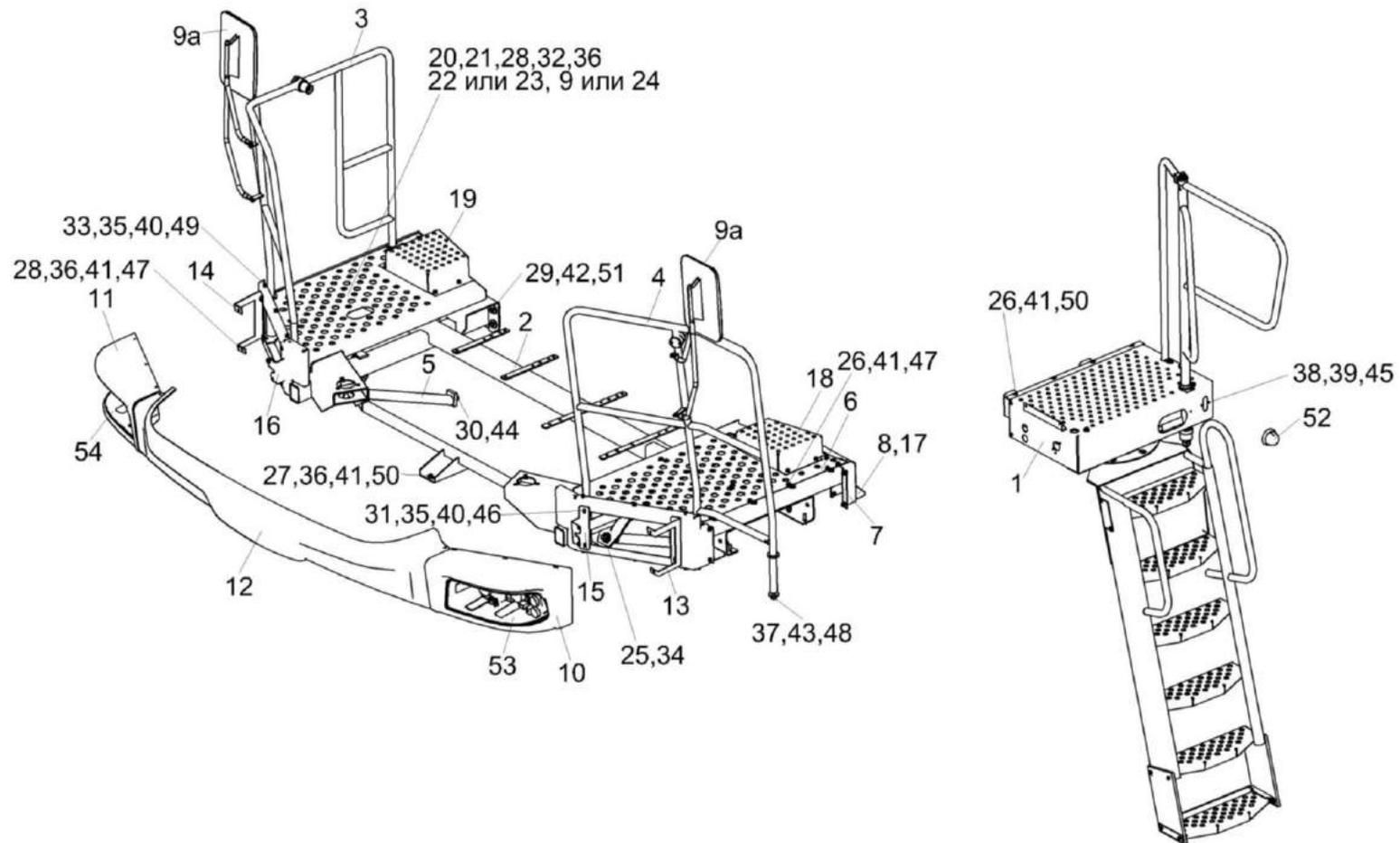
Рисунок 224 – Установка подрамника кабины КЗК-16-6-0133000
