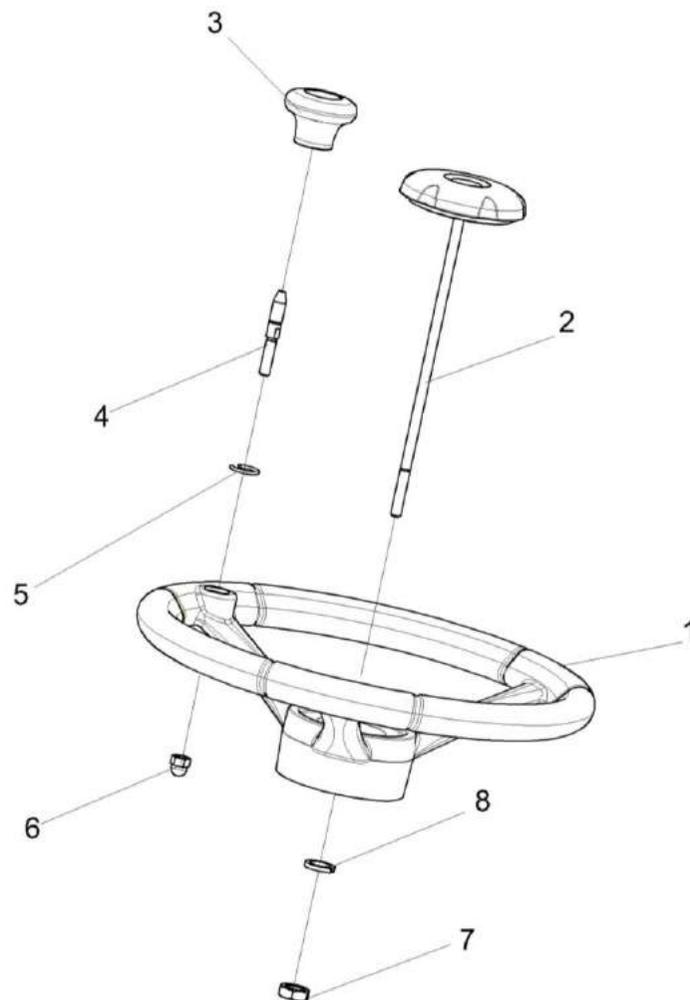
Рисунок 203 – Установка колеса рулевого КЗК-12-0122600-02
