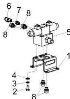
Рисунок 274 – Гидроблок вентилятора КЗК-16-1-0604320
