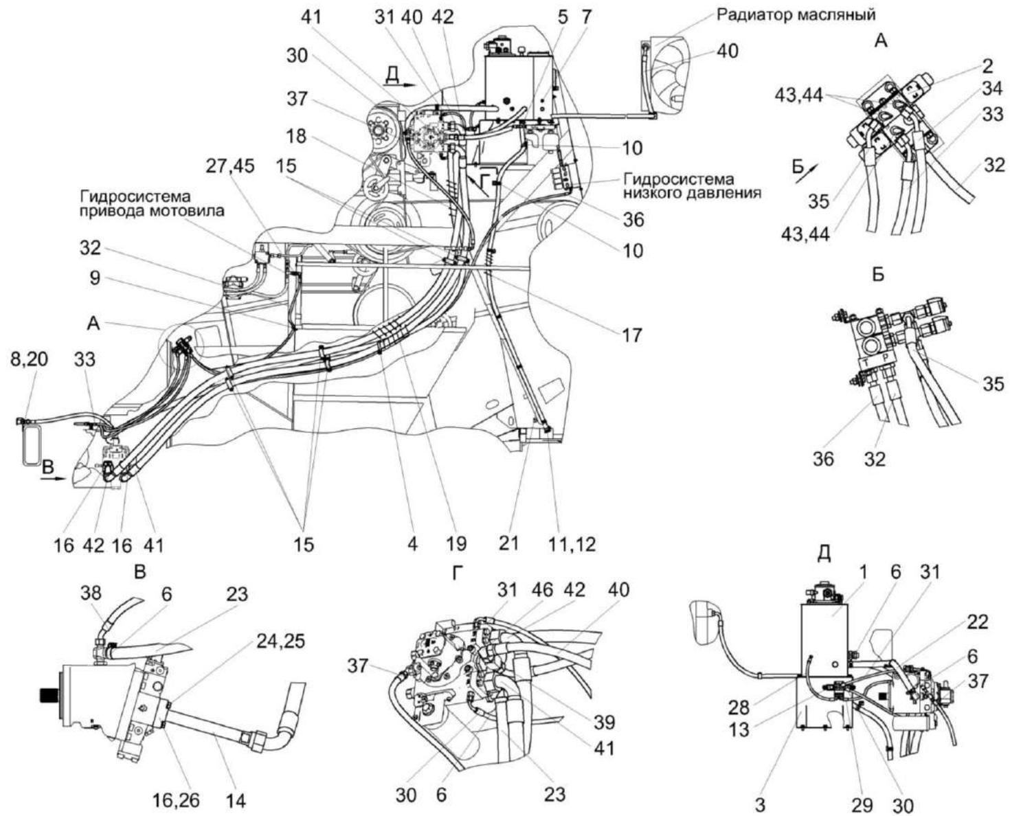
Рисунок 249 – Гидросистема привода ходовой части комбайна КЗС-1624-1 КЗК-16-1-0611000 (лист 1)
