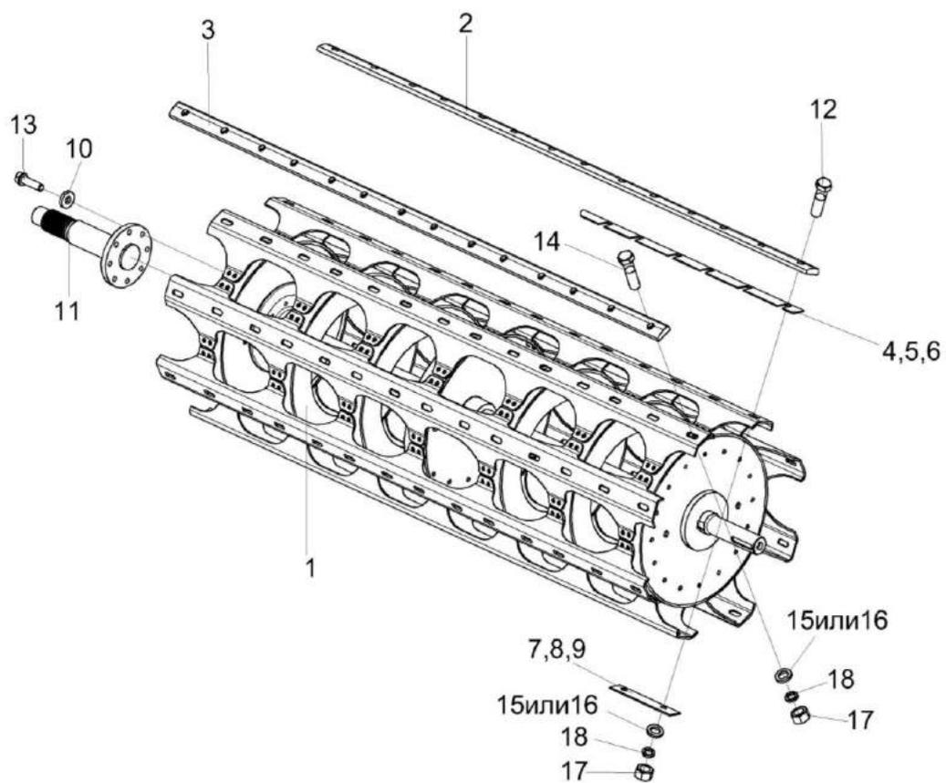
Рисунок 88 – Барабан молотильный КЗК-14-0104010
