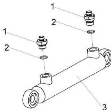
Рисунок 187 – Гидроцилиндр КЗК-1420-0609510
