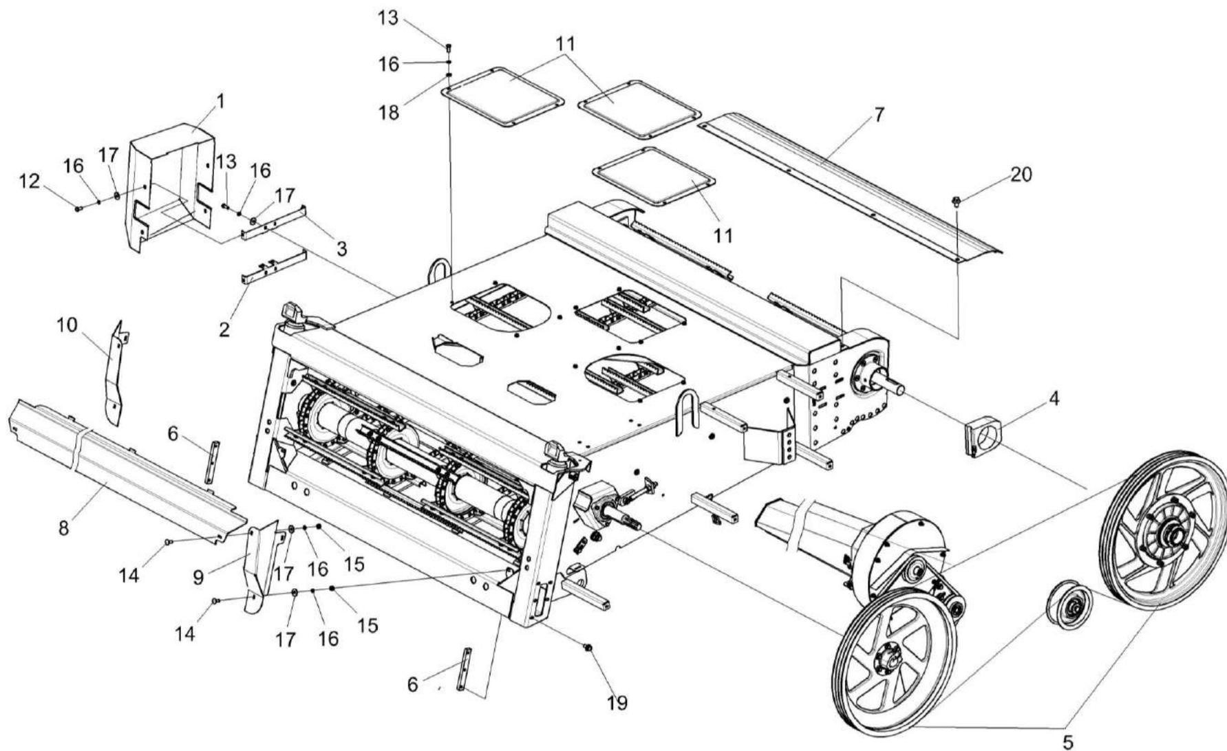
Рисунок 6 – Камера наклонная КЗК-1420-1810010 (лист 2)
