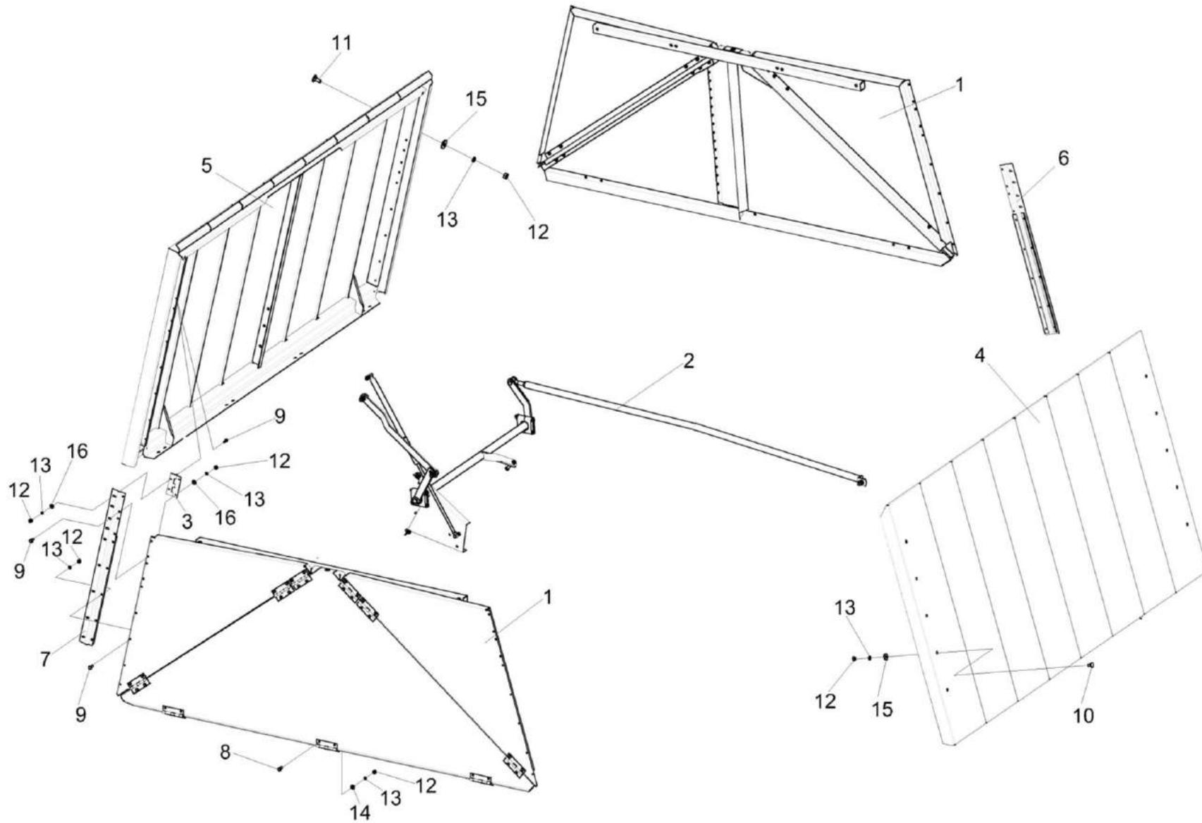
Рисунок 153 – Установка крыши бункера КЗК-14-0204000Б
