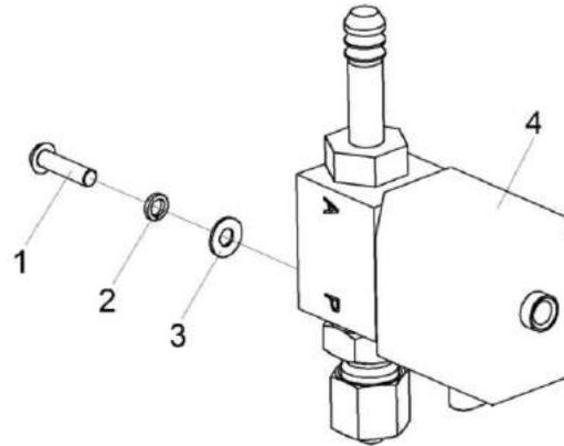
Рисунок 299 – Клапан электромагнитный КЗК-2124-0800180
