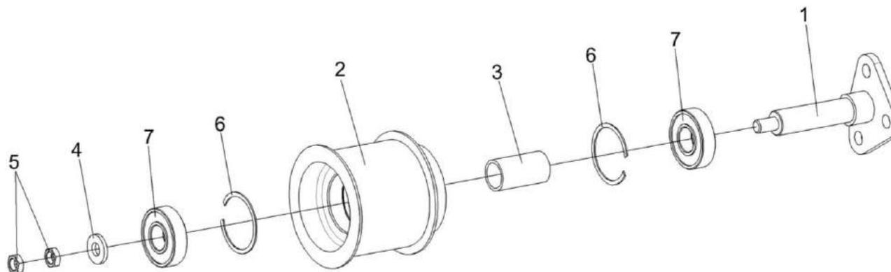
Рисунок 47 – Ролик обводной КЗК-16-1-0220060
