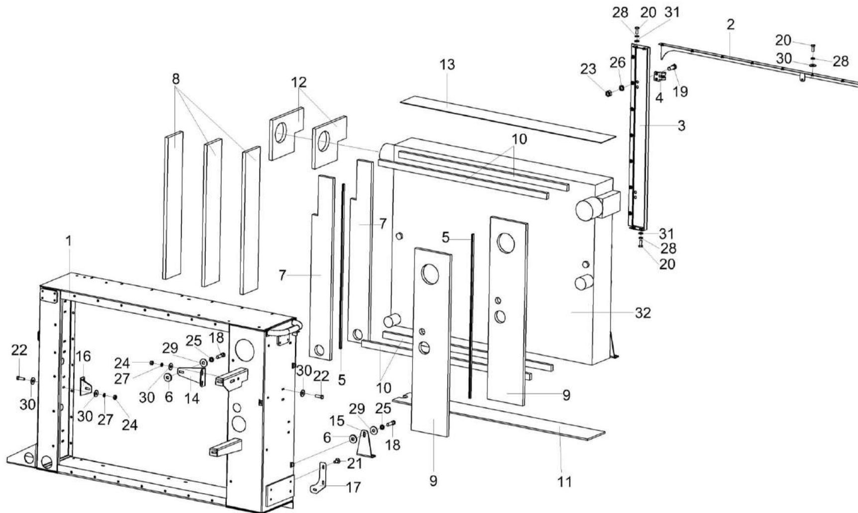
Рисунок 125 – Установка радиатора КЗК-16-6-0106050
