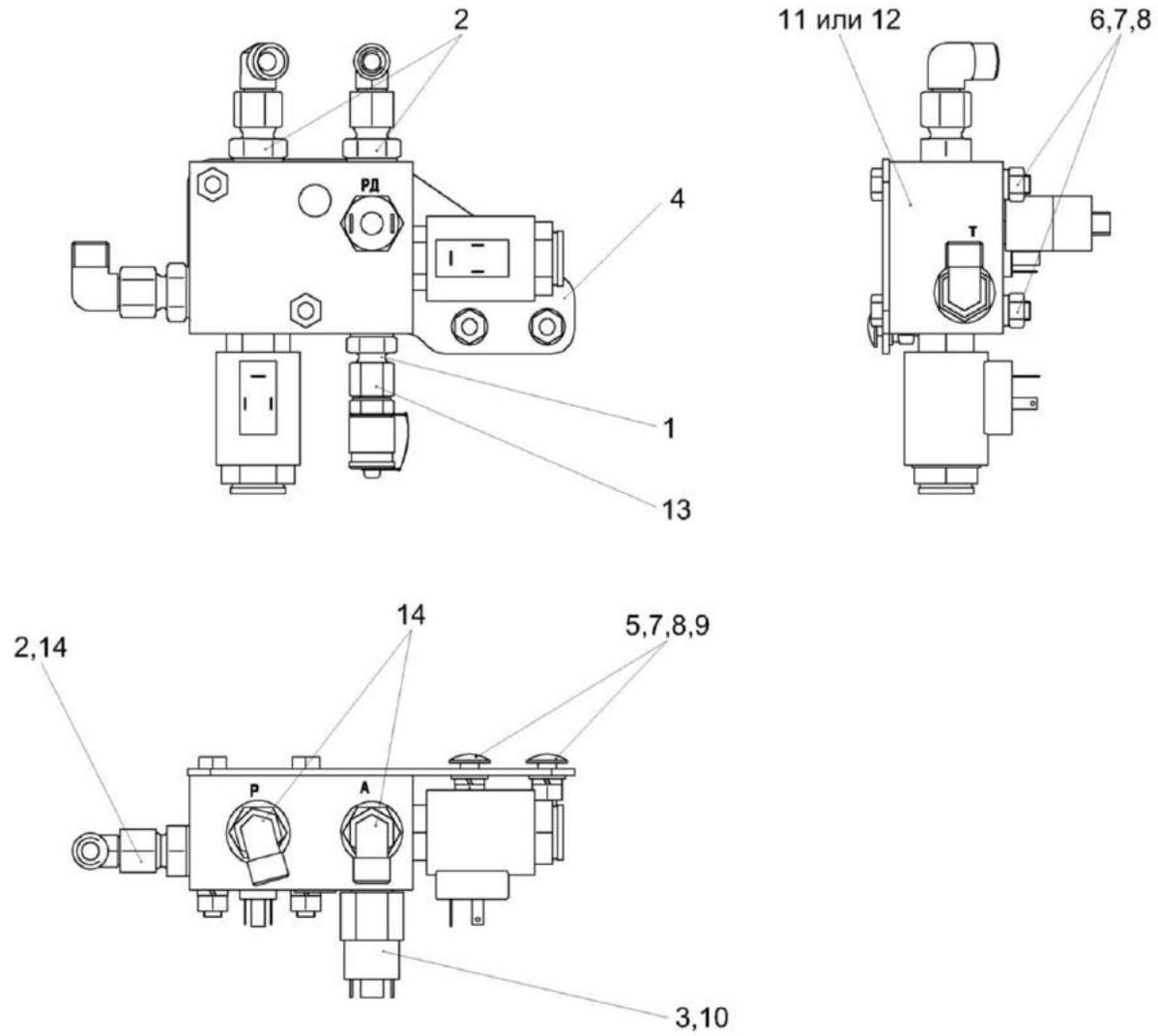
Рисунок 282 – Гидроблок стояночного тормоза КЗК-13-0606420
