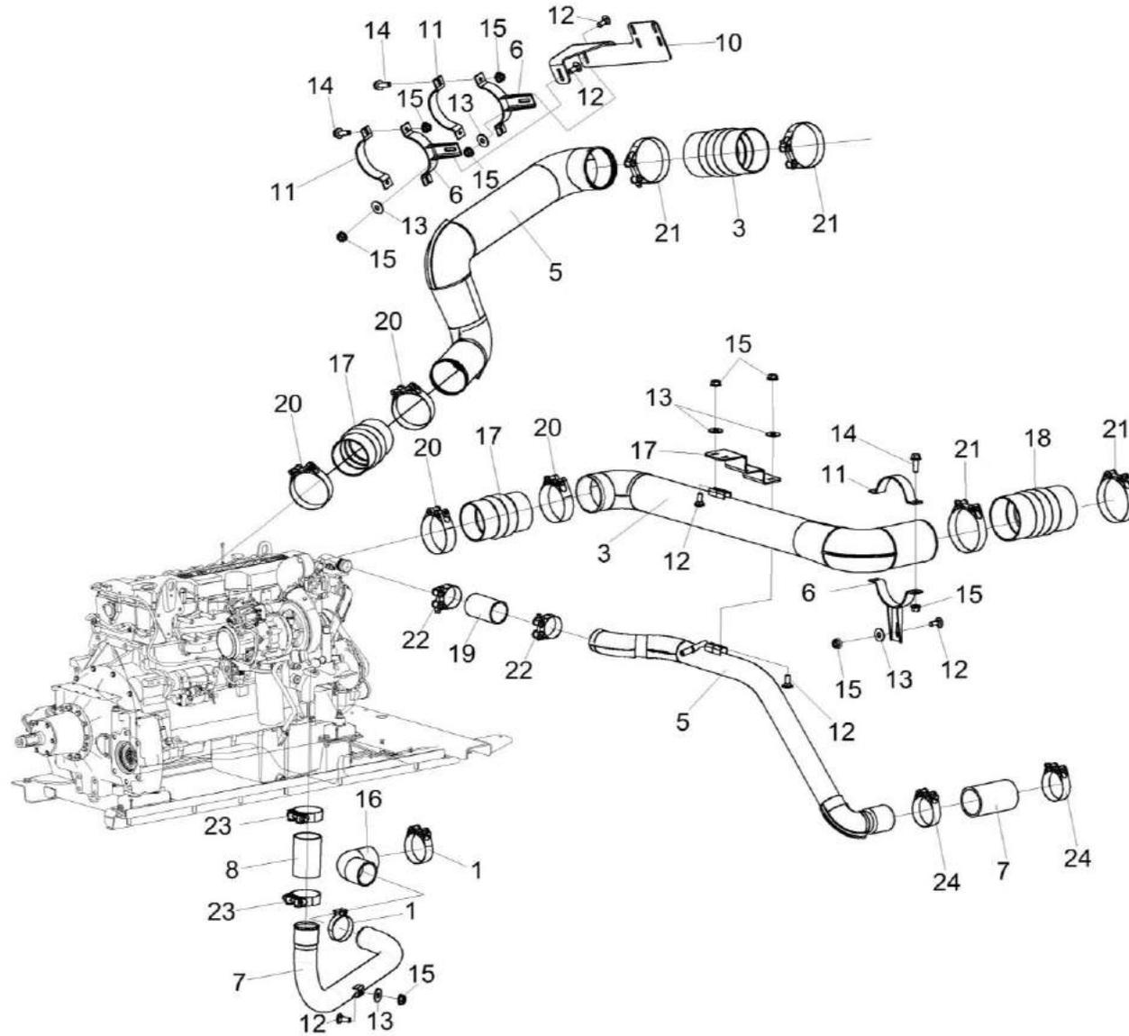
Рисунок 136 – Установка труб КЗК-16-6-0106200
