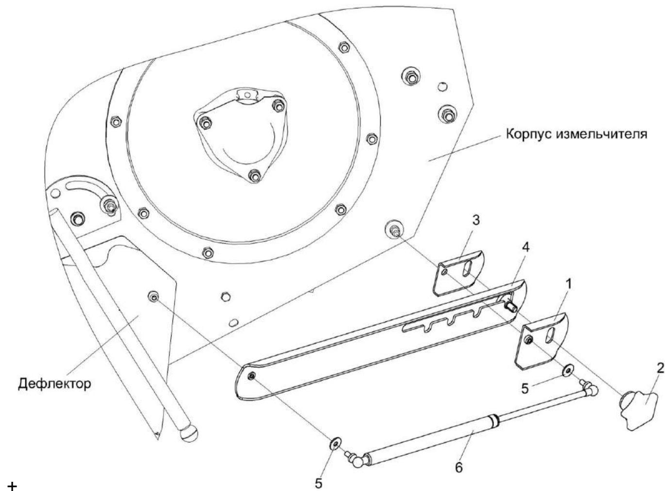
Рисунок 178 – Установка газовых пружин КЗК-1420-0290080 и КЗК-1420-0290080-01
