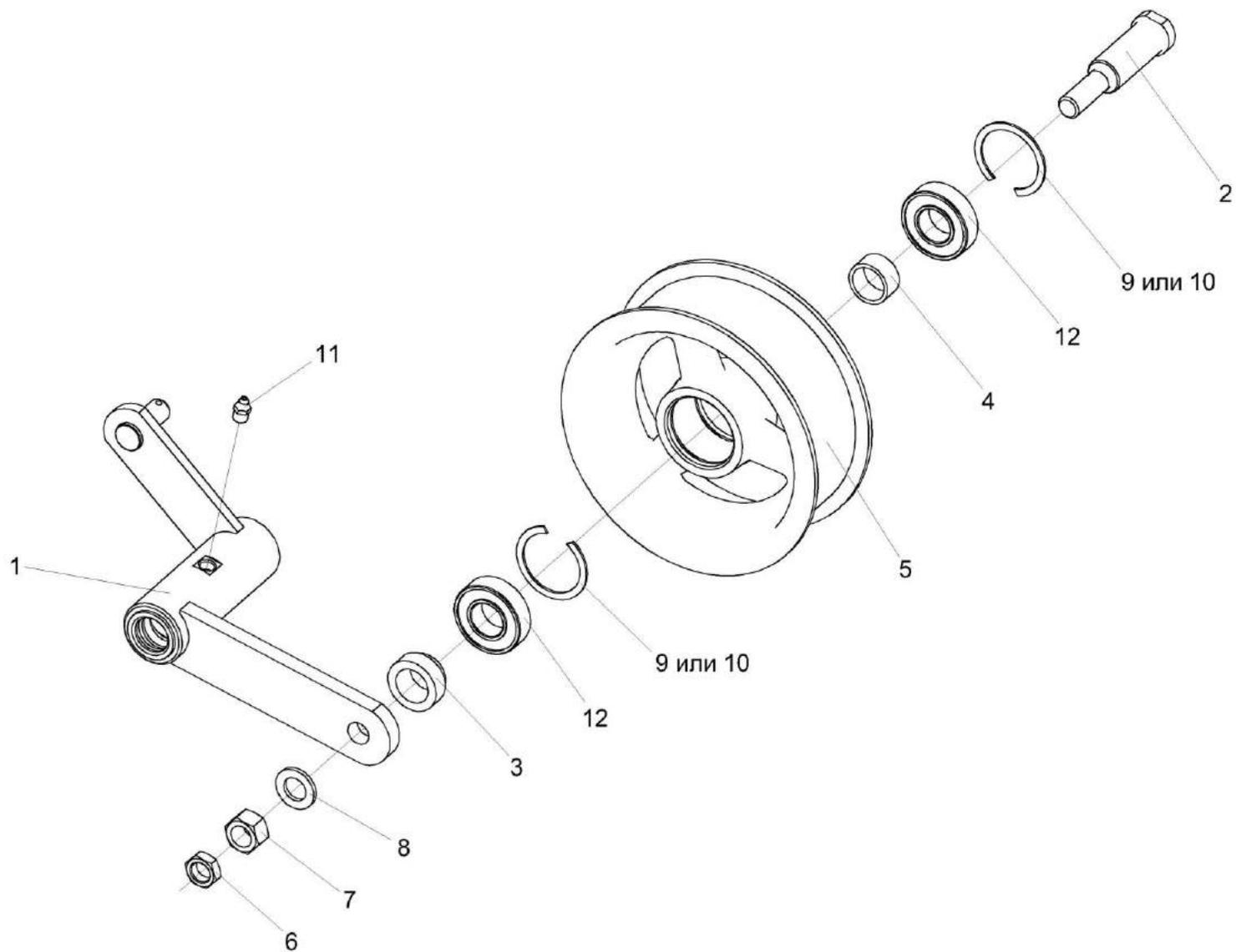
Рисунок 91 – Рычаг КЗК-14-0134010А
