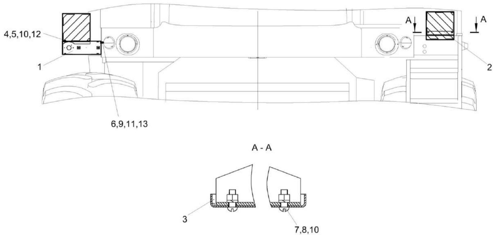
Рисунок 243 – Установка сигнальных полос КЗК-2124-0100020 (вид спереди)
