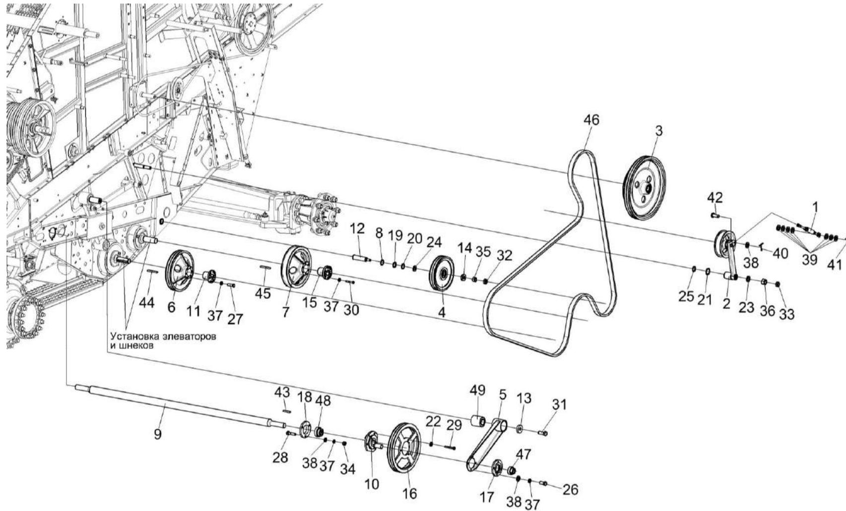
Рисунок 7 – Очистка. Установка шкива обводного КЗК-14-0202190
