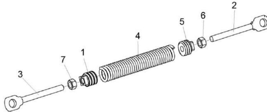
Рисунок 183 – Пружина КЗК-14-0290770А
