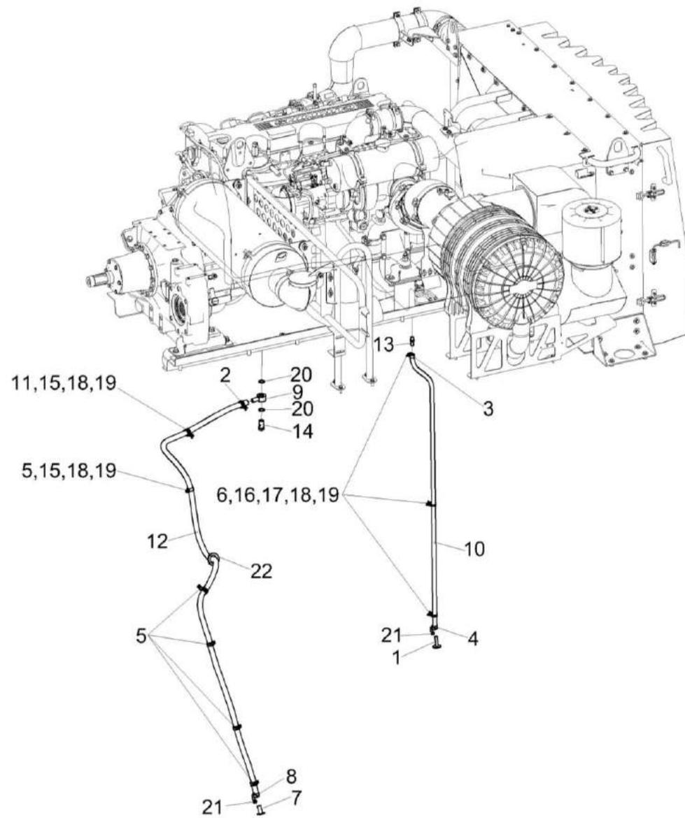
Рисунок 138 – Установка сливных рукавов КЗК-16-1-0106500
