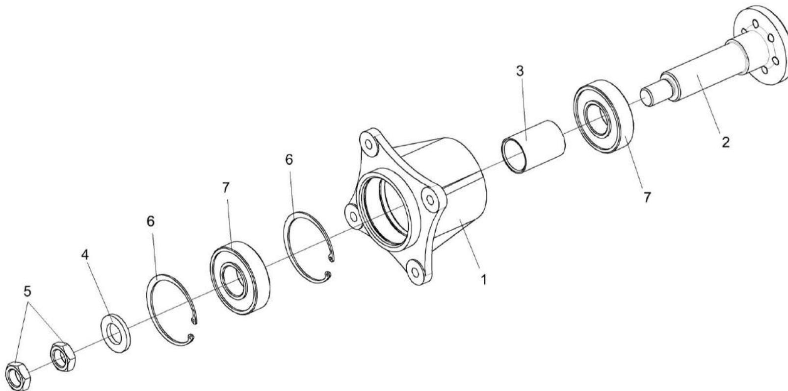
Рисунок 128 – Привод вентилятора КЗК 0106370А
