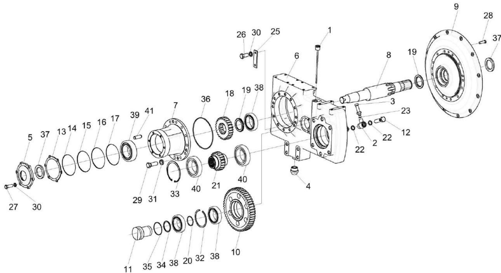
Рисунок 120 – Мультипликатор КЗК-13-0114000-03
