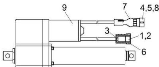
Рисунок 84 – Электромеханизм подбарабанья КЗК-1420-0701070
