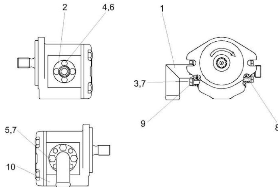
Рисунок 270 – Гидронасос шестеренный КЗК-1420-0602180
