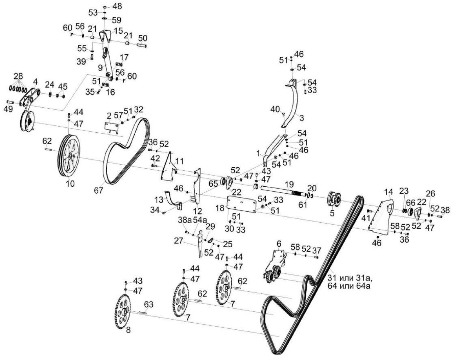
Рисунок 165 – Установка привода выгрузки КЗК-14-0221000А
