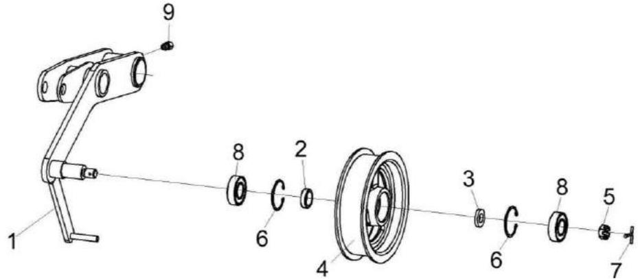
Рисунок 166– Устройство натяжное КЗК-14-0221100А
