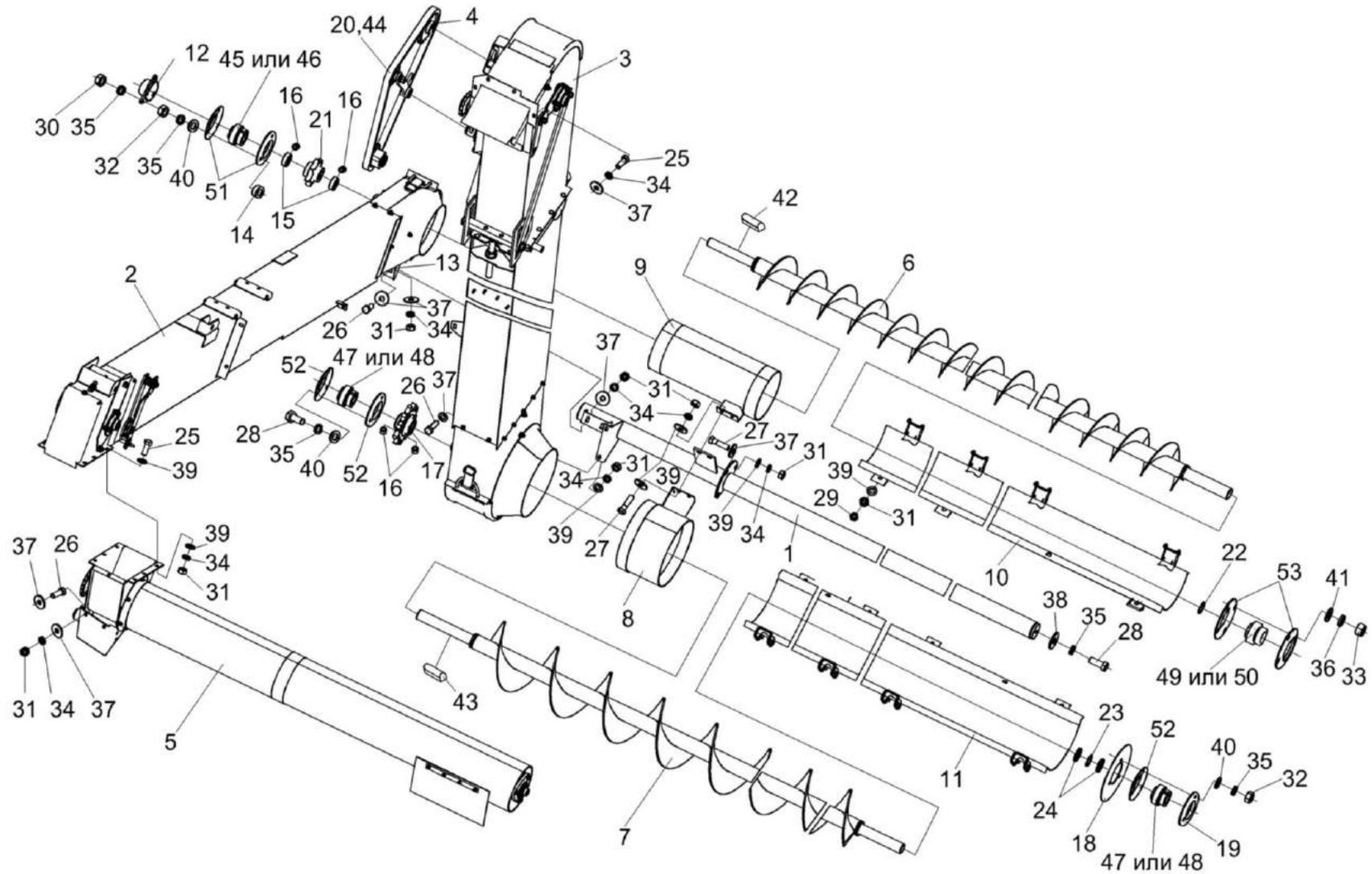
Рисунок 23 – Установка элеваторов и шнеков КЗК-2124-0207000
