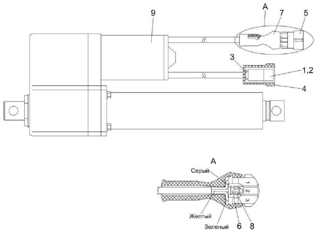
Рисунок 20 – Электромеханизм подбарабанья КЗК-10-0701400
