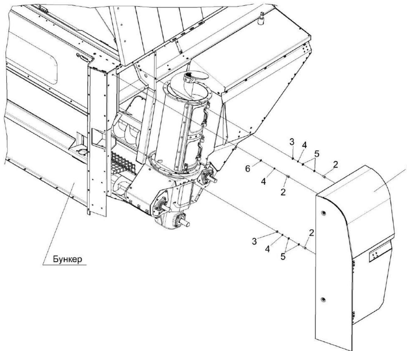
Рисунок 151 – Установка шкафа электрического КЗК-14-0116000
