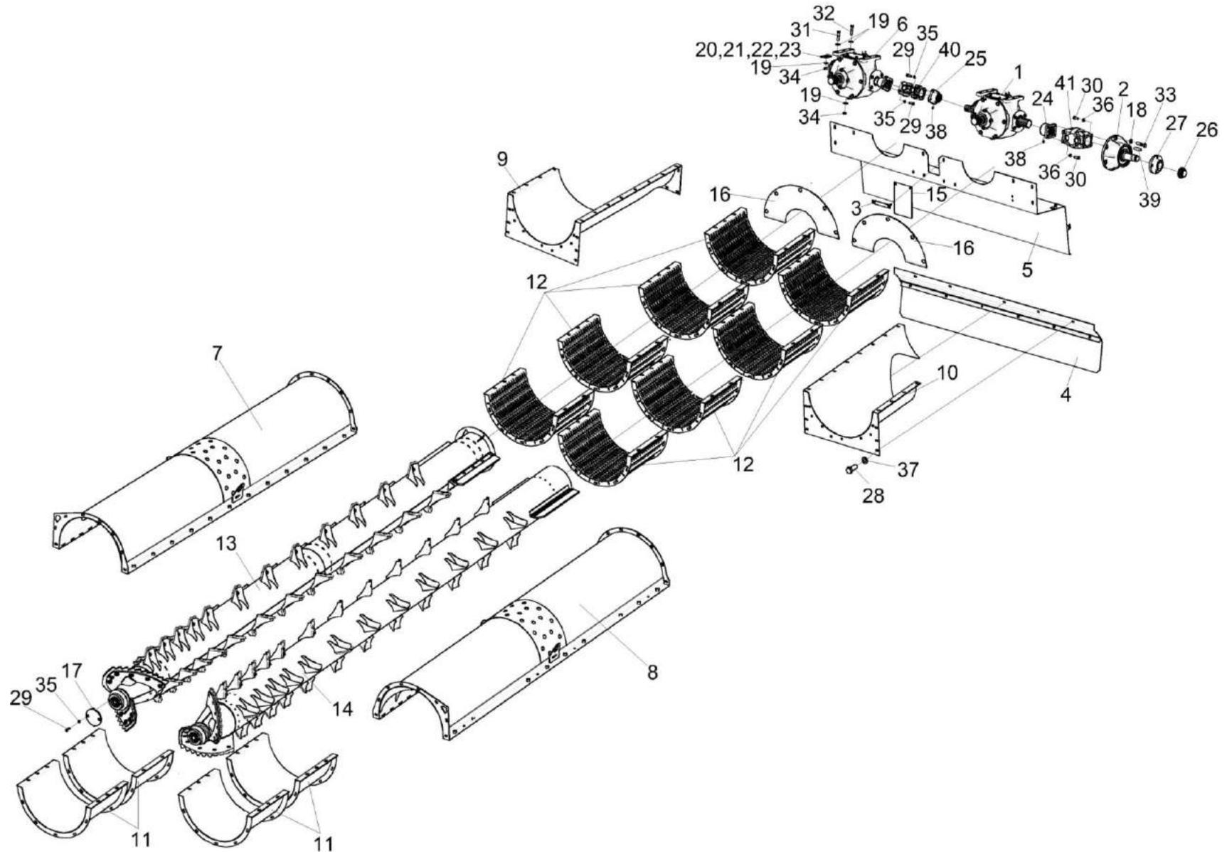
Рисунок 54 – Соломосепаратор роторный КЗК-16-1-0212010 (лист 2)
