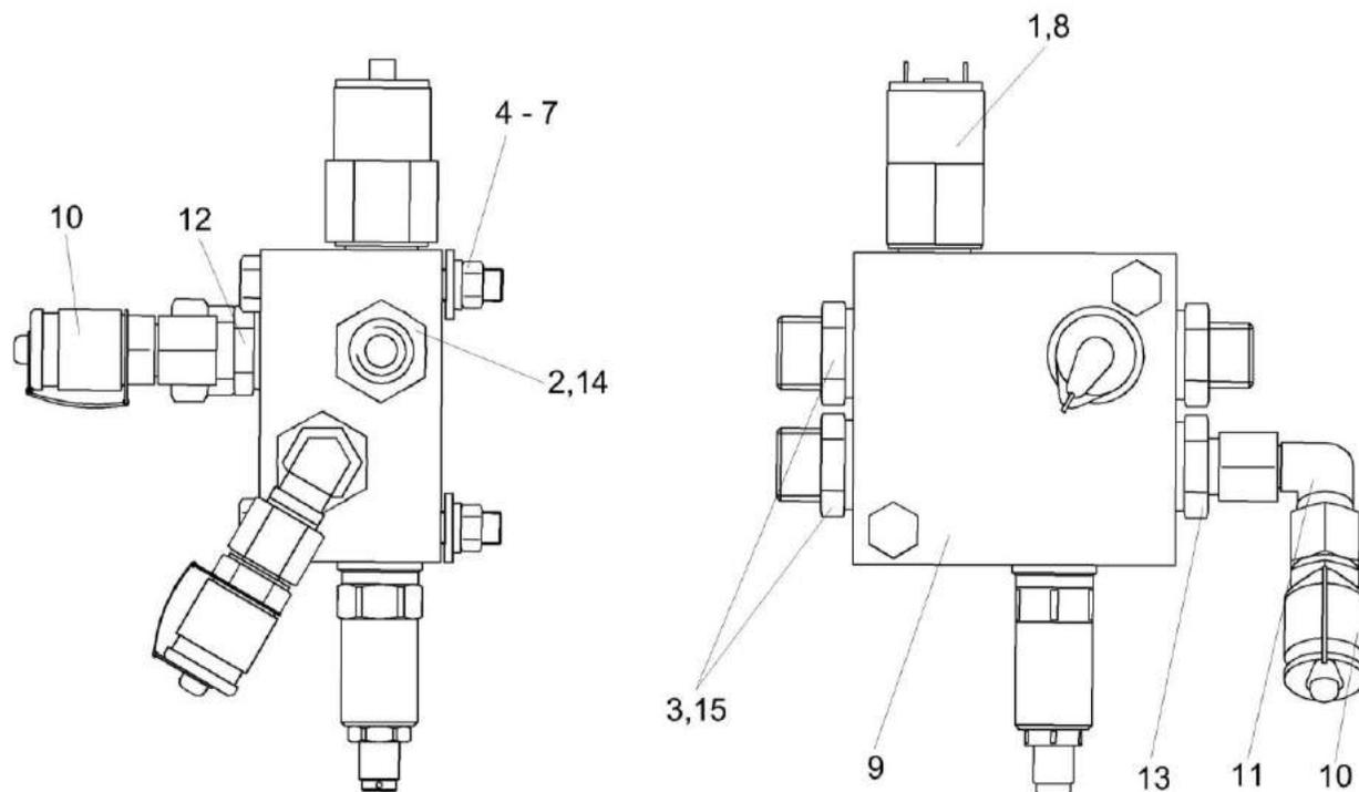
Рисунок 288 – Клапан низкого давления КЗК-16-1-0609320-01
