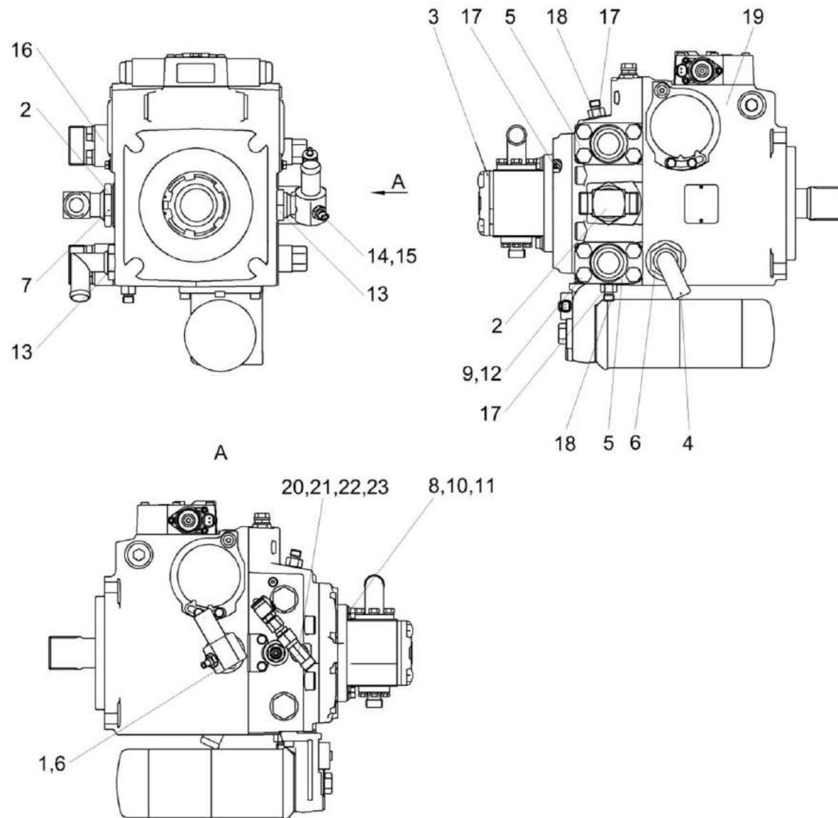
Рисунок 269 – Гидронасос двухсекционный КЗК-1420-0611100
