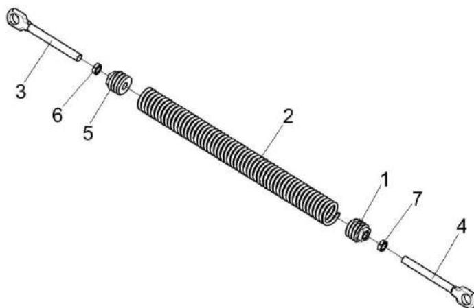
Рисунок 48 – Пружина КЗК-14-0220180
