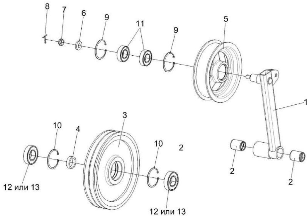
Рисунок 14 – Рычаг КЗК-1420-0202260 и шкив обводной КЗК-14-0202190
