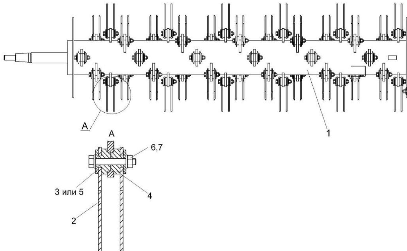
Рисунок 174 – Ротор измельчителя КЗК-16-1-0290140
