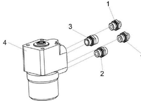
Рисунок 201 – Насос-дозатор КЗК-1420-0602110
