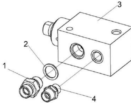
Рисунок 15 – Гидроцилиндр реверса наклонной камеры КЗК-1420-0679510
