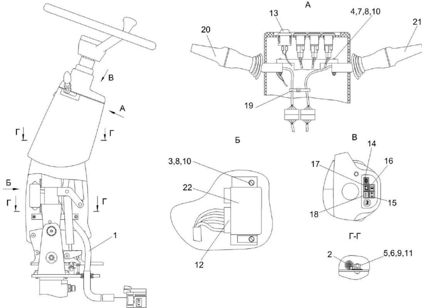
Рисунок 212 – Электромонтаж колонки рулевой КЗК-1420-0723000
