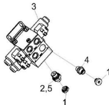
Рисунок 253 – Гидроблок управления переключением передач КЗК-1420-0601300
