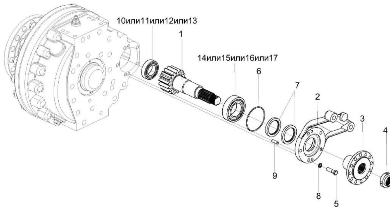
Рисунок 102 – Редукторы бортовые КЗК-14-0107020-01 (изображен) и КЗК-14-0107020 (зеркальное отражение) (лист 2)
