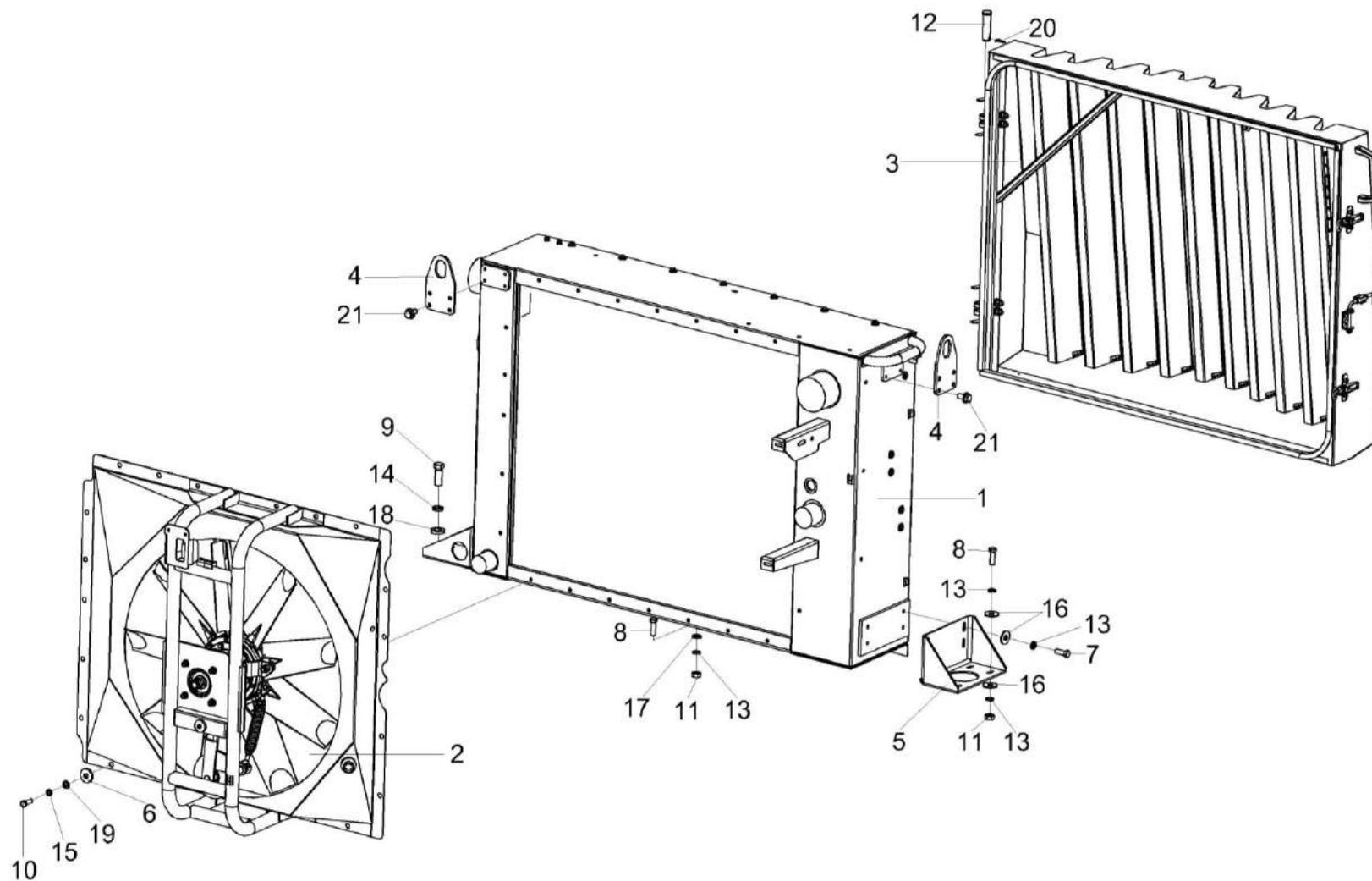
Рисунок 124 – Установка радиатора КЗК-16-6-0106040
