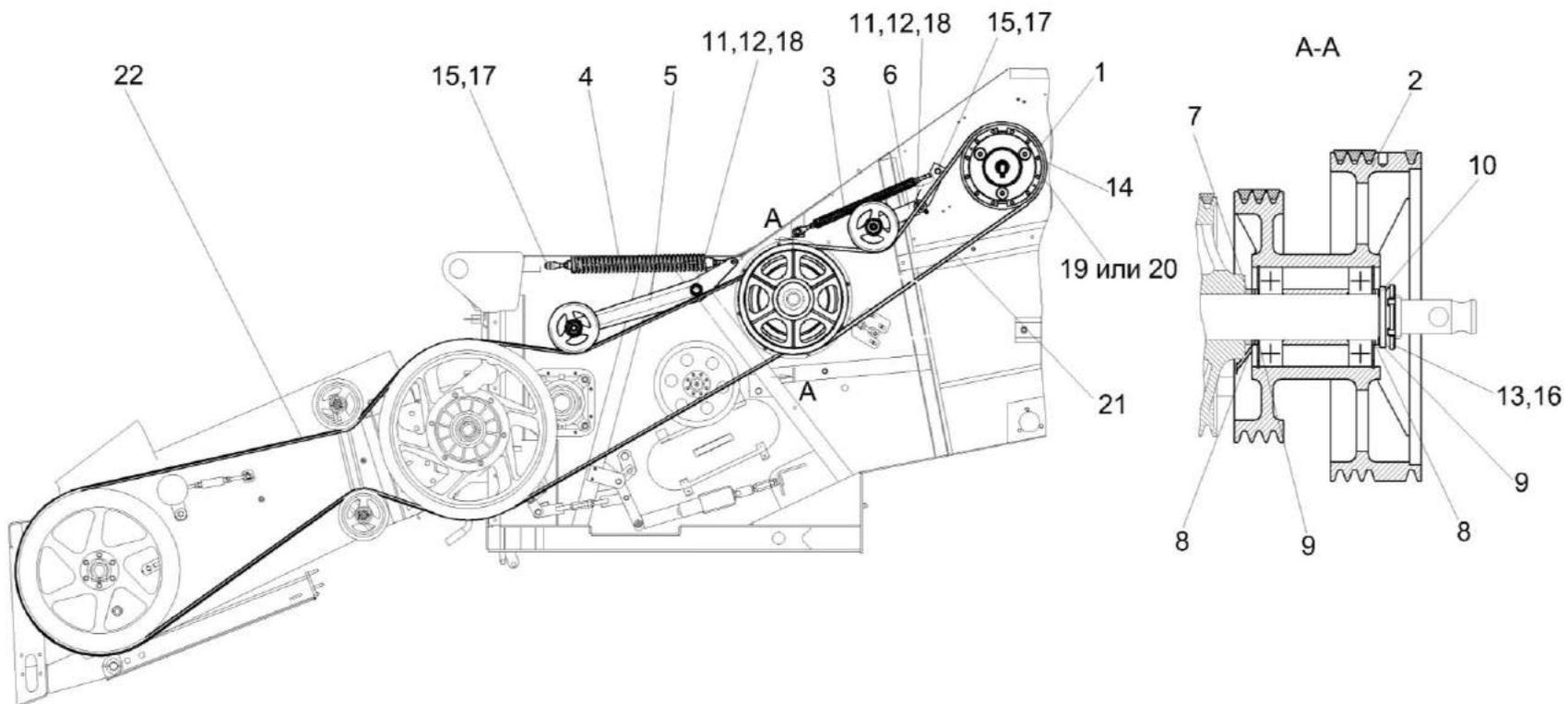
Рисунок 318 – Установка привода наклонной камеры КЗК-14-0125000Б
