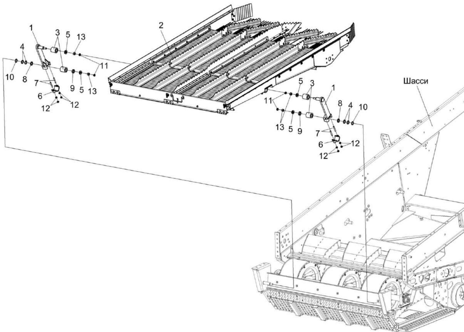
Рисунок 10 – Очистка. Установка доски стрясной КЗК-14-0280000
