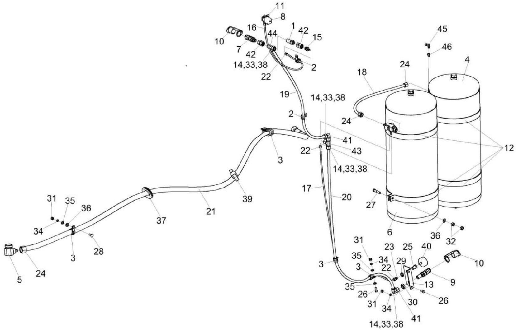
Рисунок 296 – Пневмосистема КЗС-1624-1 КЗК-16-6-0800000
