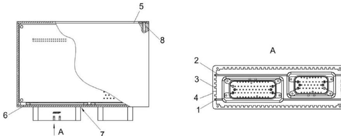
Рисунок 309 – Модуль трансмиссии КЗК-1420-0701200
