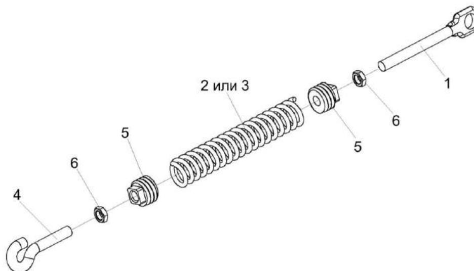
Рисунок 129 – Пружина КГС-1-0116750-01
