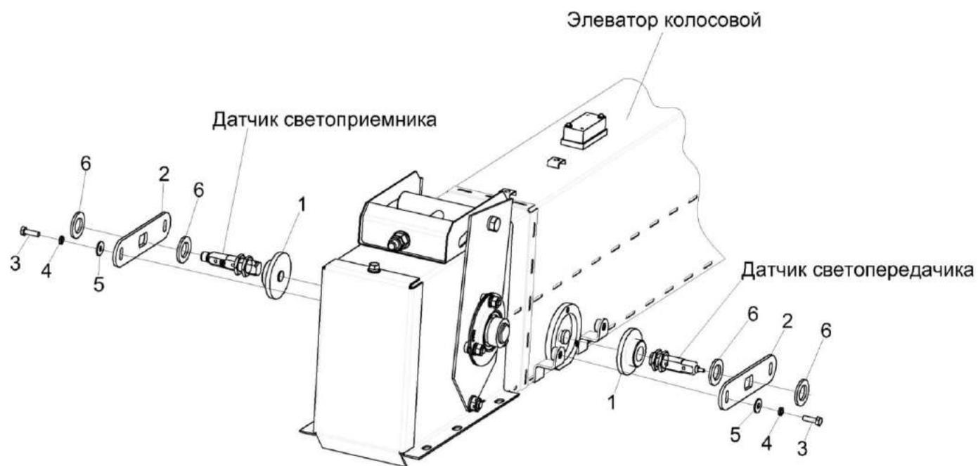
Рисунок 27 – Установка датчиков КЗК-14-0208250
