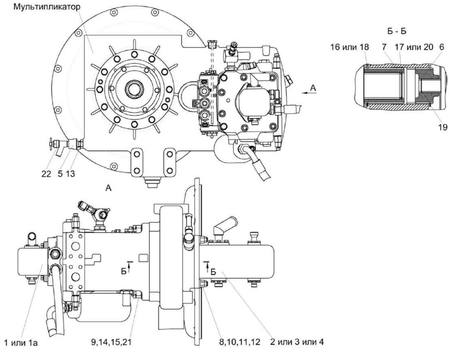
Рисунок 268 – Установка гидронасосов КЗК-16-1-0100200 и КЗК-16-1-0100200-01
