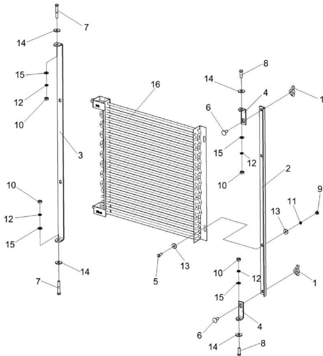
Рисунок 217 – Установка конденсатора КЗК-16-1-0113050
