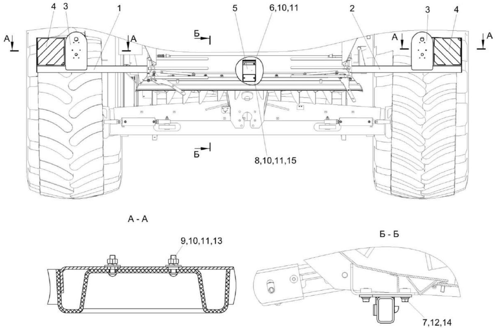
Рисунок 244 – Установка сигнальных полос КЗК-2124-0100020 (вид сзади)
