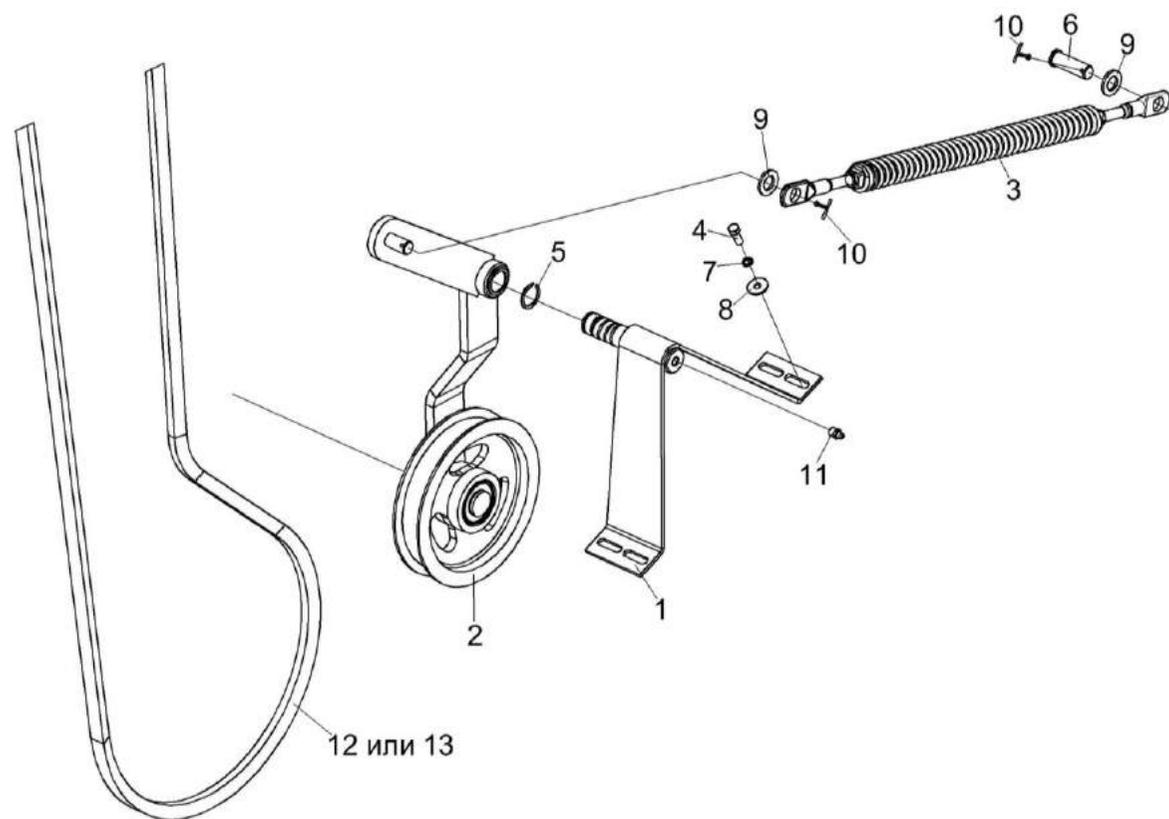
Рисунок 15 – Привод вариатора КЗК-14-0202400
