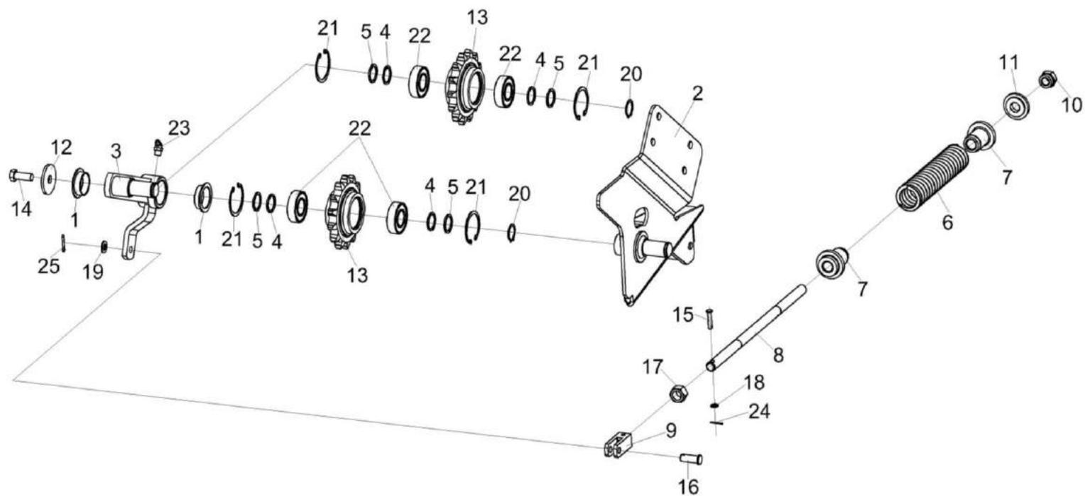
Рисунок 168 – Механизм натяжения КЗК-14-0221230А
