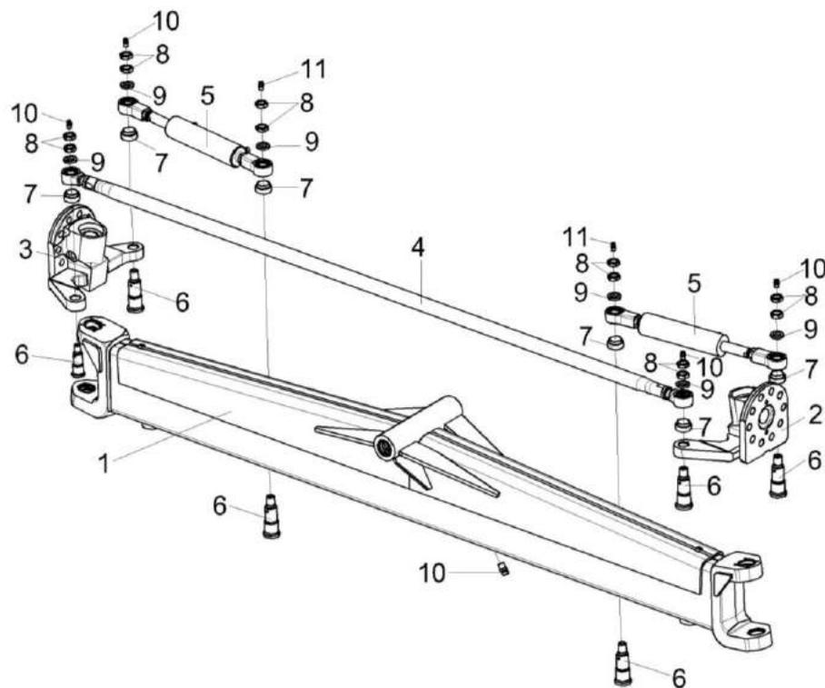
Рисунок 110 – Мост управляемых колес КЗК-1420-0109000 (лист 2)
